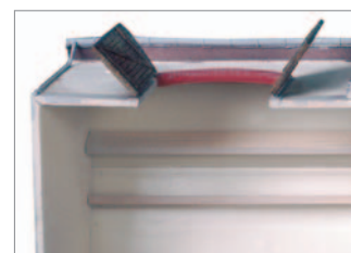
Versteifungen durch kleine Holzleisten sind zu empfehlen.
