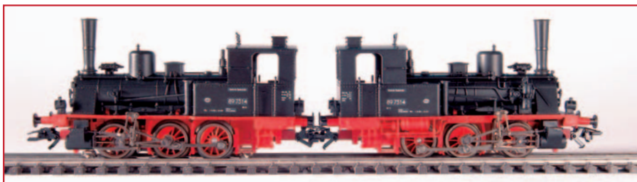
Äußerlich unterscheiden das Märklin- (links) und das Trix-Modell die Spurkranzhöhe der Räder und der, allerdings gut getarnte, Märklin-Schleifer.
