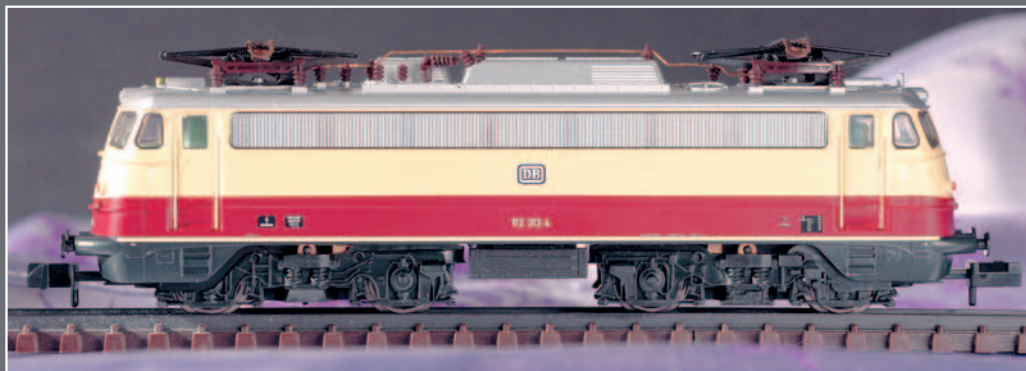
Die 112 weist vorbildgerecht geformte Drehgestell-Blenden auf, die sich von denen der E10.3 unterscheiden.
