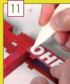
Für die Beschriftung eignen sich am besten Aufreißbögen, die man passend zurechtschneidet.
