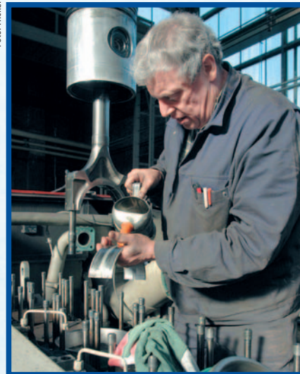
Hartmut Janocha bereitet im Celler Bw 13 den Kolbeneinbau bei 160073 vor. Hauptuntersuchungen führt die OHE selbst durch.
