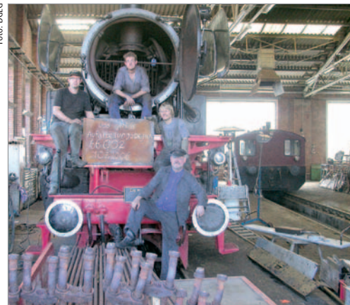
Mitarbeiter des DGE-Eisenbahnmuseums Bochum-Dahlhausen haben damit begonnen, den Kessel der 66 002 für die innere Untersuchung vorzubereiten.
