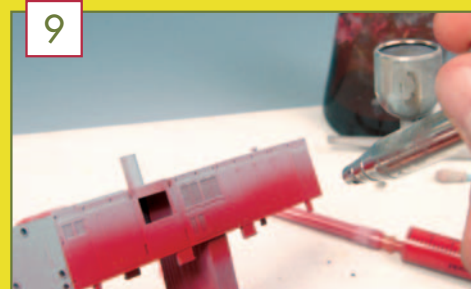
Mit der Spritzpistole wird der neue rote Lack in mehreren Schichten nacheinander aufgetragen.
