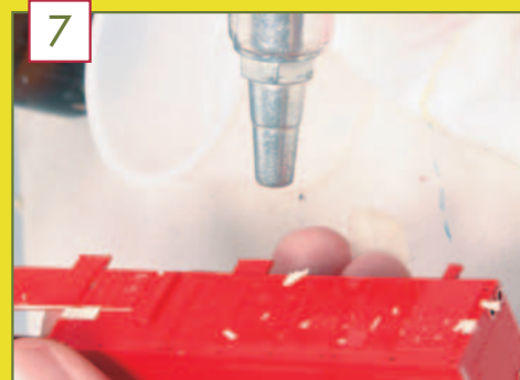
Die gelöste Beschriftung wird mit dem Reinigungs-Aufsatz einer Airbrushpistole weggeblasen.
