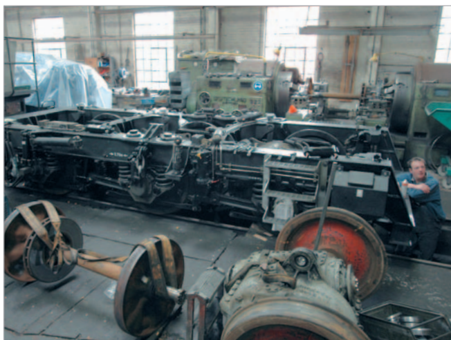
Das Drehgestell von Tiger 330092 wird im Eaw Bleckede instandgesetzt.
