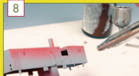
In gleichmäßigen Zügen wird die Grundierung aufgetragen.
