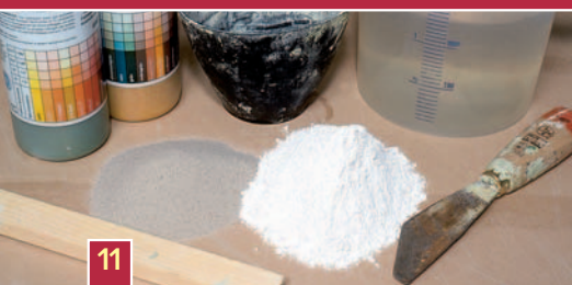
11 Aus Gips, Quarzsand, Dispersionsfarbe, Leim und Wasser besteht der gut formbare Überzug.
