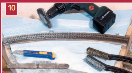
10 Bastelmesser und Drahtbürsten, auch als Bohreraufsatz, helfen beim Geländeformen.
