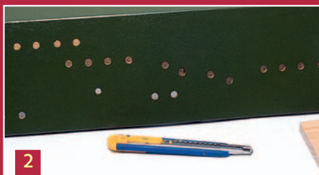
2 Nach dem Lackieren der Stellfläche erfolgt ein Überzug mit weißer Folie fürs Gleisplanschema.
