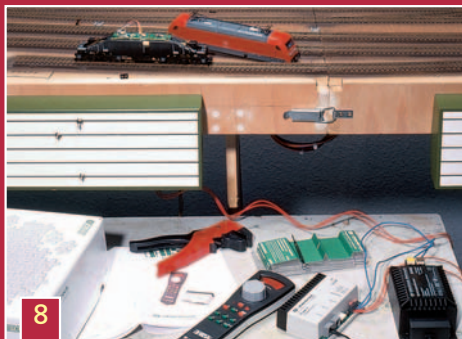
8 Der separate Stromzugang ermöglicht das flexible Anschließen einer Digitalsteuerung.
