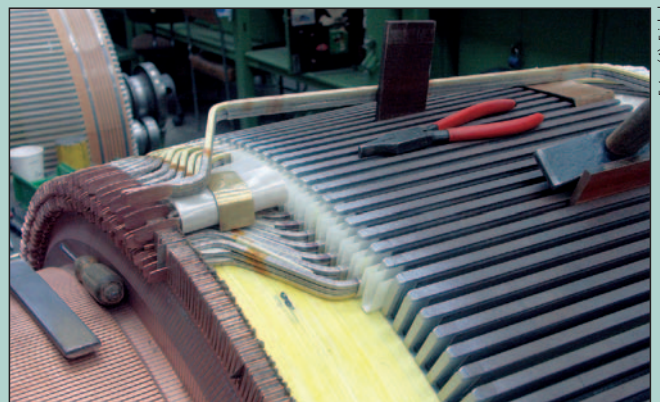
Die Neuwicklung der Fahrmotoren ist sogar in der heutigen Zeit noch reine Handarbeit für eigens ausgebildete Spezialisten.
