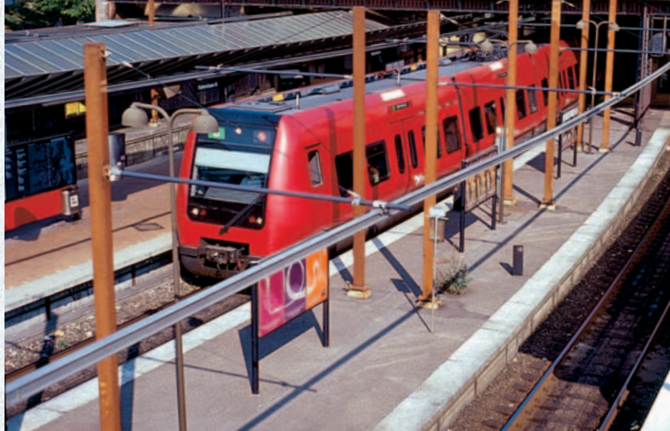
Auch im Kopenhagener Hauptbahnhof findet man bei den S-Bahn-Gleisen eine Stromschieneinfahrleitung. Besonders auffällig ist der im Vergleich zur gewöhnlichen Kettenfahrleitung kurze Mastabstand.
