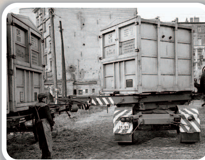
Auch der DR mangelte es an speziellen Zustellfahrzeugen wie diesem mit Ekrt-Versuchsbehälter 1959 in Berlin-Pankow.
