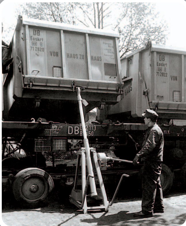
Behälter-Tragwagen mit Eoskrt: Die mobile, hydraulische Hebeeinrichtung erlaubte das Kippen und Entladen.
