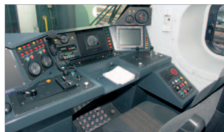
Der Arbeitsplatz der speziell ausgebildeten Lokführer im selbstfahrenden Mess-Triebwagen.
