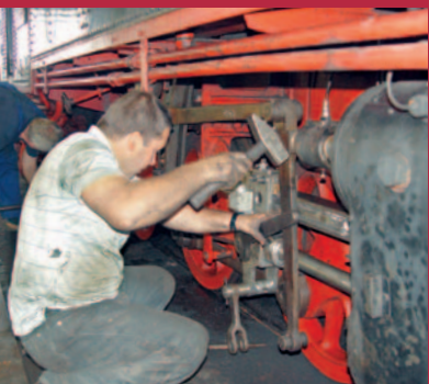
Fachleute aus dem rumänischen Klausenburg montieren die neuen Kolben und Kreuzköpfe.
