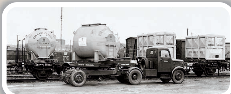
Heilbronn, 1. November 1953: Hier erfolgt gerade die direkte und damit effiziente Umladung eines pa-Behälters der Gattung Efkr.
