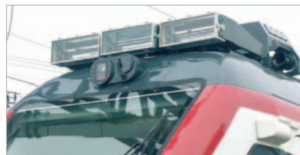
Auf dem Dach befinden sich drei Infrarotlampen und neben dem Spitzenlicht eine Kamera.
