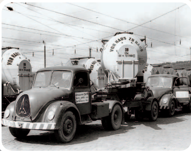
Koblenz in den 60er-Jahren: Die Magirus-Zugmaschine mit Ackermann-Spezialauflieger übernimmt einen Efrk.
