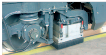
Das Gehäuse vor der Achse beherbergt Kameras für die Schienenprofil- und Riffelmessung.
