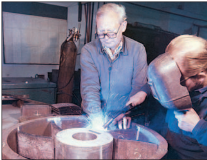
In Schweißtechnik entstanden bei Fachleuten die Laufräder für Lok und Tender.
