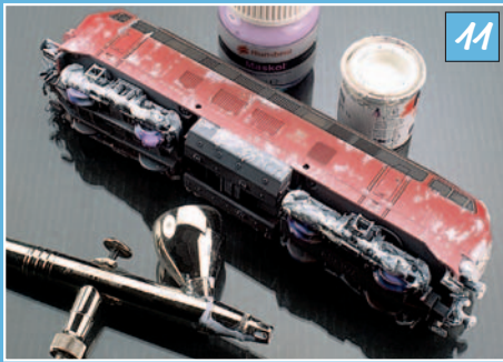
Während der Fahrt aufgewirbelter Schnee wird im unteren Bereich der Lok dezent mit der Spritzpistole aufgetragen. Die Räder werden mit Abdecklack geschützt.
