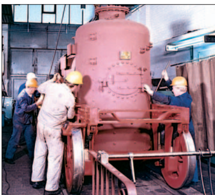
Ein wichtiger Moment im Spätsommer 1988: Der Kessel wird auf das Fahrwerk gesetzt.
