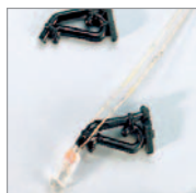
Durch den Anbau eines Mikrolämpchens wird aus der Lampenattrappe eine funktionierende Lichtquelle.
