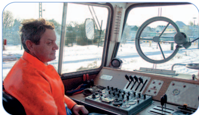
Der Arbeitsplatz des Schneepflugbedieners auf der linken Seite des Beilhack-Pfluges.
