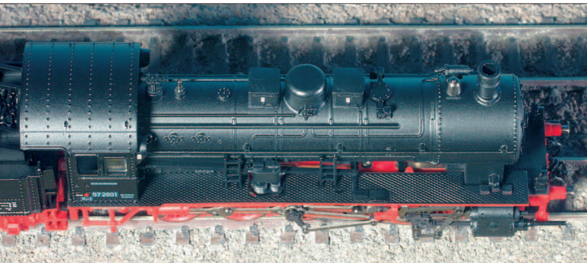
Die aus Kunststoff am Metall-Kessel angesetzten Dome lassen diverse Varianten erwarten.
