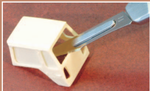
Die Häutchen in den Resin-Formteilen werden vorsichtig mittels eines Skalpells entfernt.
