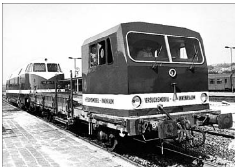
118261 schob den voll funktionsfähigen, auf einem Flachwagen montierten Versuchsführerstand.
