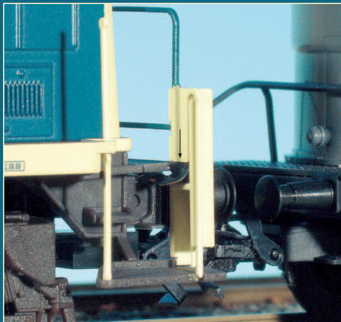
Sehr gut gelöst wurde die Verkabelung der Stirnbeleuchtung an den Rangiererbühnen. Das dünne Flachbandkabel (Pfeil) fällt kaum auf.
