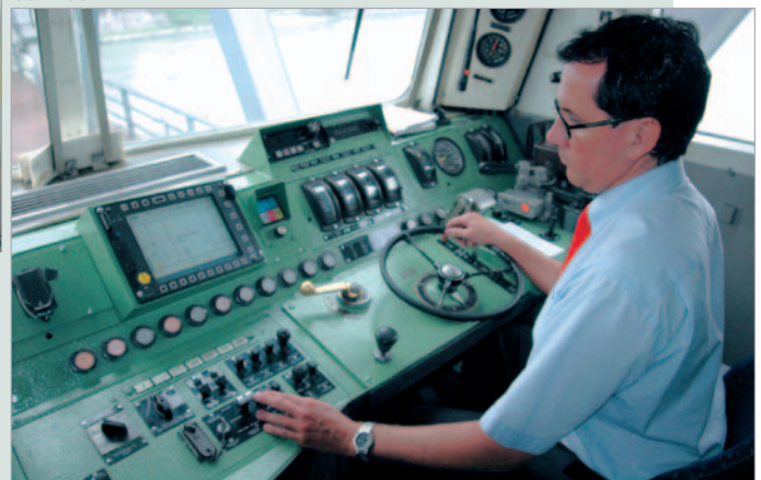
In Frankreich Vorschrift: Das Hassler-Zugsicherungs-Gerät.
