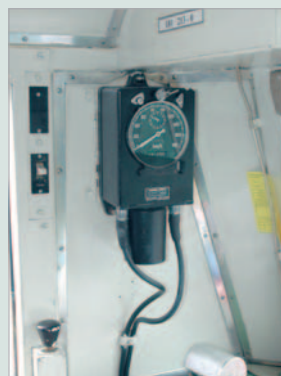
In Frankreich Vorschrift: Das Hassler-Zugsicherungs-Gerät.
