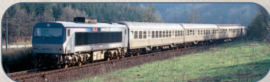
Die 202 003 nutzte eine MAN-Konstruktion, den V6V 23/23 TL (MTU: MA 12V 956 TB).
