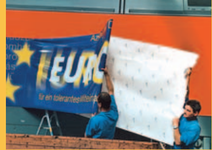
Präzisionsarbeit ist erforderlich, als die Folie von ihrer Trägerschicht abgezogen und die Seitenwand der Lok faltenfrei beklebt wird.
