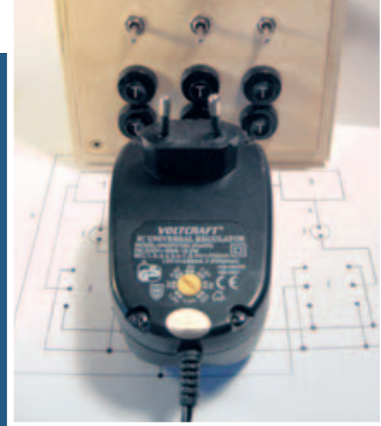
Der Universaltrafo ist regelbar von 1,5 bis 12 Volt. Die Getriebemotoren vertragen eine Maximalspannung von 6 Volt.
