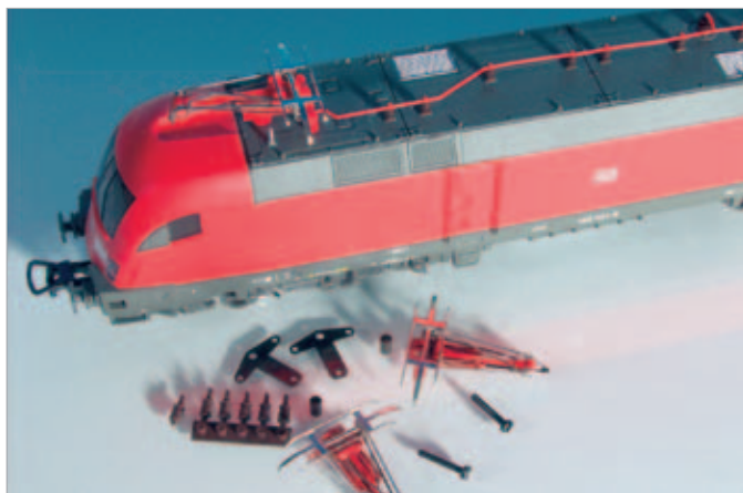
Wenige Teile sind zur Montage funktionsfähiger Stromabnehmer nötig.
