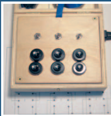
Mit den Drucktastern am Steuerpult werden die insgesamt drei Motore des Funktionskrans angesteuert.
