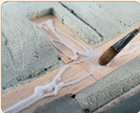
Damit der Gips auf dem Sperrholz hält, ist dieses satt mit Weißblei einzustreichen.
