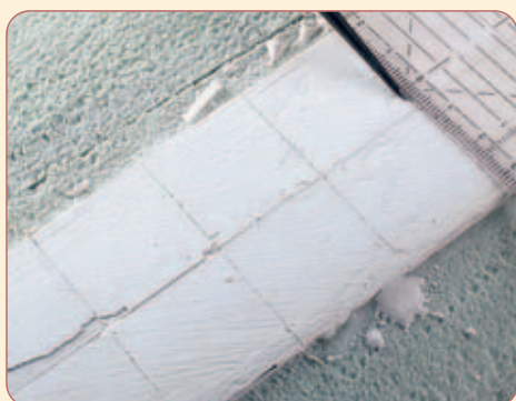
Mit einer am Geodreieck geführten Reißnadel werden die Fugen graviert.
