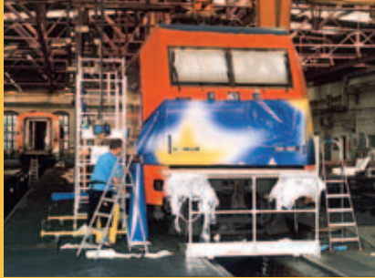
Der erste Frontstreifen ist angebracht. Die Dachschräge wurde wie Griffe, Steckdosen und Scheinwerfergehäuse blau lackiert.
