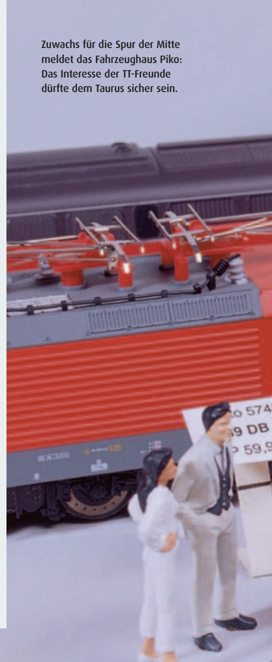
Das Design des Taurus hat Piko gut getroffen. Frontscheibe und Scheibenwischer sind ein Formteil.
