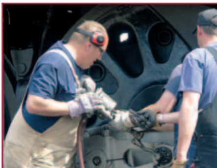
Zum Schmieren der Lager in Wishram verwenden die Männer die so genannte „Alemite Greasing Gun“, eine mit Druckluft betriebene Fettspritze.
