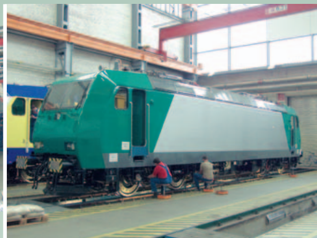
Letzte Arbeiten und Qualitätskontrollen finden an der weitestgehend fertiggestellten 185550 für „Rail4Chem“ statt.
