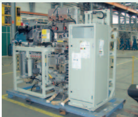
Komplett montierte Komponenten wie die Druckluftanlage werden zugeliefert (oben). Eine permanente Qualitätsüberwachung ist oberste Maxime in der Kasseler Endmontage.
