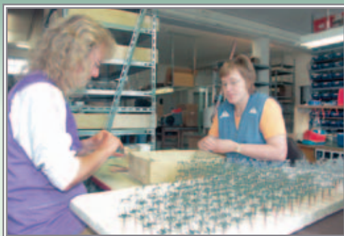
Die montierten Stromabnehmer werden zum Lackieren vorbereitet und auf Zahnstochern aufgespießt.
