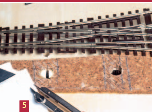
Mit Hilfe eines Zirkels fertigt man Abdeckungen für die Bohrlöcher der Stellstangen an.
