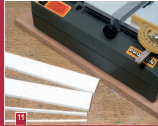
Eine Tischkreissäge leistet gute Dienste beim Anfertigen der Kunststoff-Kabelkanäle.
