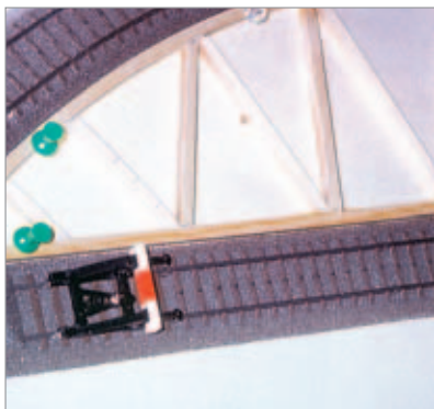
Zum Einkleben der Querstreben fixiert man die Außenleisten mit Stecknadeln.
