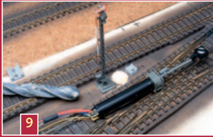
Fehlbohrungen beim Einbauen der Signale sind einfach mit einem Pfropfen zu schließen.
