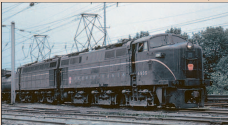
Die E3B (Achsfolge B'B'B') und E3C (Achsfolge C'C') von 1952 waren nur Probeloks.
