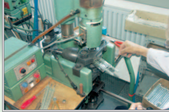
Mit einer speziellen Kunststoffspritzgussmaschine werden noch die fehlenden Sockel des Gittermastes angebracht.
