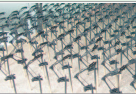
Hunderte von Stromabnehmern für eine französische H0-Lok haben das Lackbad hinter sich. Nach einer ausgiebigen Trocknung geht ihre Reise weiter.
