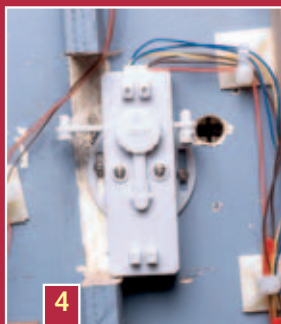
Mit Hilfe eines Zirkels fertigt man Abdeckungen für die Bohrlöcher der Stellstangen an.
