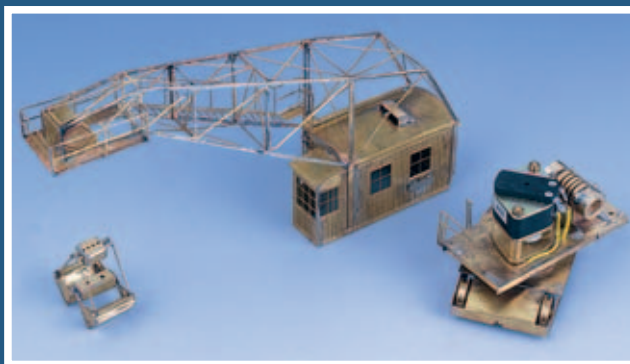
Blick ins Innenleben des Kranhauses: Hinter dem Motor für die Schwenkbewegungen sitzt die Seiltrommel für die Schaufel.
