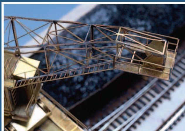
Der Ausleger: Beim Löten der filigranen Gitterkonstruktion ist genaues und nicht allzu hitziges Arbeiten unerlässlich.
