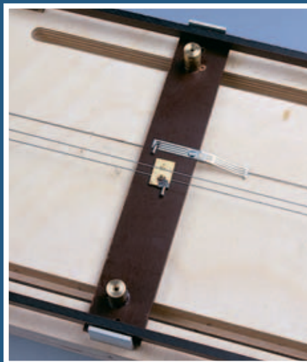
Der so genannte Schlitten, der aus Pertinax bestehende, mit Winkelblechen in der Führung gesicherte Stab, ist mit dem Kran verbunden und nimmt Strom ab.
