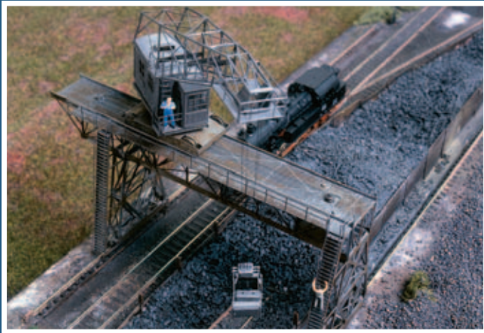
Nicht nur der Portalkran bewegt sich. Auch das Kranhaus auf der Brücke ist dank Getriebemotor, Trommel und Seilzug mobil.
