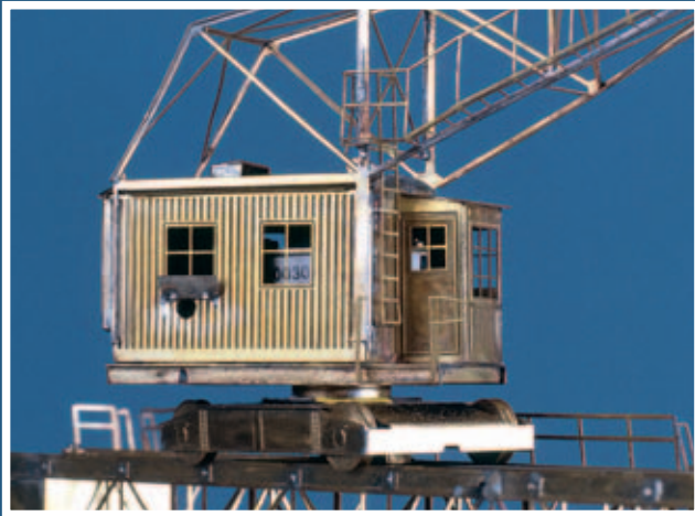
Unter dem linken Fenster ist die Aussparung zu erkennen, durch die man per Schraubendreher die Kranschaulseilzüge bewegt.
