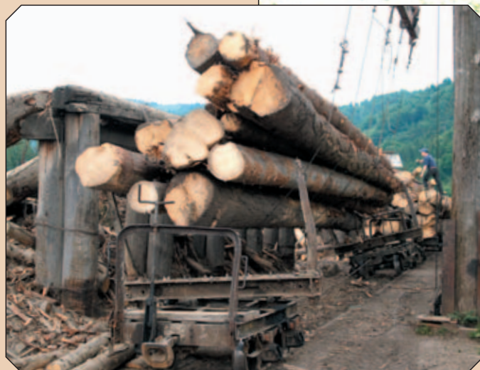
Die Waldbahn hat nicht ausgedient: Über Seilzüge werden die Stämme im Sägewerk Viseu von den Trucks geholt.
