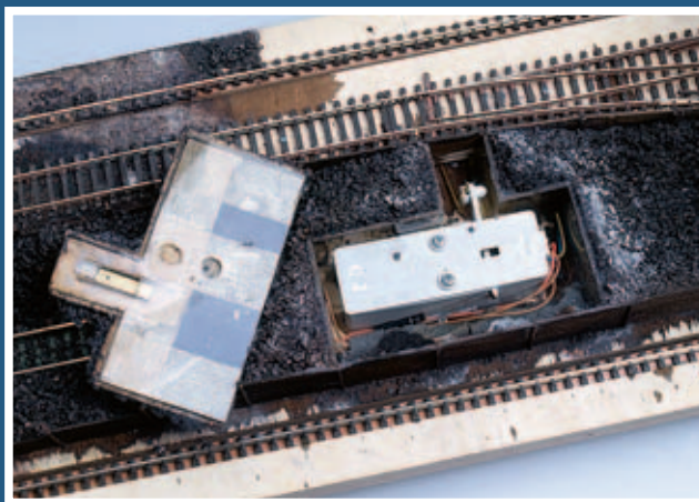
Bei Bedarf eignet sich der Kohlenbansen ganz hervorragend für das unauffällige Unterbringen eines Weichenantriebs.
