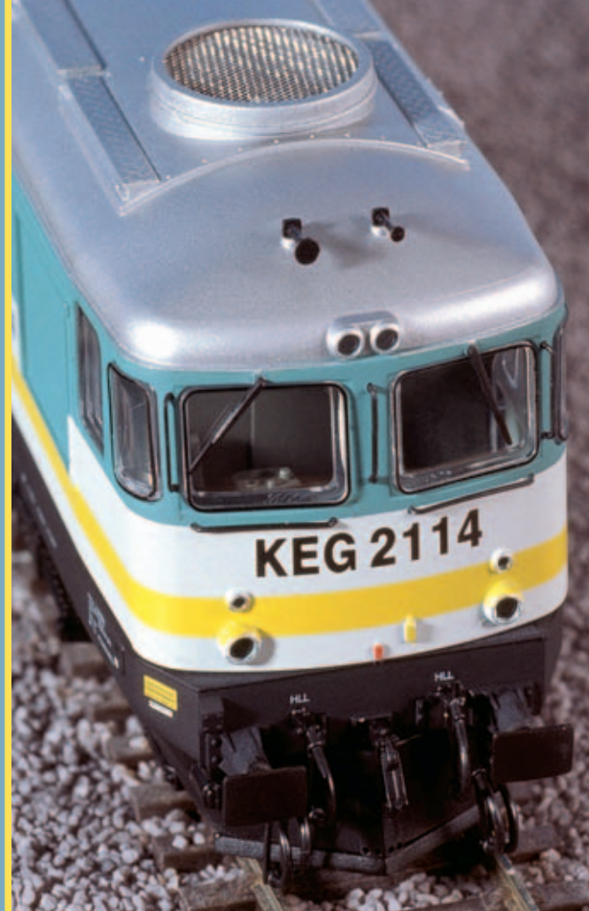
Typhone, Griffstangen und Scheibenwischer sind separat angesetzt. Die Führerstände weisen eine Inneneinrichtung auf.
