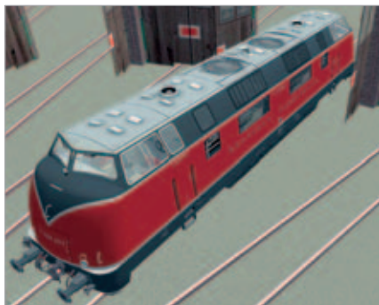
Dach, die 3.: Die Vorserie V200003 hat zwei markante Lüfterräder auf dem Dach.
