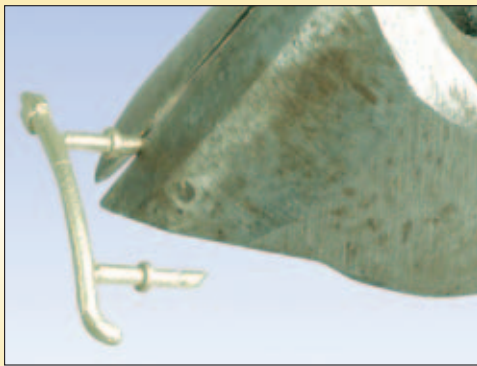
An den Feigussteilen sind Markierungen in Form von Einkerbungen angebracht, die das Abtrennen auf die jeweils richtigen Längen erleichtern.
