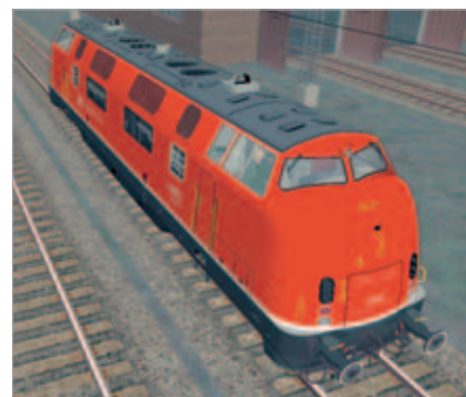
Dach, die 2.: Einige V200 gingen als Am4/4 zur SBB und wurden auf dem Dach geändert.
