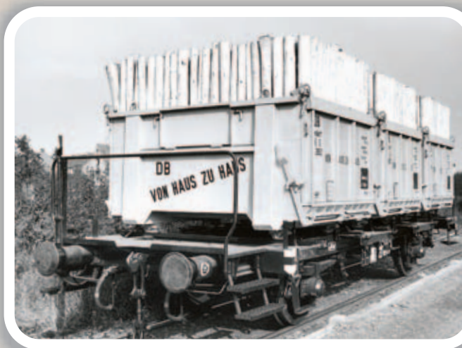
Die offenen Großbehälter Eoskrt, vornehmlich für Stapelgut, verfügen zwecks flotten Entladens über Seitenwandklappen.
