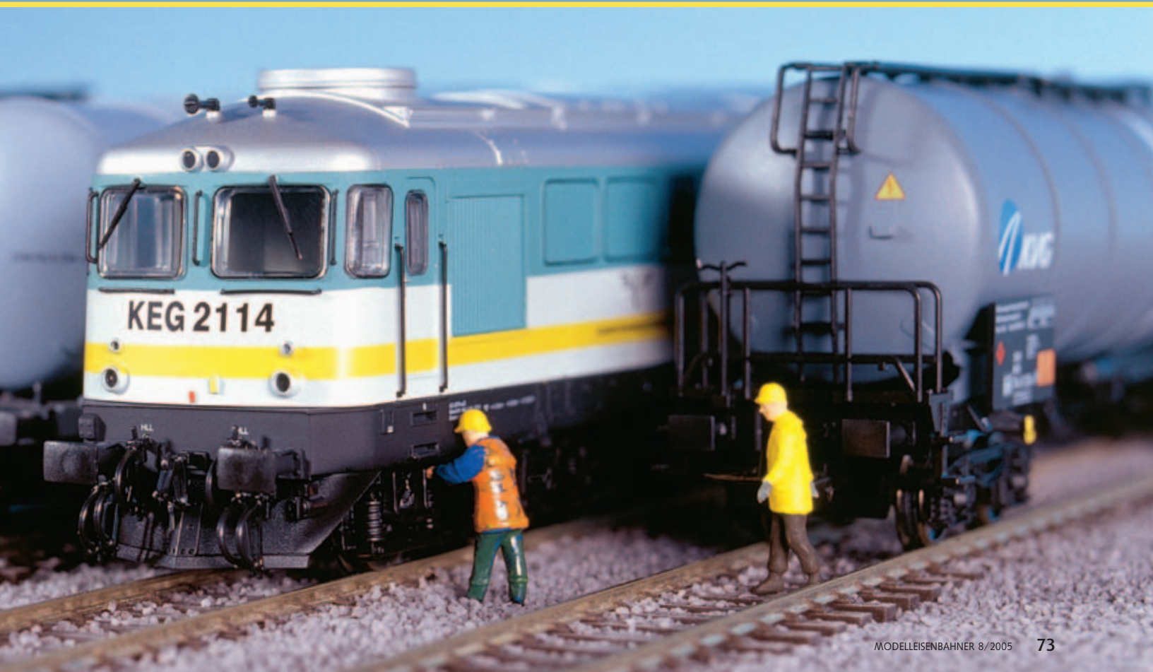
Typhone, Griffstangen und Scheibenwischer sind separat angesetzt. Die Führerstände weisen eine Inneneinrichtung auf.
