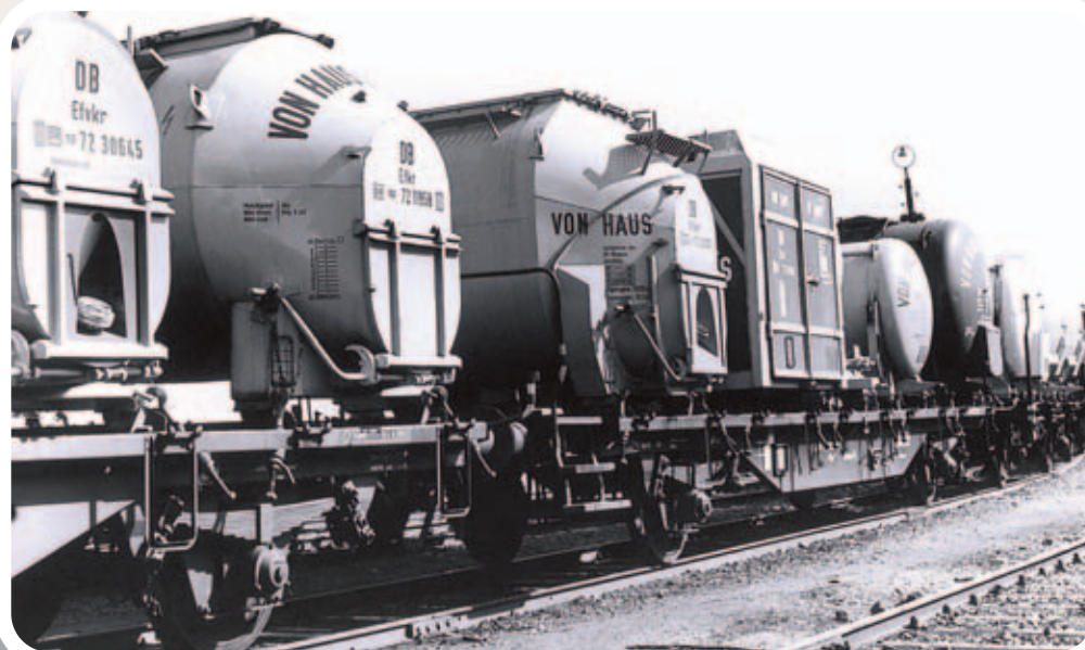
Nicht das einzige Plus des Systems: Die Kombination verschiedener Behälter auf einem Tragwagen.
