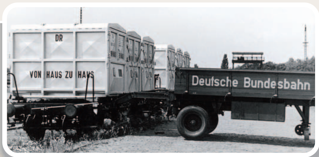
Zur Übernahme eines Großbehälters für die Zementbeförderung steht das Sattelfahrzeug bereit.
