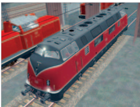
Dachausrüstung, die 1.: Die Serienmaschine V200080 zeigt im Bw Koblenz vier Lüfterräder.
