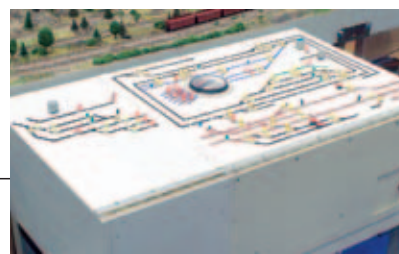
Das Gleisbildstellpult: Bis zu zehn Züge können gleichzeitig fahren, dank Blockstreckensteuerung ohne manuellen Eingriff.
