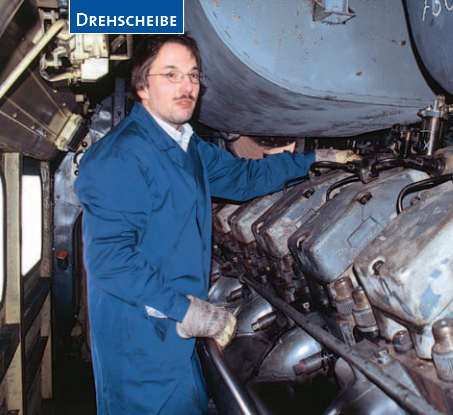
Druck aufs Einspritzpumpengestänge, von dem die Kommandos zum Regler übertragen werden, auszuüben, kann nicht schaden.
