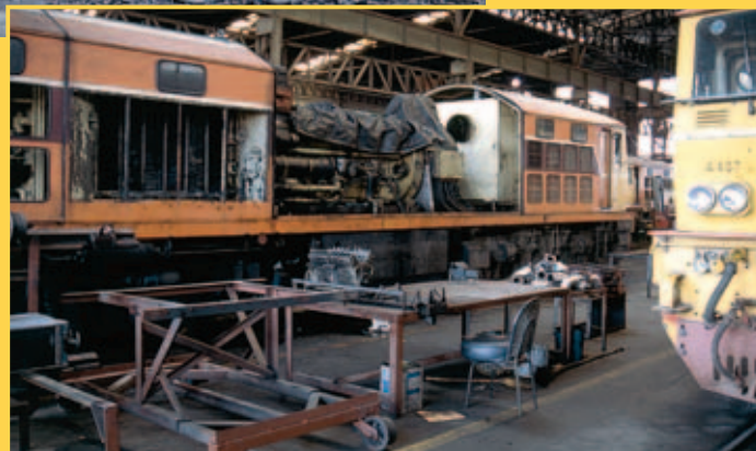
Das Bangkoker Bw ist zugleich Ausbesserungswerk: Bis diese Diesellok der Baureihe 43 wieder einsatzfähig ist, dürfte freilich noch Zeit vergehen.
