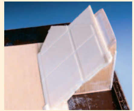
Die fertige Schleifvorrichtung für den exakten 45-Grad-Schliff.
