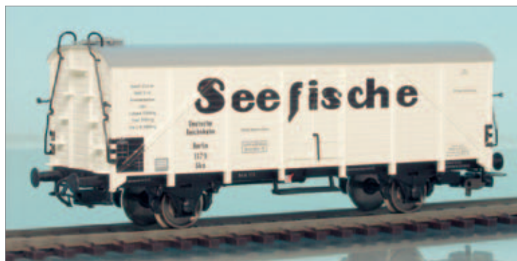
In den Epochen II und III stellte der als Gkn in Dienst gestellte Zweiachser einen wichtigen Kühlwagentyp dar.
