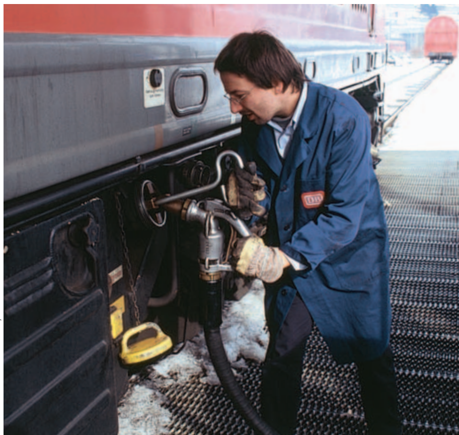
Volltanken bitte: 6000 Liter fasst der Tank, aber befüllt werden bei der DB AG nur 5400 Liter, damit in Kurven kein Kraftstoff überschwappt.
