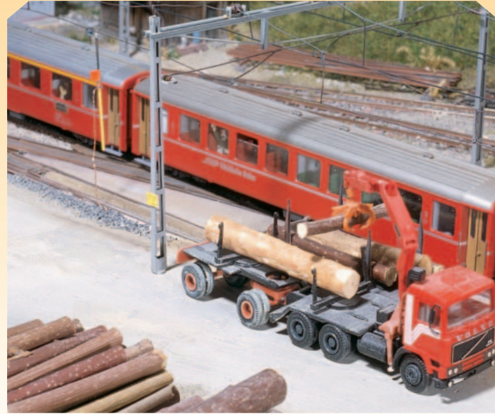
Holz spielt eine wichtige Rolle beim RhB-Güterverkehr. Zur Verladung muss die Oberleitung geerdet sein.
