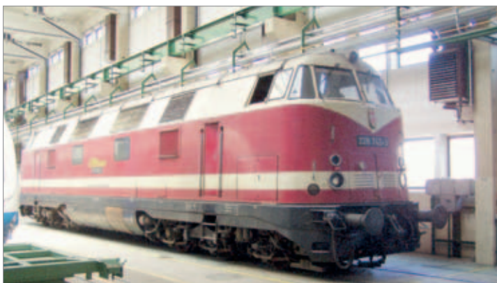
Bis auf die DB-Nummer und die dezente Anschrift des neuen Eigentümers EBM Cargo zeigt 228742 beinahe das Erscheinungsbild der Deutschen Reichsbahn in der DDR. Deren CC'-V180 wurden mehrfach neu motorisiert.
