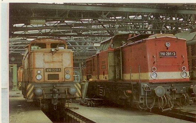
5 Vor dem Ringlokschuppen des Bw Leipzig Hbf Süd im Jahre 1981: zwei Erprobungsfahrzeuge mit Dieselmotoren der Bauform IV (siehe auch „me“ 12/86, S. 4 bis 7)
