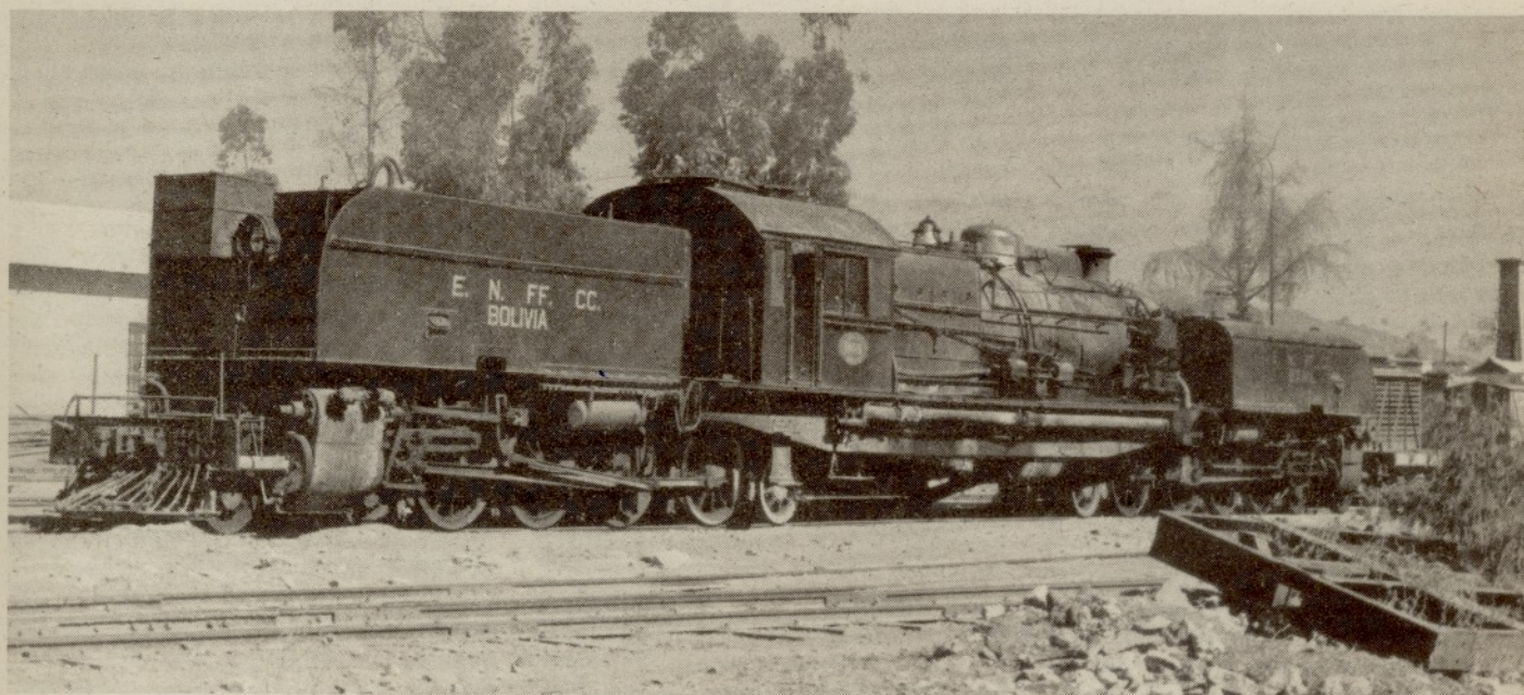
Eine meterspurige Garrattlok in Bolivien. Deutlich ist zu sehen, daß der Brückenrahmen auf das Ende des Drehgestells mit der kompletten Dampfmaschine und dem Vorratsbehälter gelagert ist.
