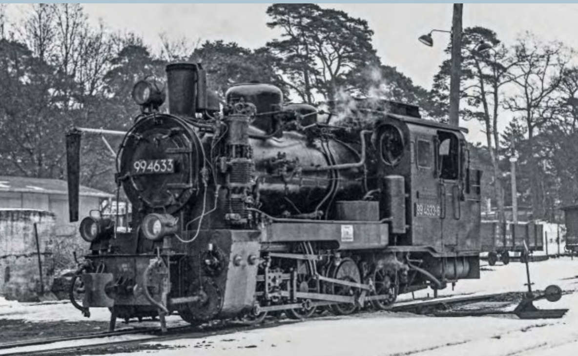
In klassischer „Fotografierpose“ steht die 99 4633 im März 1978 im Endbahnhof Göhren. Der Stettiner Vulcan hatte die Lok 1925 als Heißdampf-type Mh mit der Bahnnummer 53 geliefert
