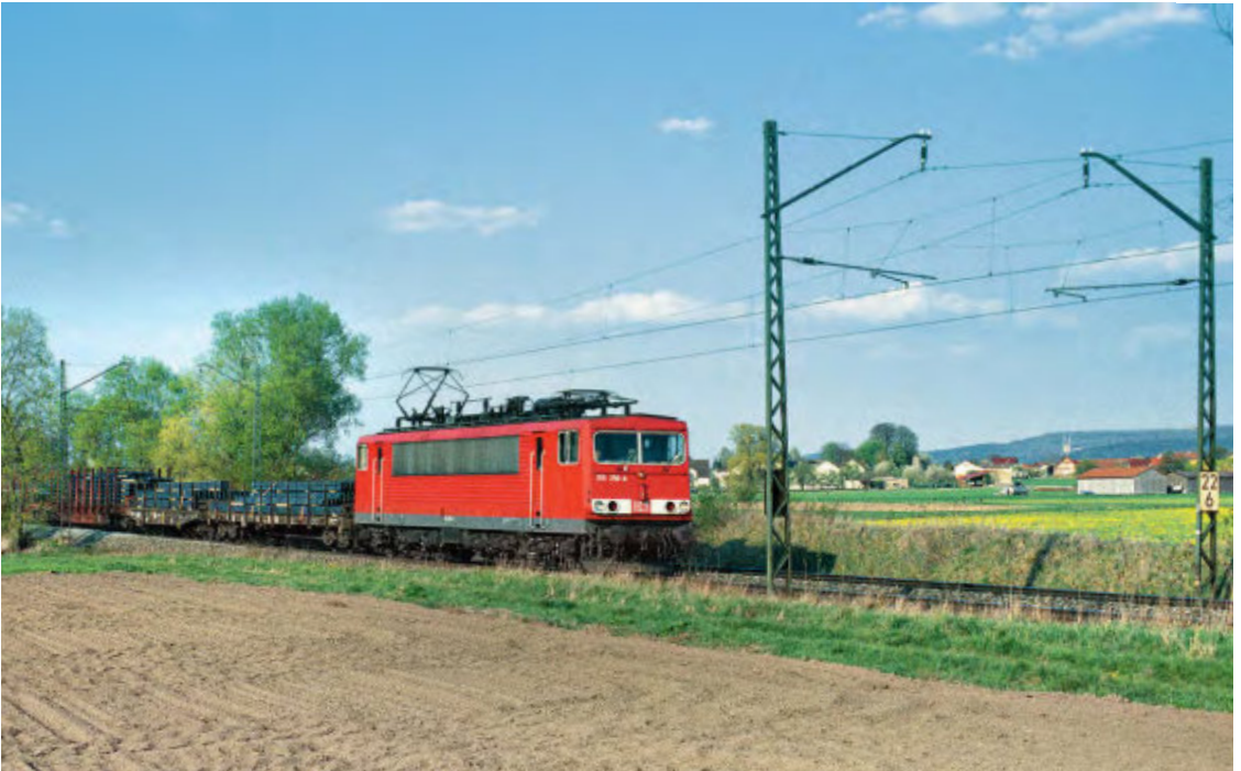
Im Jahr 2003 fährt eine 155 bei Ebensfeld unter einer von der Reichsbahn errichteten Fahrleitung. Diese Version mit den markanten Auslegern war typisch für das elektrische Netz Süddeutschlands Peter Schricker
