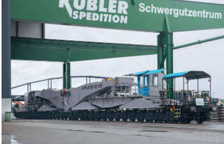
Die Kübler Heavy Rail GmbH hat für Amprion einen Tragschnabelwagen für Lasten bis zu 500 Tonnen gebaut
