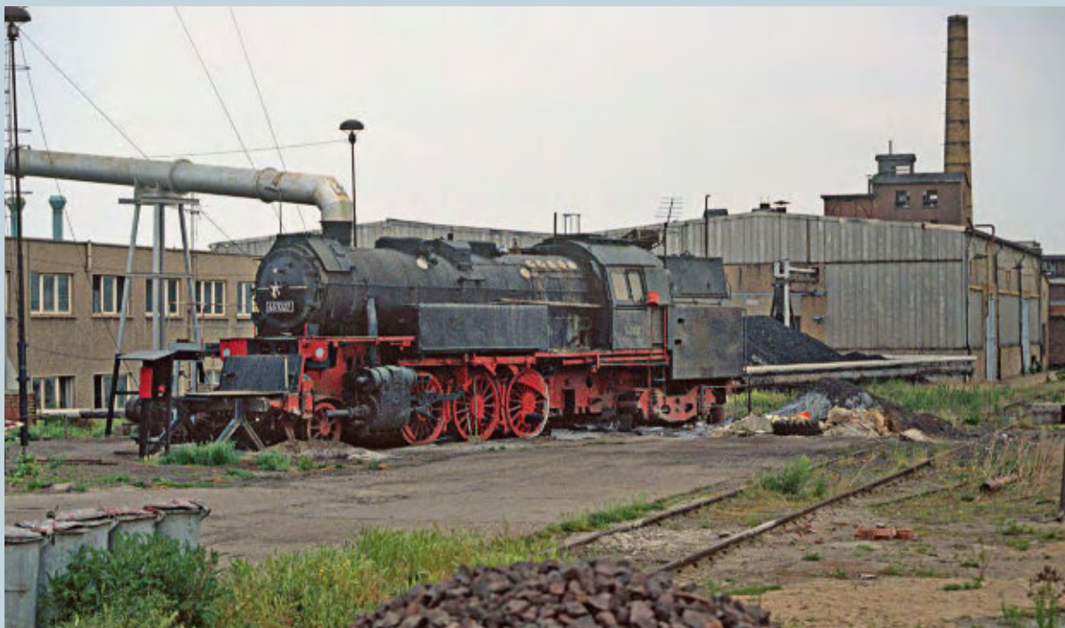
Sämtlicher Triebwerksteile und einer Treibachse beraubt diente 65 1070 ab 1974 in Staßfurt als Heizlok. Die Antenne auf dem Führerhausdach erlaubte ungestörten Fernsehempfang im Inneren
