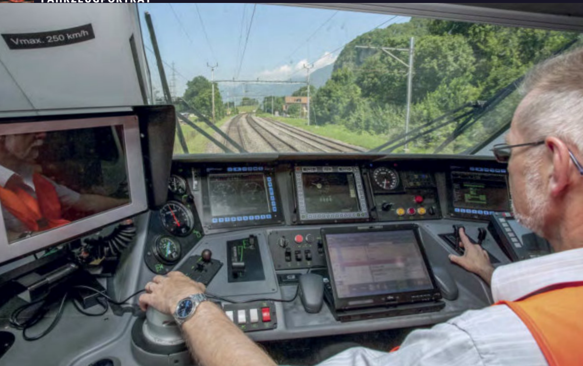
Blick über die Schulter des Lokomotivführers im Führerstand eines ETR 610. Mit der rechten Hand – genauer: dem Zeigefinger – bedient er den Joystick der Geschwindigkeitssteuerung
