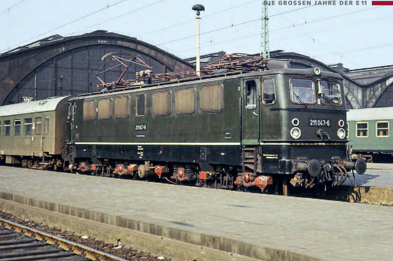
Die Loks der zweiten Bauserie ab der E 11 043 besaßen je sechs Lüftungsgitter an den Seitenwänden. Das Foto der 211 047 entstand am 25. Mai 1975 im Leipziger Hauptbahnhof
