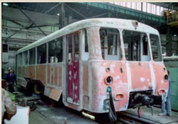
7. Juli 1993: Der LVT 771 004 erhält noch eine HU, das Rekonstruktionsprogramm für die Baureihe wird erst ein Jahr später umgesetzt Norbert Schmitz
