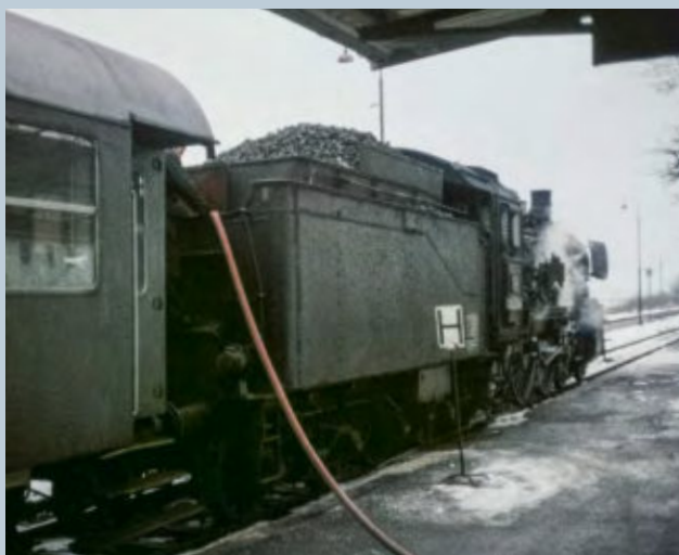
Mit einem Schlauch versucht das Personal, wenigstens etwas Wasser aufzufüllen
