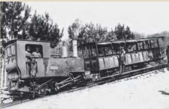
Das Foto von der Seite zeigt gut den einfachen B-Kuppler mit Riggenbach-Zahnradantrieb
