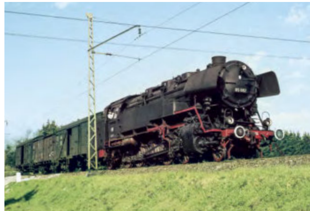
Die leistungsfähige Baureihe 85 machte ab 1932 den Zahnradbetrieb überflüssig. 85 002 dampft am 21. Mai 1959 bei Hinterzarten dahin Dr. Rolf Brüning
