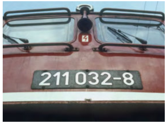
Frontpartie der E 11 mit dem Signalhorn zwischen den beiden Fenstern
