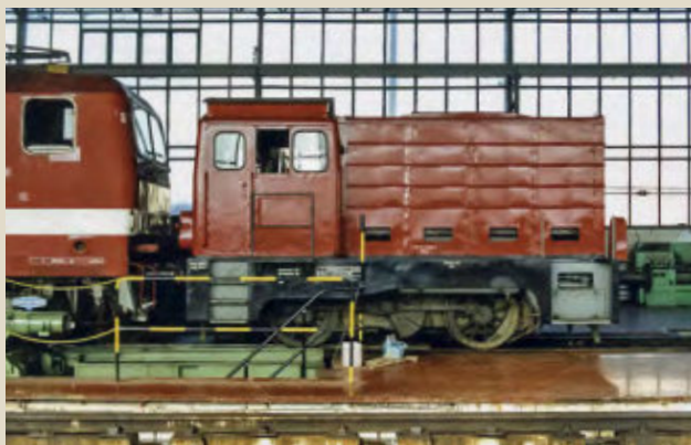
Die ex 102 053 wurde 1984 in Halle zum ASF 2 umgebaut. Nach einer Zeit im Raw Karl-Marx-Stadt kam es in das Bw Engelsdorf und fuhr noch bis 1996 an der Unterflurdrehbank Matthias Nieke
