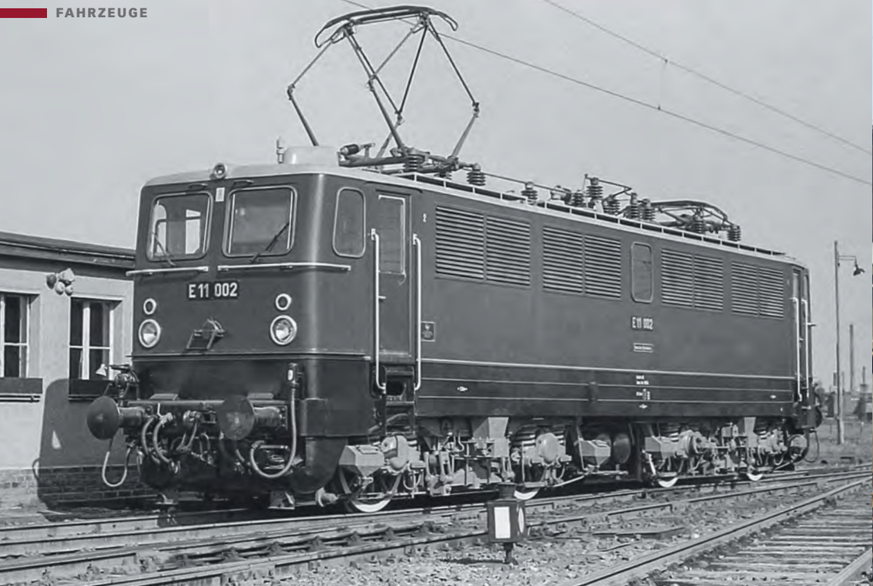
Hellgraues Dach, dunkelgrüner Lokkasten, schwarzer Rahmen und rotes Fahrwerk: E 11 002 in Dessau im Jahr 1961. Die Lüftergitter liegen noch waagerecht bei E 11 001 und 002
