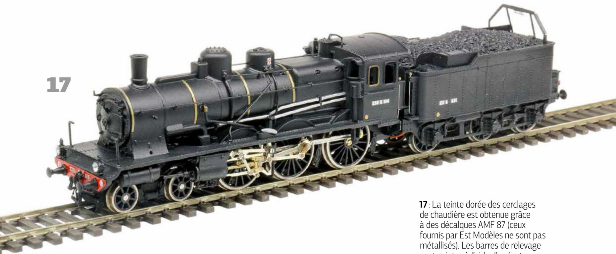
**17:** La teinte dorée des cerclages de chaudière est obtenue grâce à des décalques AMF 87 (ceux fournis par Est Modèles ne sont pas métallisés). Les barres de relevage sont peintes à l'aide d'un feutre couleur argent, l'entourage des baies de l'abri en doré à l'aide d'un feutre également. La mise en place des mains montoires sur l'abri et le tender est relativement complexe.
