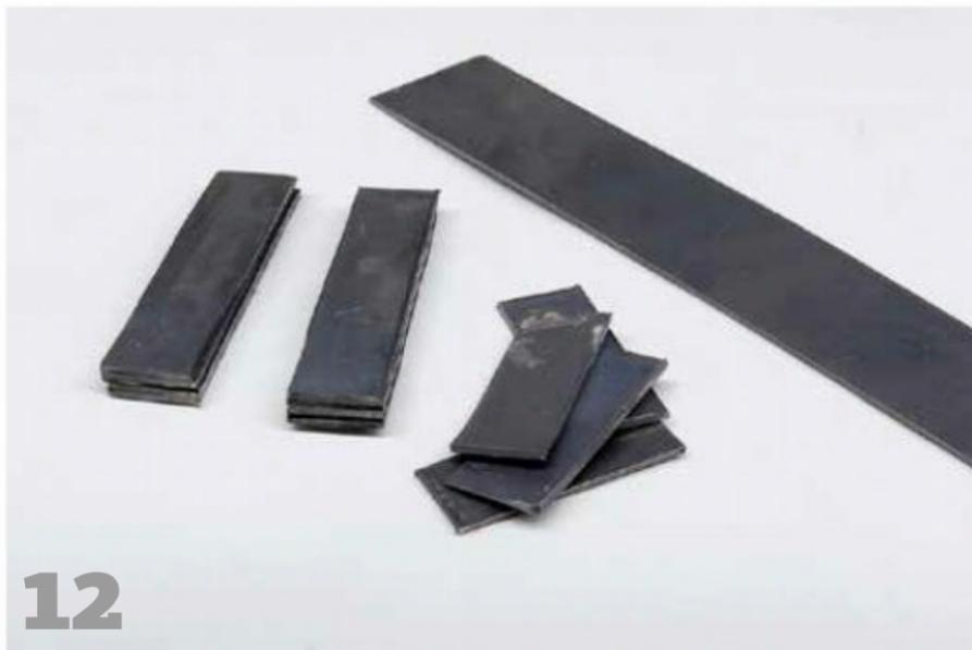
**12:** Une feuille de plomb est à découper pour lester la machine et le tender. S'il est possible d'utiliser un cutter, le plus simple et le plus rapide est d'employer une simple paire de ciseaux! Le lestage est indispensable, les superstructures en impression 3D étant très légères.
