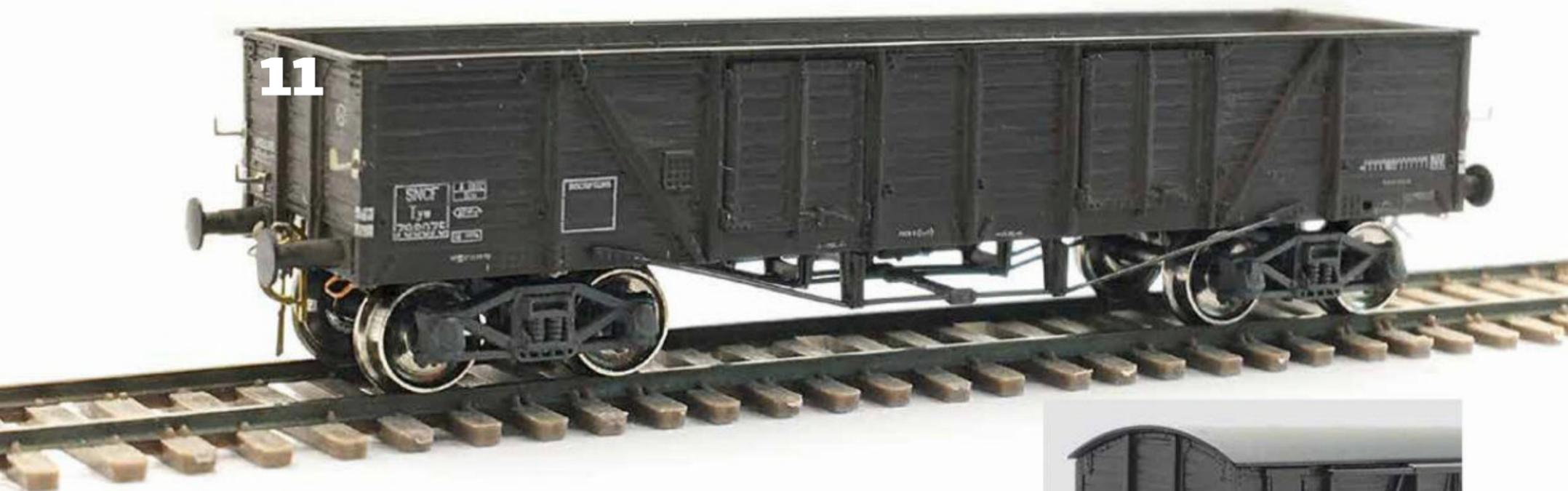
**11.** Le tombereau est équipé de supports de lanternes et de câblots de freins. Ces derniers se placent par le dessous de la traverse en faisant un trou de 0,5 mm de diamètre. Sur cette photo, on voit bien l'alignement du bogie sur le premier renfort vertical de la caisse du tombereau.
