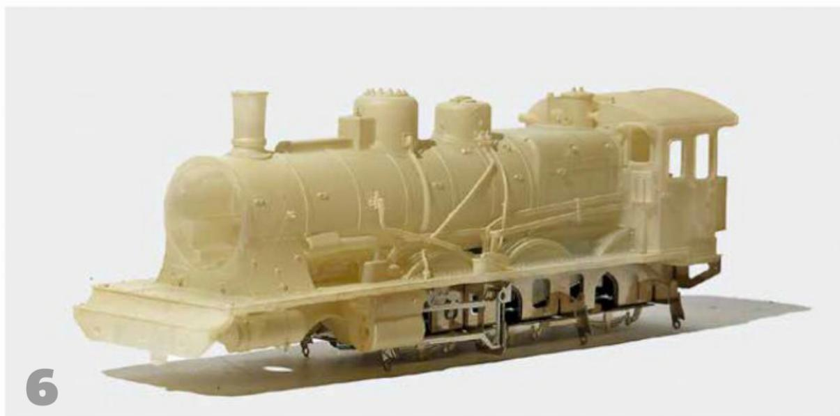
**6:** Un courriel avec la photo et l'envoi d'une nouvelle pièce imprimée dans une résine plus adéquate et le résultat est parfait! Le montage peut donc se poursuivre avec le détaillage de la superstructure.
