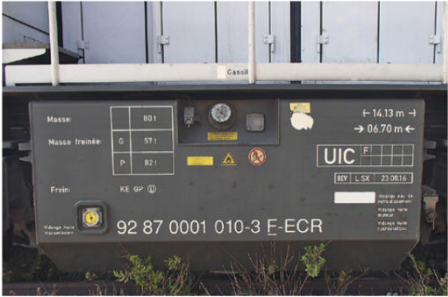
Les réservoirs de gazole portent les différents marquages réglementaires.
