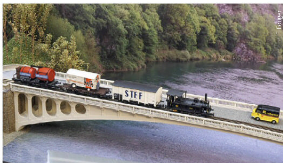
Imprimé par frittage de poudre, le pont de La Balme de François Fouger, est constitué de deux pièces de 60 cm de long réunies par le milieu.
