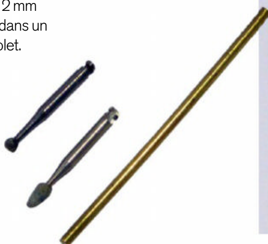
L'emporte-pièce est tiré d'un tube de laiton.
