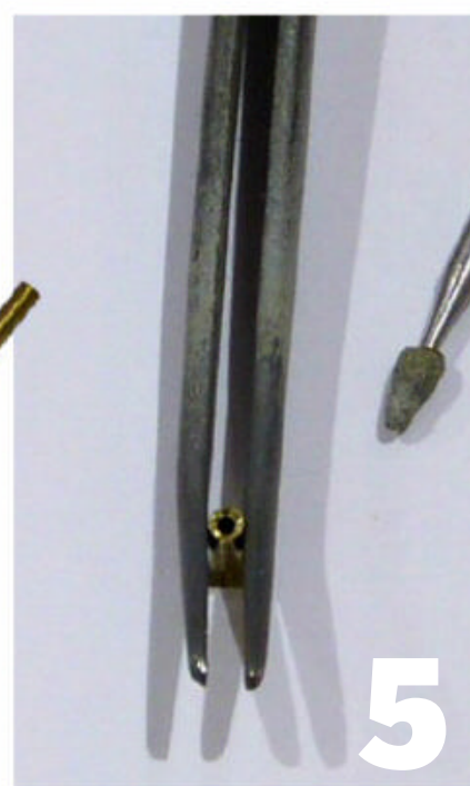
Après usinage, les lèvres de l'emporte-pièce sont très coupantes.
