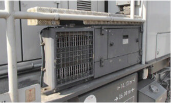
Le Webasto présent sur la machine sert à préchauffer le moteur pour permettre son démarrage.
