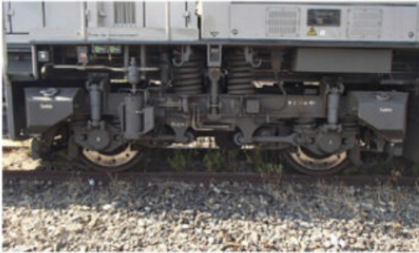
Le bogie, avec le graisseur de boudin et les tubulures associées.
