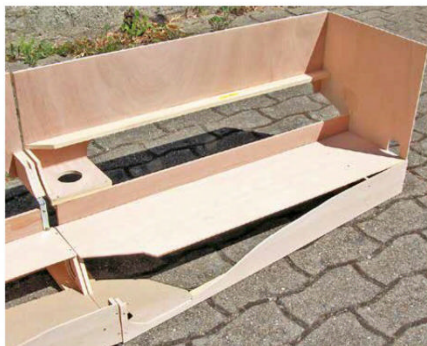
5 - La structure du module de droite est aussi en contreplaqué.
