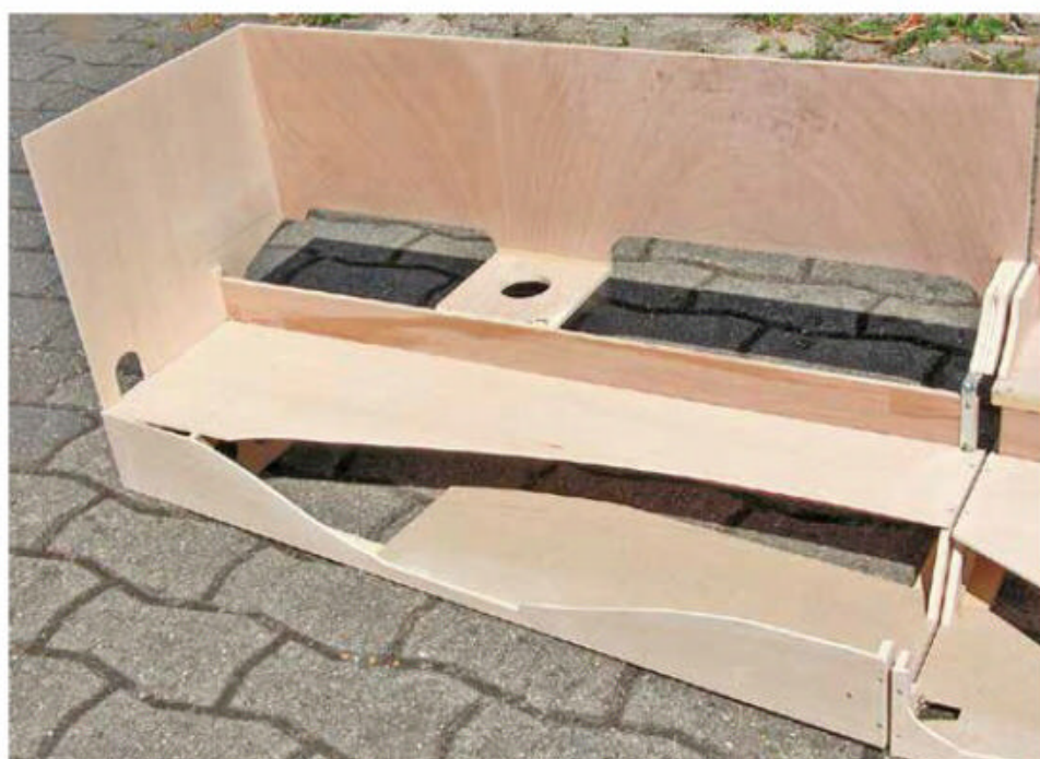
4 - La structure du module décoré de gauche, les trous permettant de diminuer la masse de l'ensemble ne sont pas encore percés.
