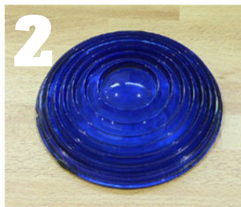
Optique-filtre de signal : matériel récupéré dans les années 80 sur le tas de l'équipement à Caen, Patent USA 1913 !
