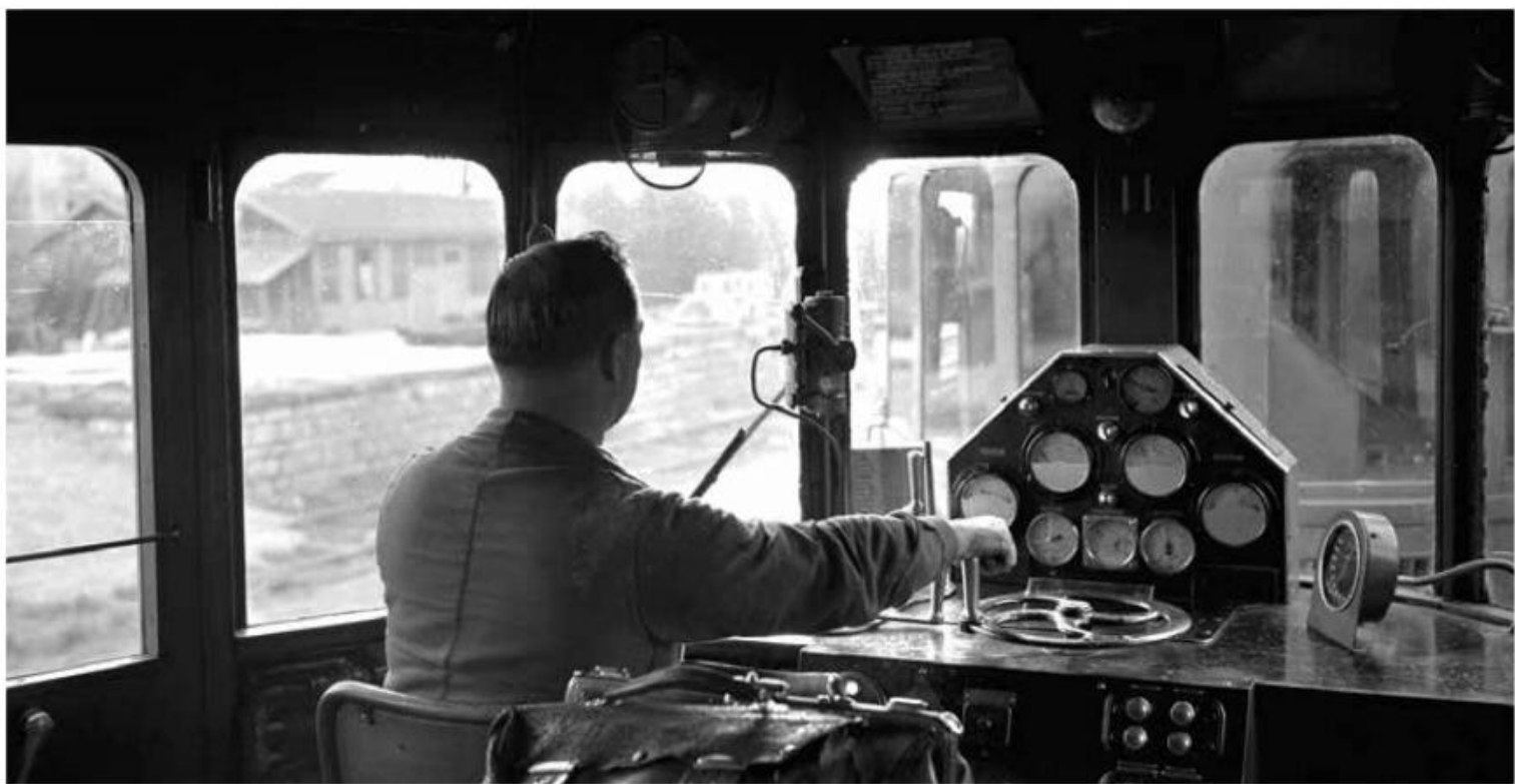
Vue du poste de conduite d'une autorail X 3700 jumelé avec l'un de ses homologues placé en tête.
