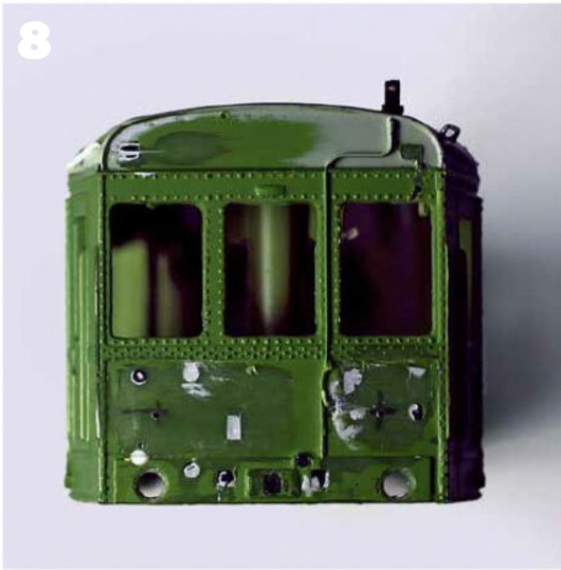
8 Bouchage des trous inutiles, masticage et ponçage.
