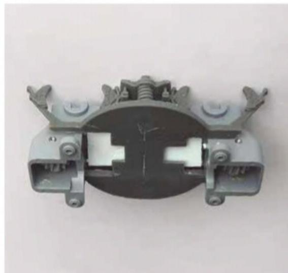
11 Assemblage à blanc du support de moteur Electrotren sur ce qu'il reste du bogie Jouef.
