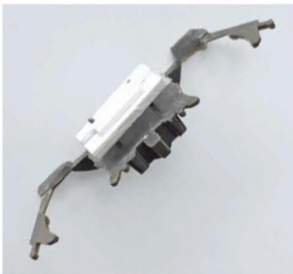
**18** L'intérieur des flancs de bogie est aminci de près de 2 mm, à la hauteur du moteur et des prises de courant.
