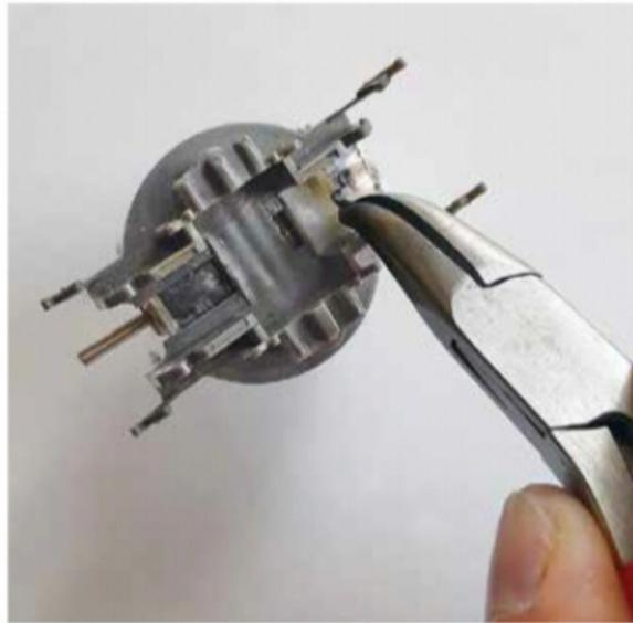
**1** À l'aide d'une paire de pinces, dépose des embouts en plastique de maintien du moteur d'origine.
