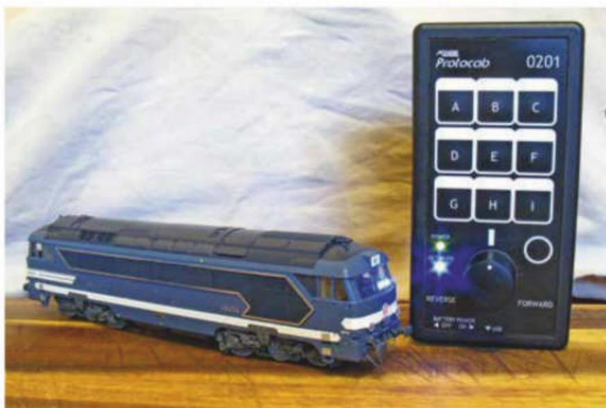
1 Avec Protocab, un boîtier de commande (sans fil) permet de gérer de manière indépendante les locomotives. L'alimentation est confiée à une batterie transportée par la machine (qui peut même rouler, sans rails, sur une table en bois).
