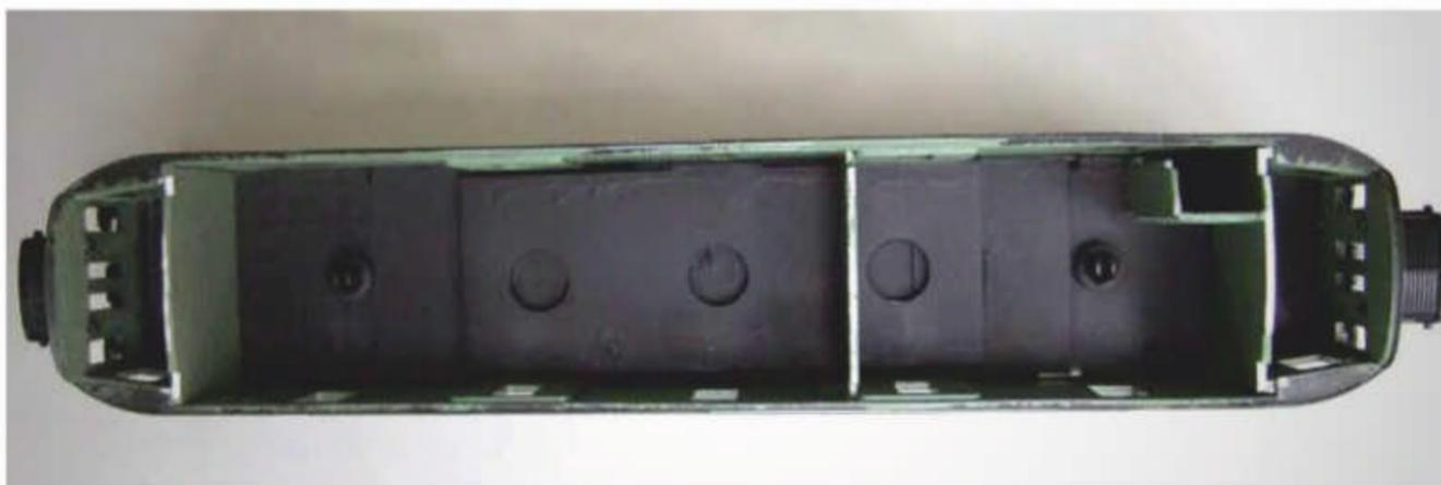
**21** Collez à la cyanoacrylate un lest métallique plat sur le plancher : il servira en plus de renfort.
