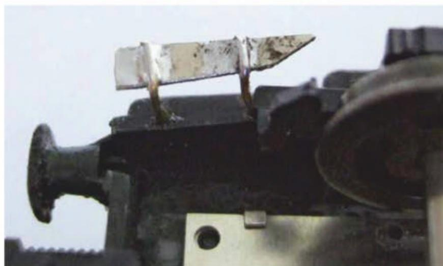
**18** Constituez des marchepieds en laiton soudé, en créant un pan coupé permettant de ne pas entraver la rotation des bogies. Les supports des marchepieds, en fils de 0,5 mm fichés et collés dans des trous percés à la drille à main sous la caisse, sont décalés vers l'extrémité pour la même raison. Sur les photos que j'ai trouvées, les grandes portes n'ont pas de marchepied.
