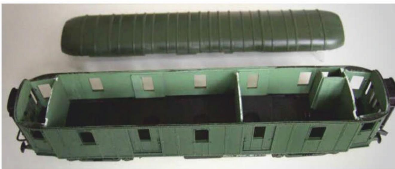
**22** Confectionnez les cloisons dans de la carte plastique de 0,5 ou 1 mm ; et collez-les en place en vérifiant qu'elles ne génèrent pas le montage de la toiture.
