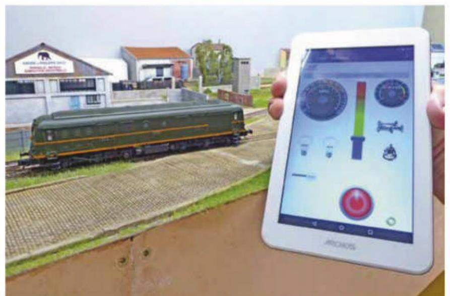
2 LocoFi utilise un logiciel gratuit sur smartphone (ou tablette) pour gérer les locomotives. Équipés d'origine du son, les modules peuvent être associés à une batterie et ne plus dépendre de la propreté des rails (voir l'article paru dans LR 861).
