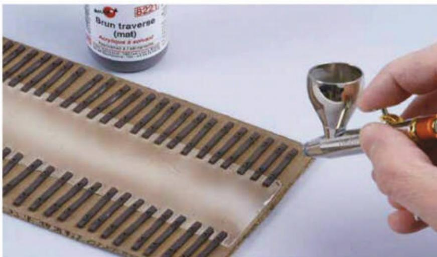
**3** Après nettoyage à l'acétone, la teinte de base est reprise avec de la peinture brune, surtout pour casser l'aspect plastique ; nul besoin de couvrir complètement la surface. Pour éviter que les traverses ne s'envolent, je les fixe par un côté sur un morceau d'adhésif double face.
