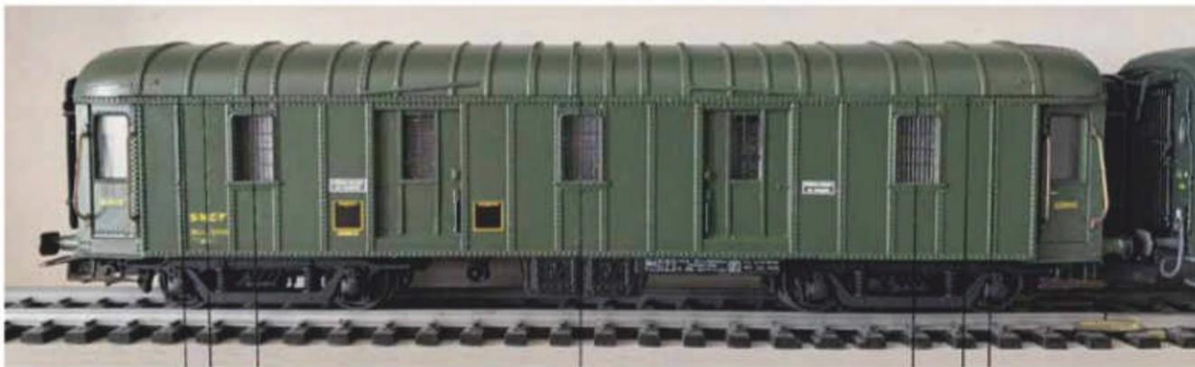
**2** L'autre face est en revanche symétrique. Les tôles de marquage, en bas de caisse, sont positionnées différemment selon la face. Leur mise en place est renforcée par un morceau de carte plastique de 0,5 mm collé par l'arrière.
