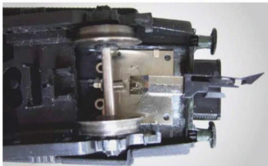
**20** Pour dégager l'espace du boîtier d'attelage, le bogie doit être tronçonné : supprimez la queue d'attelage et la traverse entre les sabots de frein du bogie.
