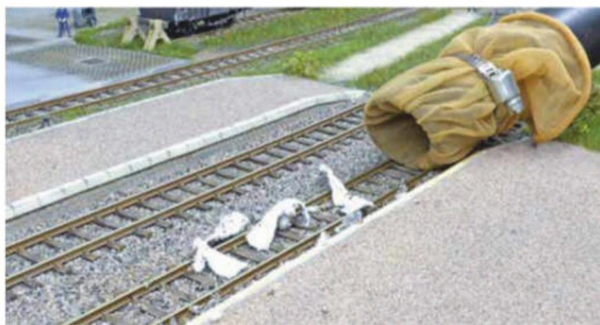
**2** Une solution consiste à fixer avec un collier type Serflex [ou un simple élastique, NDLR] un morceau de collant sur l'embout de l'aspirateur. L'élément involontairement aspiré est retenu par le collant, ce qui facilite sa récupération lorsque l'aspiration est stoppée.
