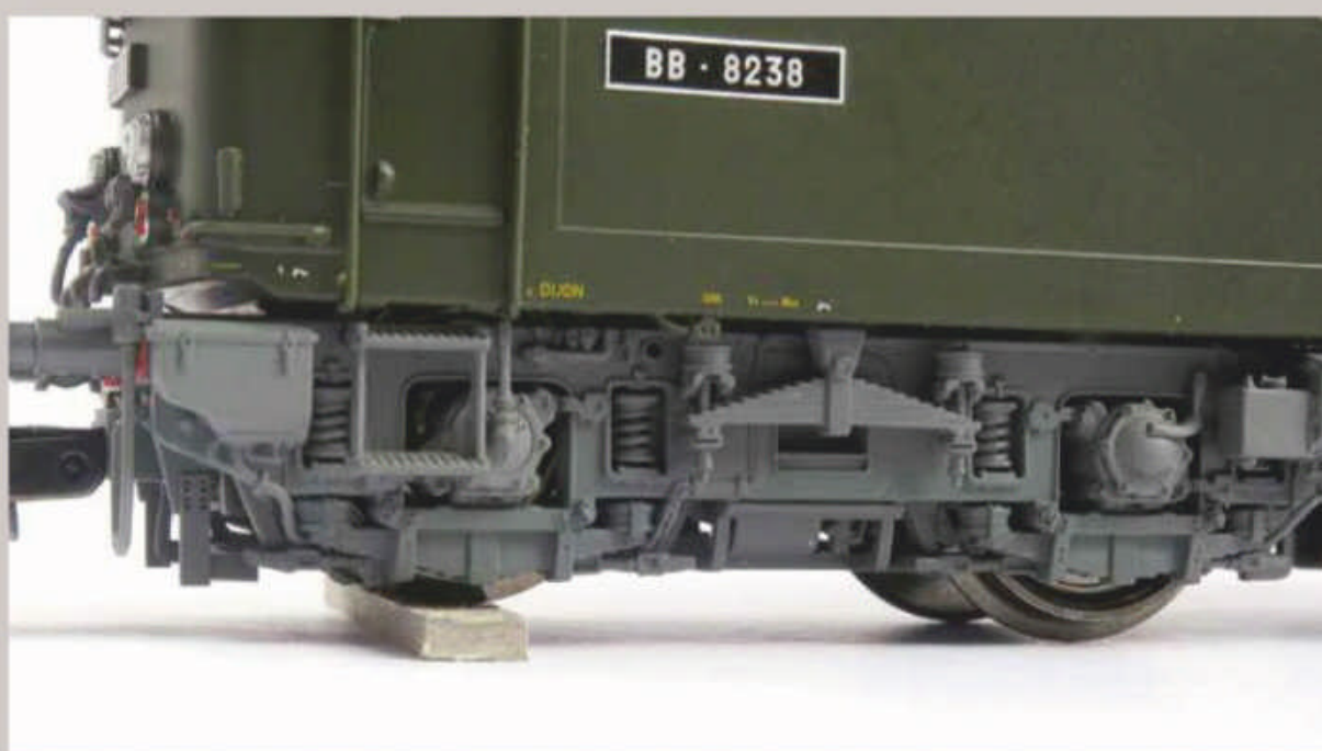
Le support des essieux pivote selon un axe transversal, ce qui permet aux essieux d'épouser les défauts de planéité de la voie.
