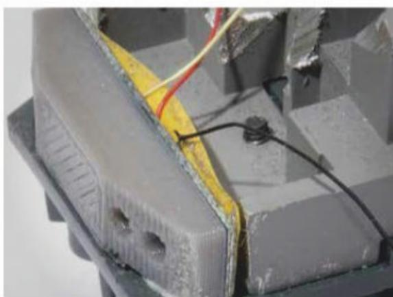
**12** Notez le ruban adhésif d'électricien qui protège le circuit imprimé de tout risque de court-circuit. L'avantage de cette solution est de conserver une caisse facilement amovible : bien vu !
