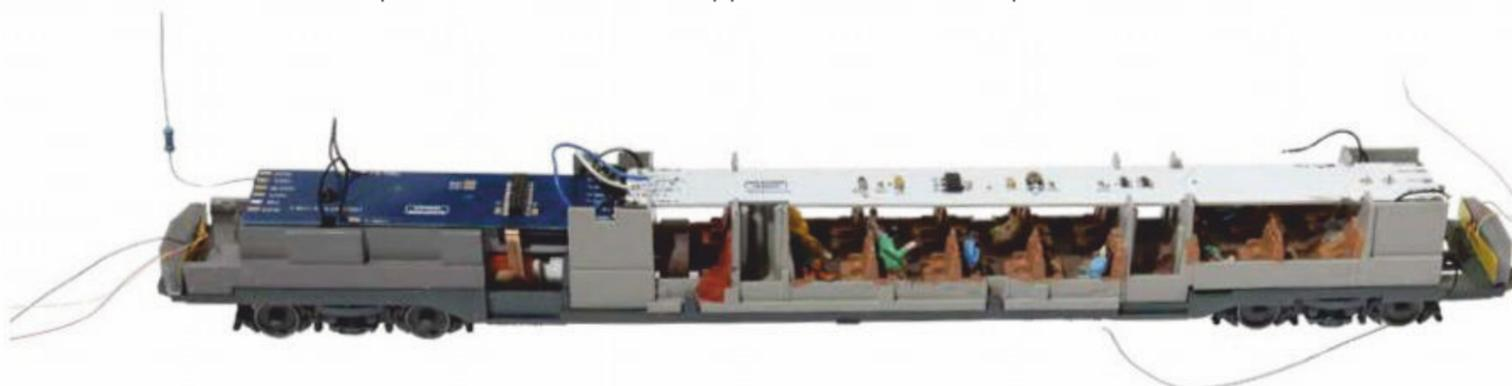
**16** Installez l'ensemble sur le châssis. Les nouvelles platines s'encastrent presque parfaitement. Il peut être éventuellement nécessaire de retailler le haut de certaines cloisons.
