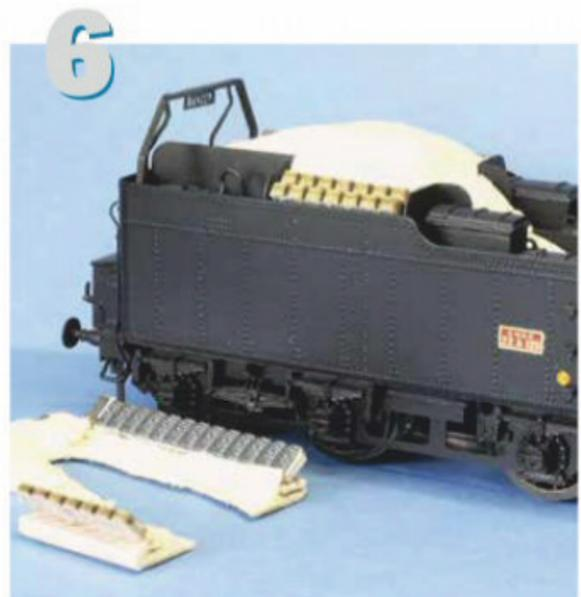
6 Dans une chute de polystyrène extrudé, sculptons les volumes de charbon adaptés à nos deux versions. Collons-les sur les embases à la colle à bois (la colle cellulosique les détruirait).
