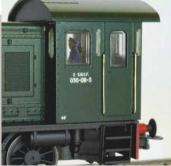
Les déflecteurs, de part et d'autre de la porte d'accès, n'apparaissent pas sur les photos d'époque. Il faudra boucher leurs emplacements si l'on ne souhaite pas les mettre en place.
