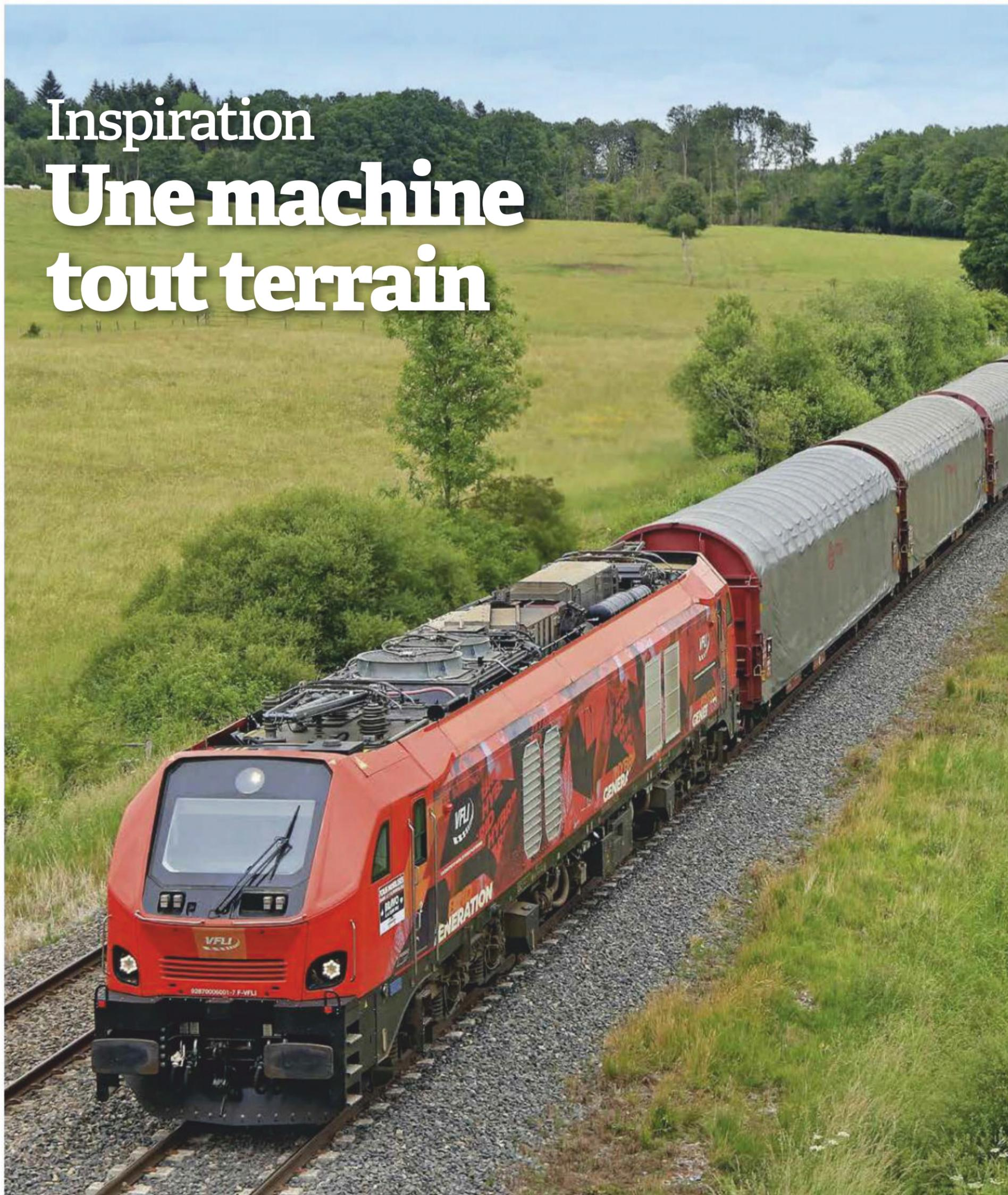
**L'**opérateur fret VFLI possède l'unique exemplaire français de la locomotive hybride Eurodual fabriqué par Stadler Espagne (site racheté à Vossloh en 2016). D'une puissance de 6175 kW sous caténaire 25 kV 50 Hz, 4110 kW sous caténaire 1,5 kV continu et 2525 kW en mode thermique, l'Euro-
