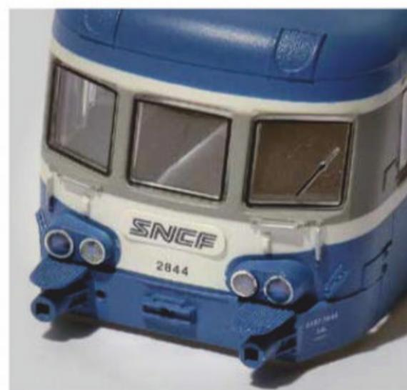
**23** Enfin, à l'aide de Vitrex, formez le verre des feux. Autre solution : découper un tronçon de la pièce en plastique transparent d'origine et l'insérer...
