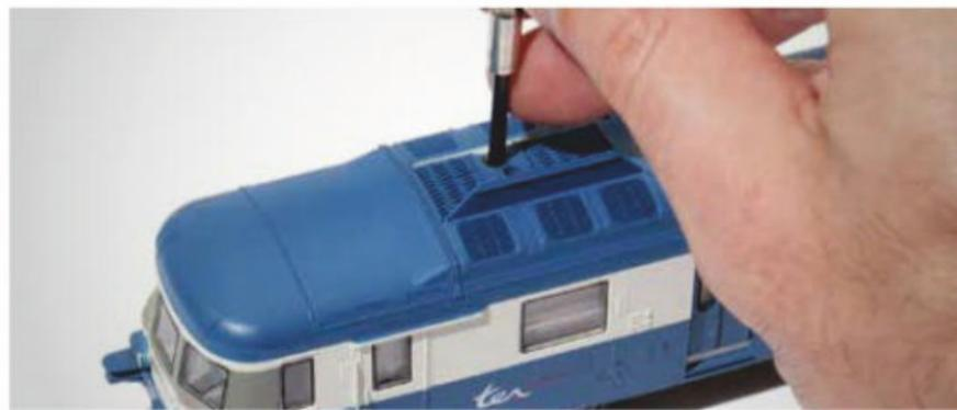
**2** Déposez l'orifice d'échappement droit, compartiment moteur à l'avant, en le tirant délicatement, puis dévissez complètement la vis cruciforme qui apparaît alors. Écartez ensuite légèrement les flancs de caisse et glissez des morceaux de carton entre ceux-ci et le châssis pour désolidariser la caisse du châssis.
