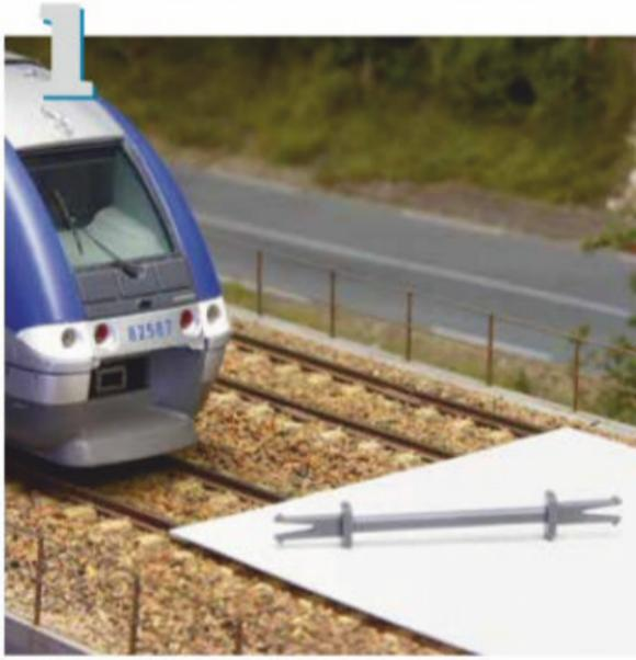
Une fois l'attelage automatique factice (Scharfenberg) retiré, on découvre le boîtier NEM, très mobile sur son pivot et installé en retrait. Devant : la barre d'attelage livrée par le fabricant.
