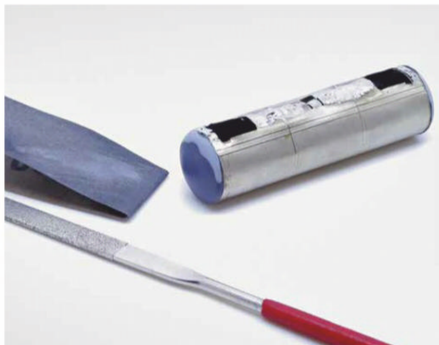
4 Le bas de la citerne est limé et poncé avec légèreté pour une mise en place parfaite sur le châssis. Les attaches inférieures sont supprimées.
