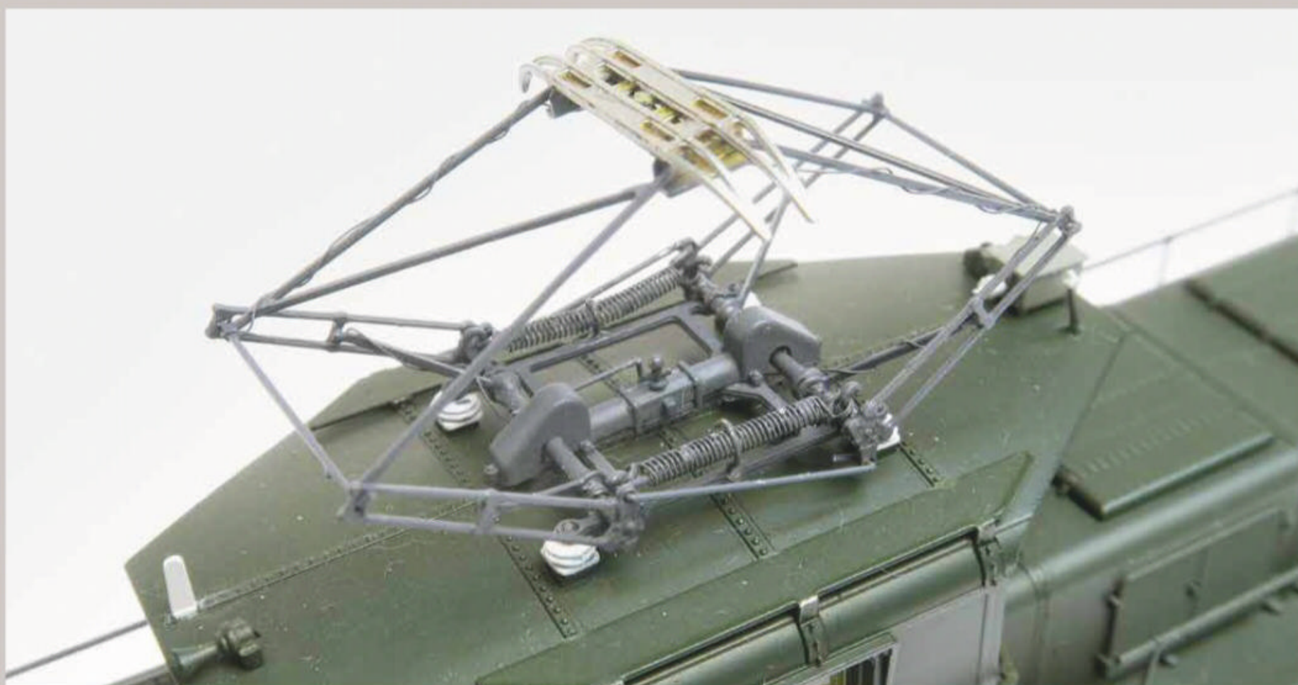
Ce pantographe est de type G, équipant les machines en versions récentes.
