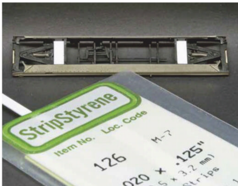
3 Une pièce en EVG 126 remplace la pièce d'origine Brawa pour le maintien des boîtiers d'attelage.
