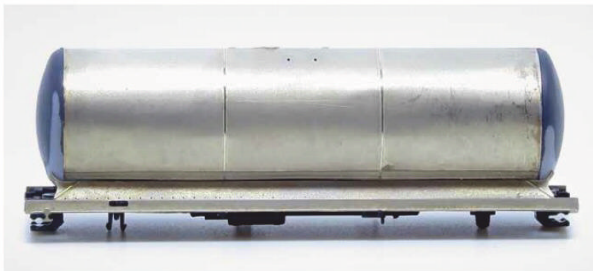
5 La citerne prend place sur le châssis et est collée par l'intérieur des supports.
