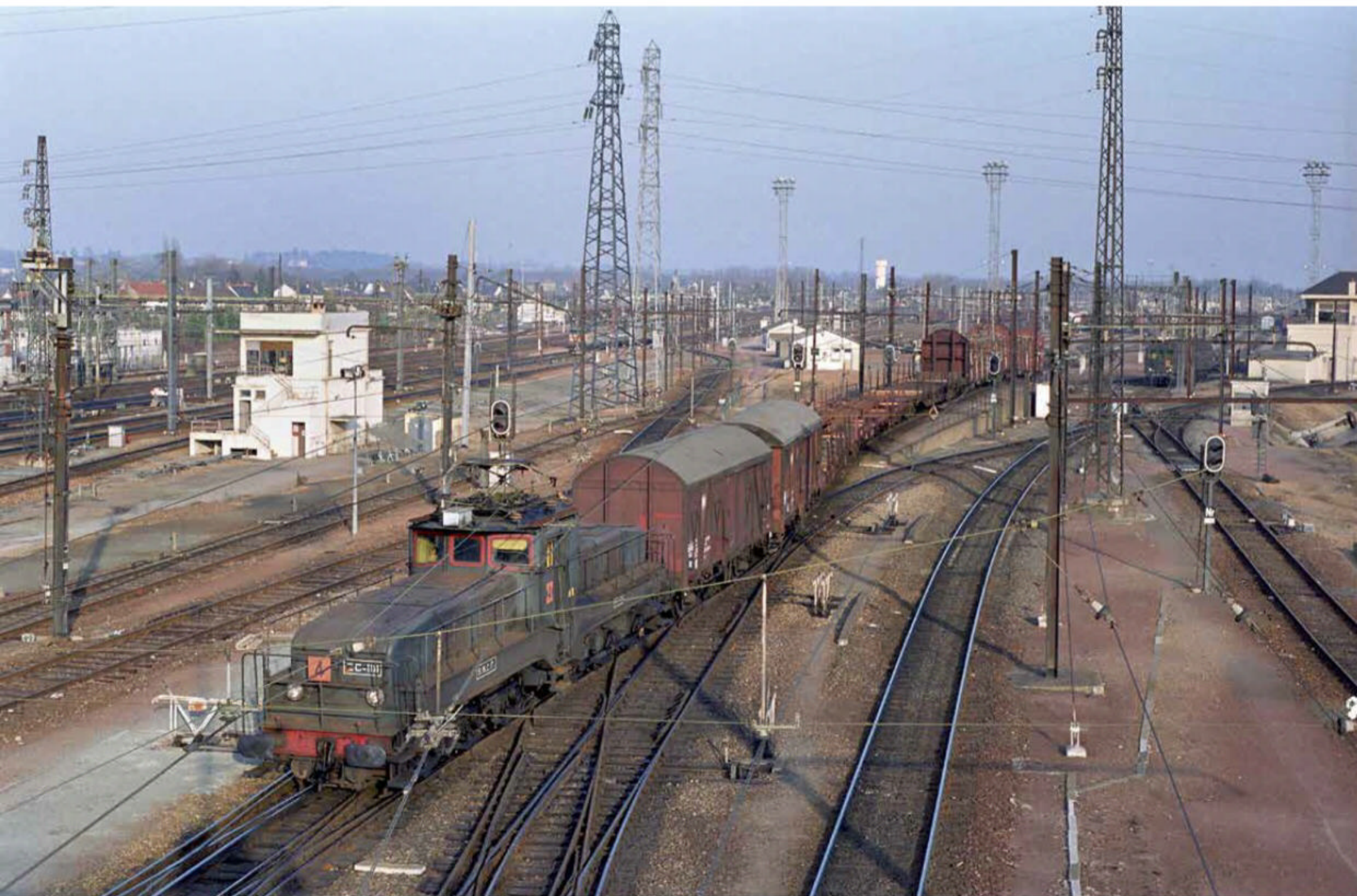
Le 8 février 1992 à Saint-Pierre-des-Corps, la CC 1111 assure la tâche pour laquelle elle a été conçue : la lente pousse de rames au débranchement sur la butte du triage.
