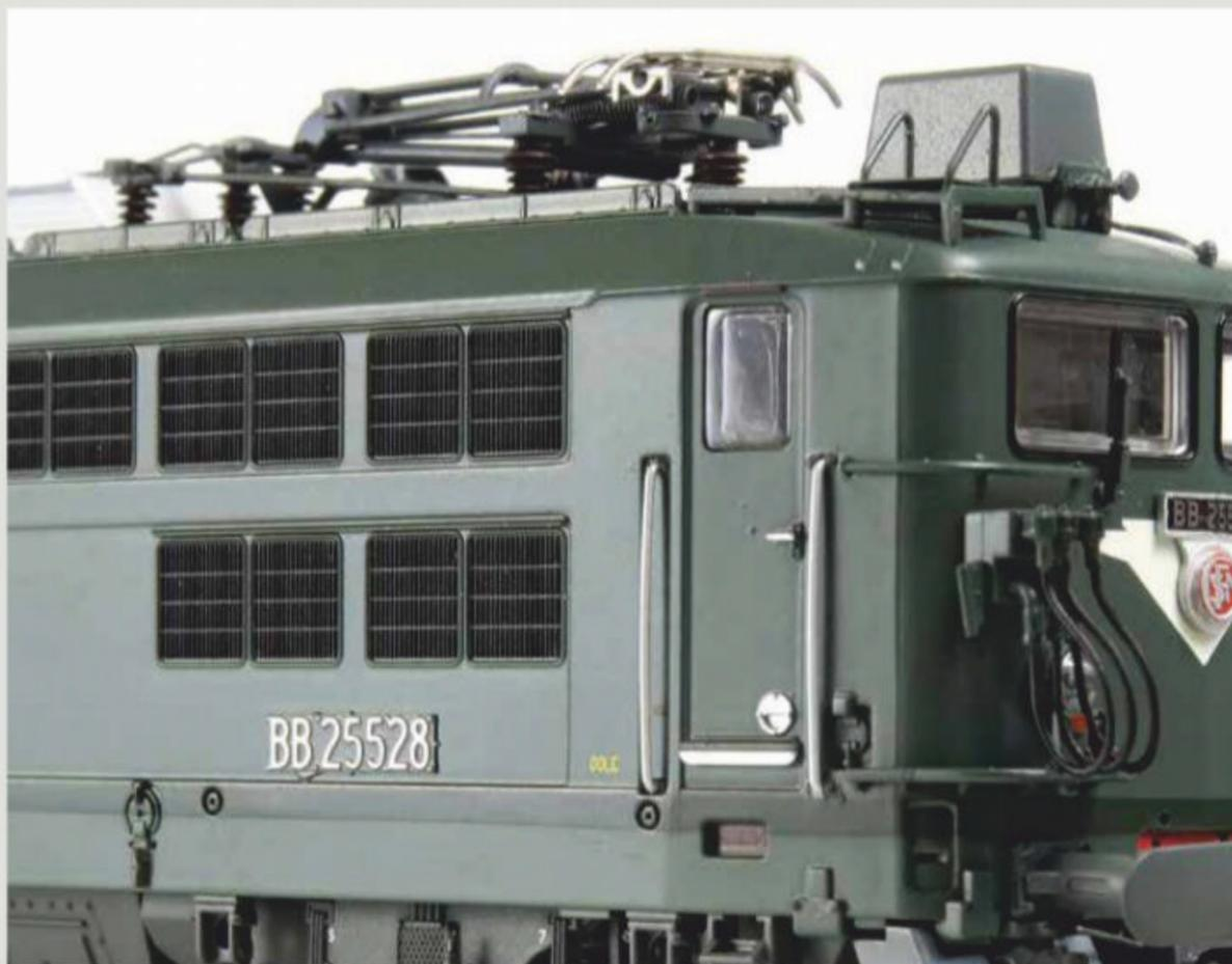
Admirons le réalisme des persiennes et de l'étonnant gros boîtier de liaison radio de cette machine du dépôt de Dole.
