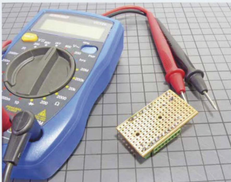
Retournez la platine et vérifiez avec un ohmmètre qu'il n'y a aucun court-circuit. À l'aide d'un foret, supprimez le cuivre autour des trous de fixation.
