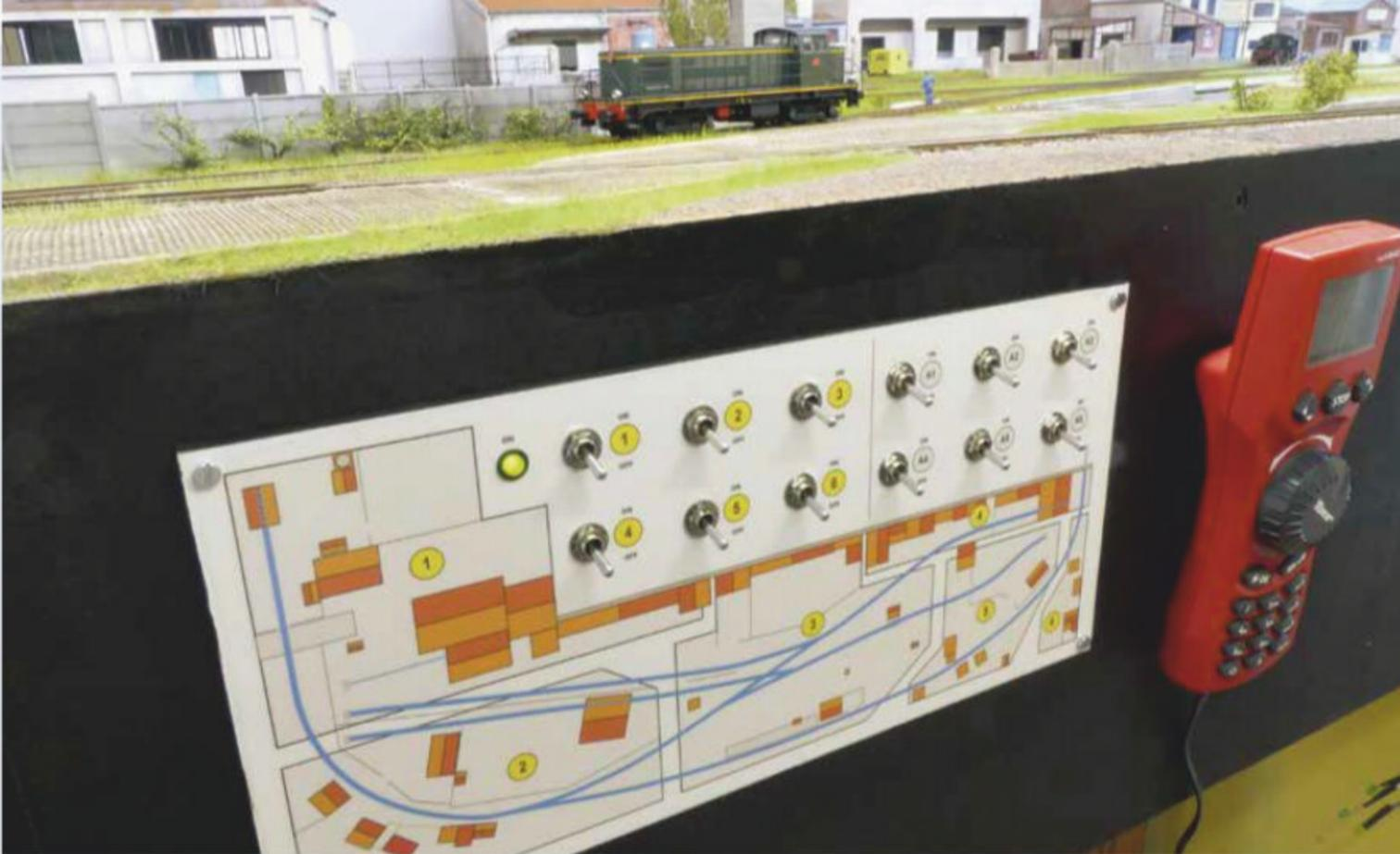
Le TCO est fixé par des boulons de 3 x 15 mm. La LED verte (rappel de la présence de tension sur le feeder « accessoires ») est câblée directement sur le feeder (utiliser une résistance de 800 Ω).
