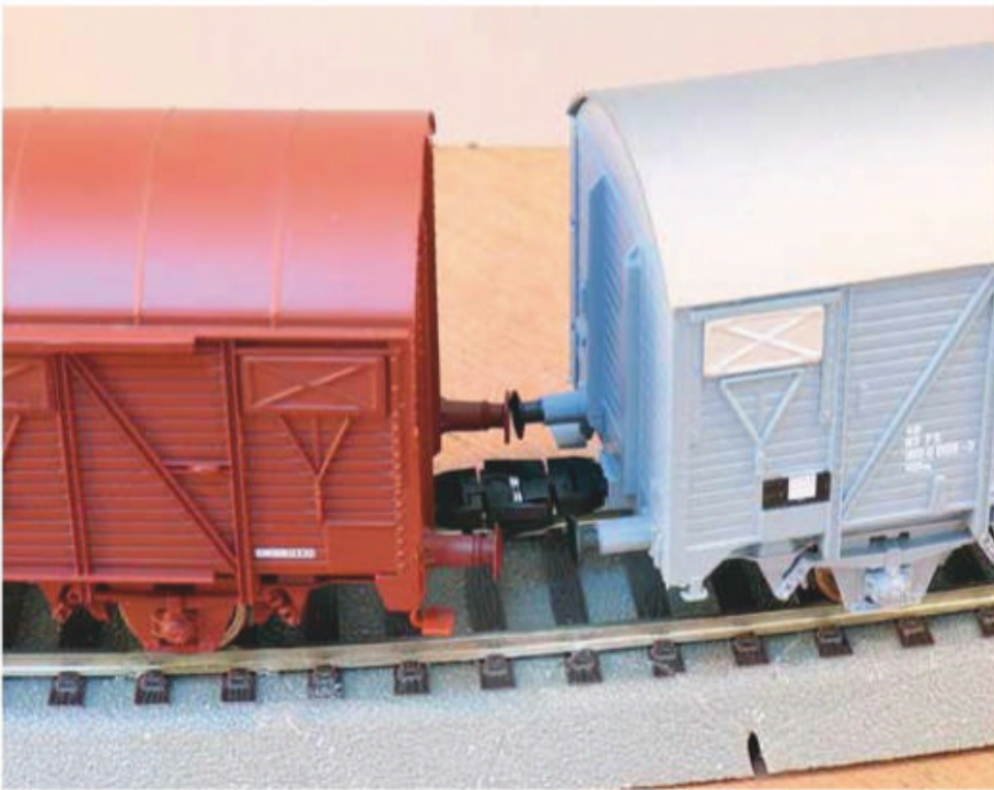
27 En courbe de rayon de 450 mm, on attelle sans problème ces deux couverts à essieux avec le système magnétique...
