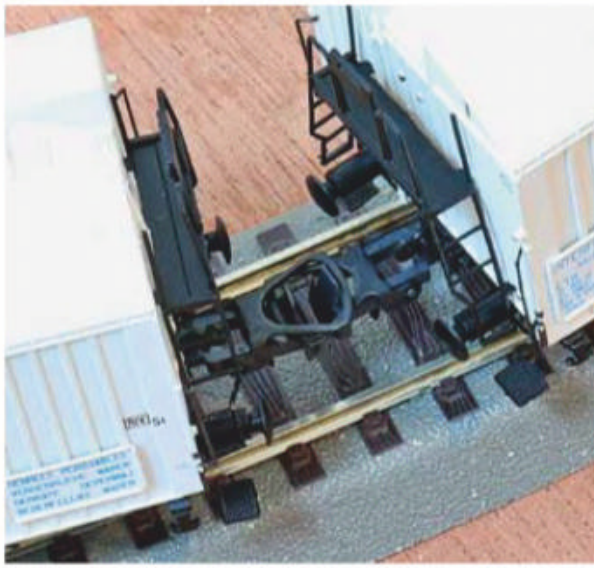
37 Les attelages à boucle tendent à se comprimer...
