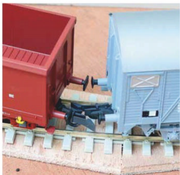
24 En courbe prononcée, impossible d'atteler des wagons à essieux à têtes courtes (ici « Harpon » Roco).
