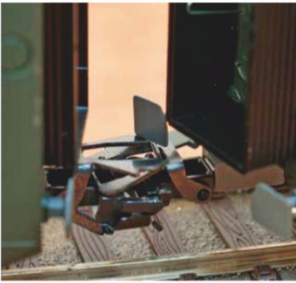
36 L'attelage court de Märklin accroche aussi les tampons en courbe prononcée.
