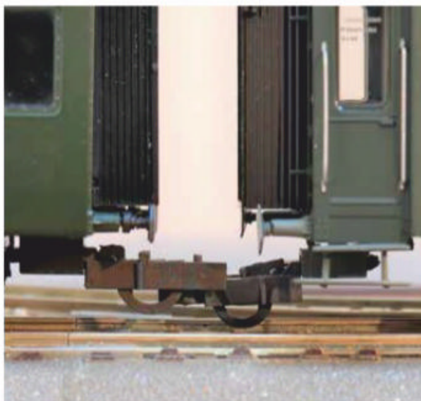
22 Une différence de hauteur des boîtiers n'empêche pas nécessairement le raccordement d'attelages « Harpon ».
