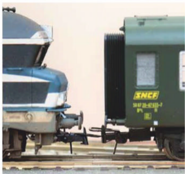
21 D'un véhicule à l'autre, les boîtiers NEM peuvent ne pas être à la même hauteur, rendant difficile l'attelage par boucle.
