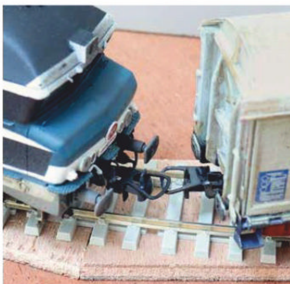
25 Lorsque les véhicules ne sont pas équipés d'élongation, les attelages peuvent se présenter face à face en courbe, si la longueur du timon l'autorise !
