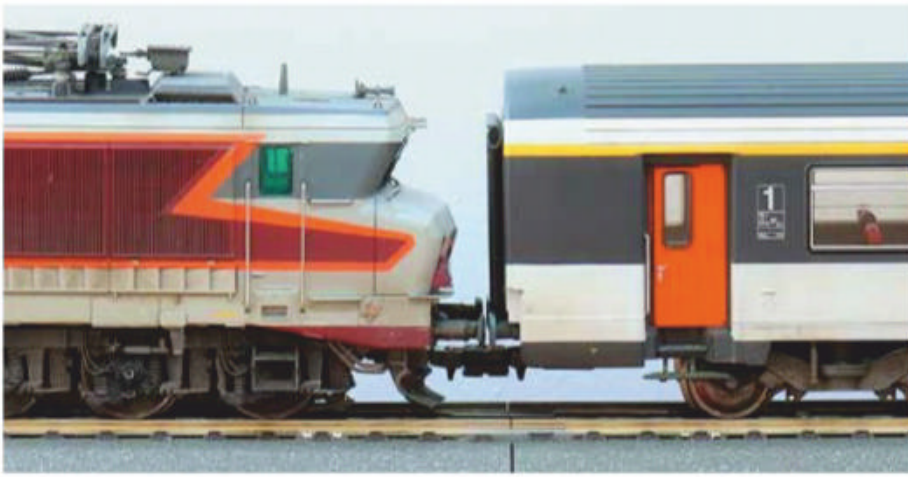
10 De profil l'attelage REE/Est-Modèles reste discret, mais visible sous les tampons.
