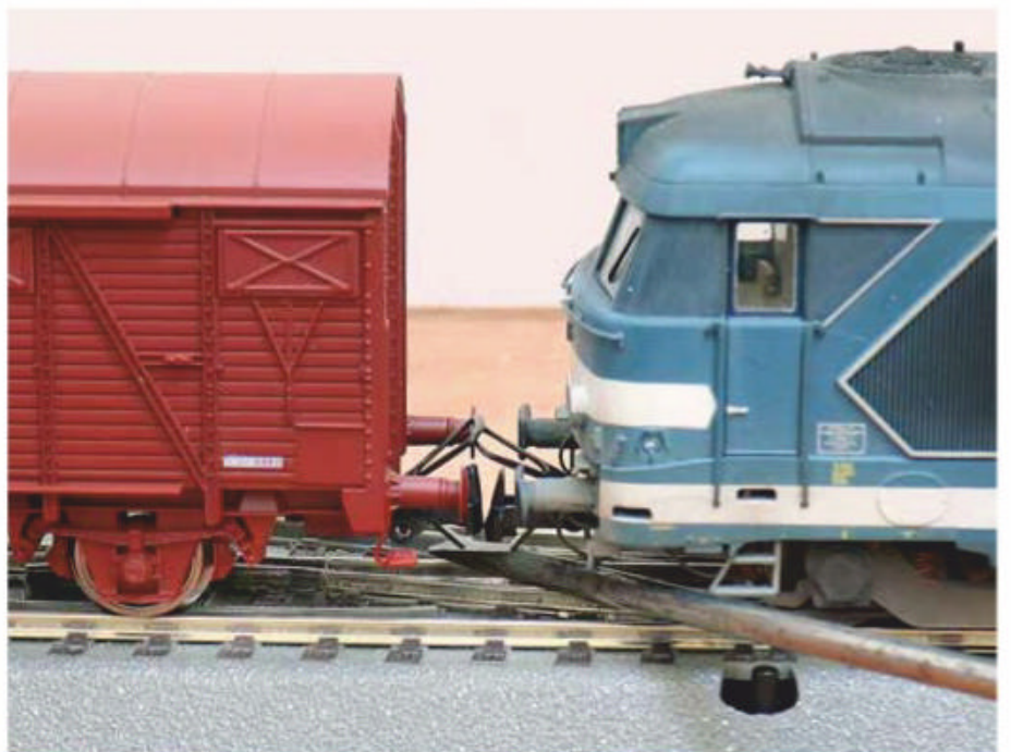
31 Dételage manuel à l'aide d'un tournevis plat.
