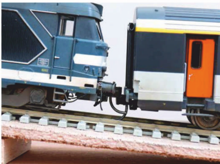
34 Au point d'inflexion d'une forte rampe, l'attelage Kadee n'assure plus !
