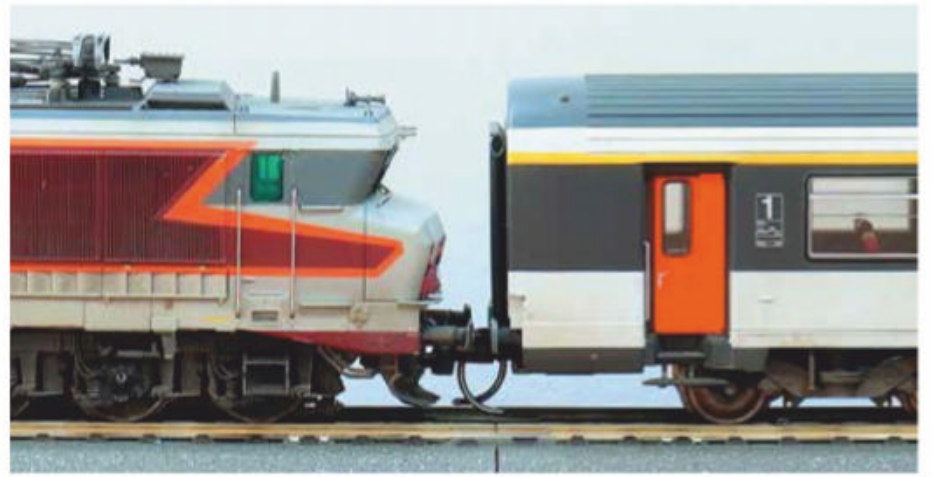
11 L'attelage Kadee est à hauteur de l'attelage réel et, de fait, caché par les tampons.
