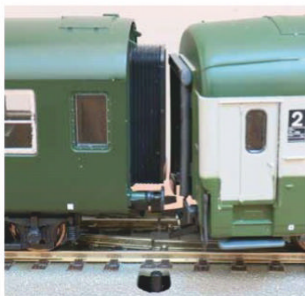
26 Les attelages magnétiques n'ont pas toujours le succès attendu, notamment lorsqu'il s'agit de raccorder deux voitures longues dans une courbe, même de grand rayon (> 600 mm).
