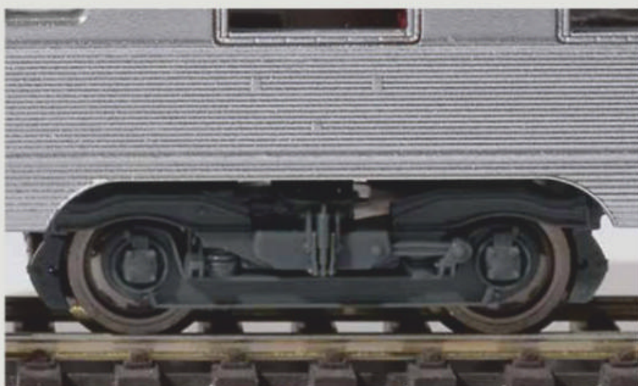
Gros plan sur le bogie Y 20 amélioré (sabots de frein...).
