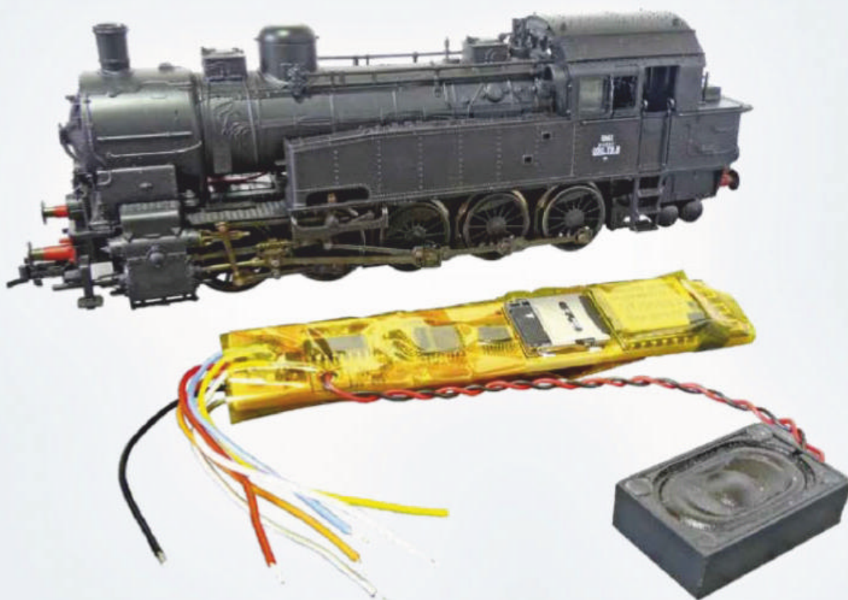
Photo 2. Le décodeur LocoFi est d'une taille assez importante : il ne tiendra pas dans cette 050 Fleischmann.
