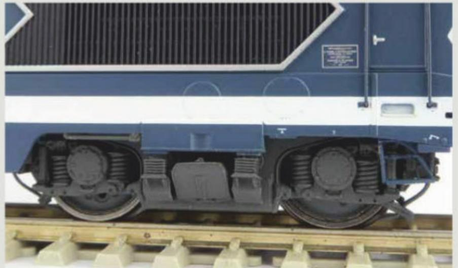
Cette version est équipée de graisseurs de rails, entre les deux blocs de suspension, sur le bogie.
