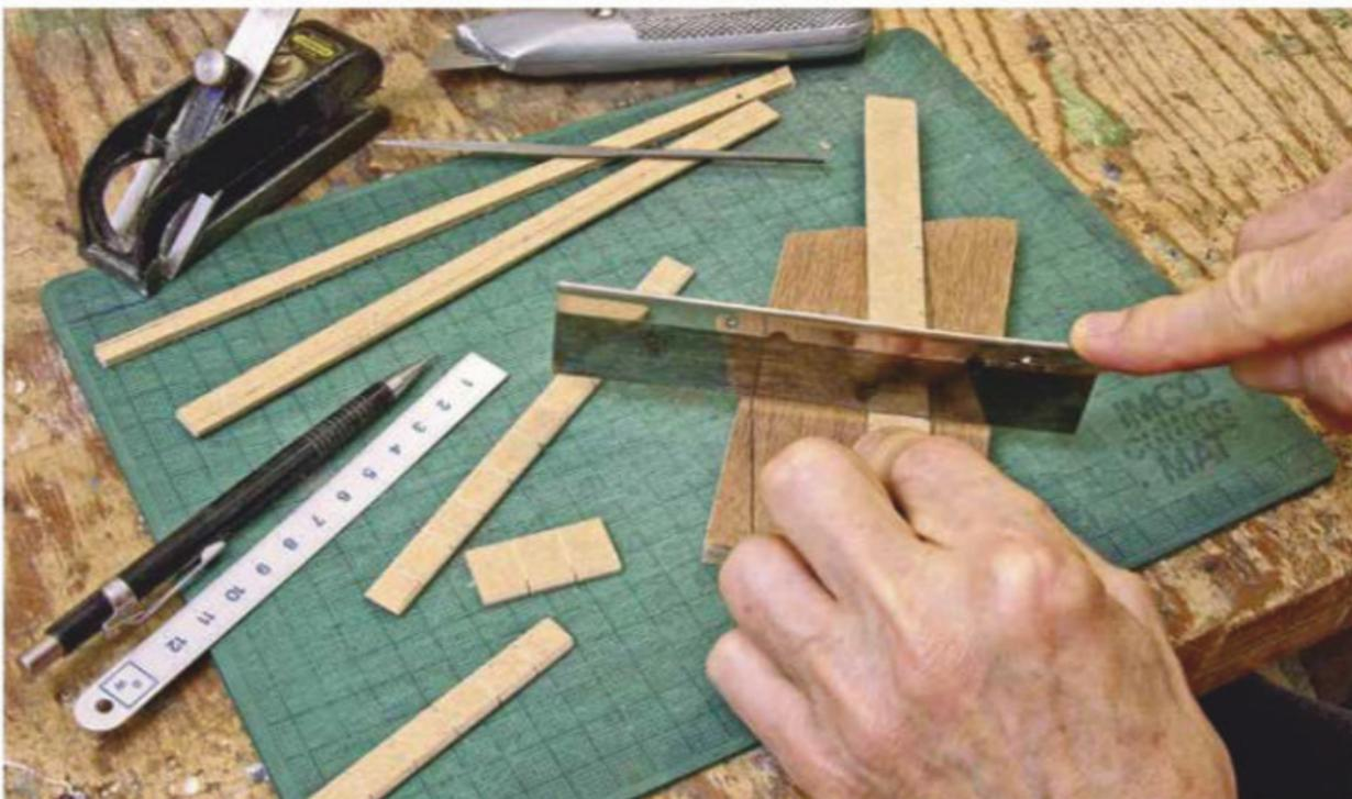
**12** Les pierres de couronnement sont confectionnées en bandes dans du MDF de 3 mm. Pour renforcer leur caractère ornemental, les arêtes supérieures peuvent être rabotées en biseau. Les joints transversaux sont ensuite marqués à la scie à dos et renforcés d'une entaille latérale sur la tranche visible.
