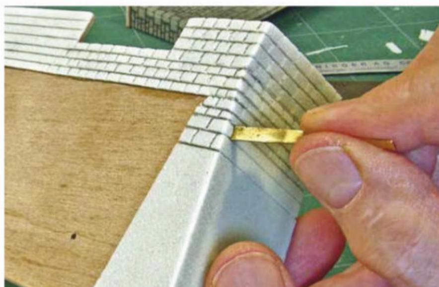
**10** Un des avantages du Heki-dur est qu'il peut être proprement poncé pour faire disparaître le joint d'angle et former un substrat uni pour représenter des pierres d'angle en volume cohérent sur les deux faces (un challenge classique pour le modéliste qui assemble des parois de maçonnerie prégravées).
