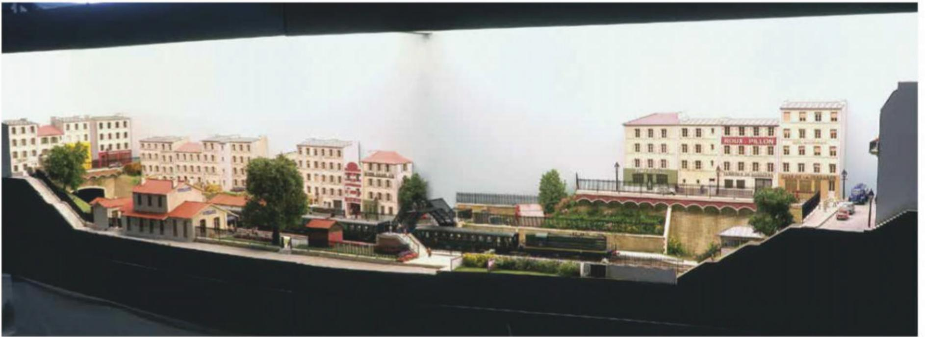
L'ensemble de la gare prend place dans un caisson d'une surface de 240 x 40 cm, avec éclairage par tubes fluorescents intégrés.
