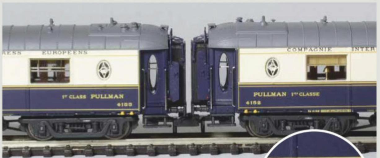
Ces voitures ont fière allure côte à côte; notez la présence des courroies d'entraînement des génératrices sous les caisses.
