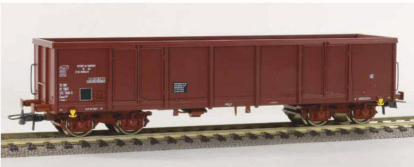
**Roco** (<roco.cc>) propose ce bel Eaos E80-2 (16 cm) immatriculé 33 87 532 7046-5 dédié au transport de sel et de granulats (réf. 76729, 25 euros environ). En réalité révisé à Tergnier le 25 janvier 2003, ce wagon est à apte à circuler à 100 km/h. Le modèle est conforme aux standards de la marque : décoration impeccable, roulement parfait, prix contenu. **AP**
