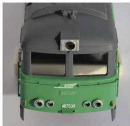
3 Une fois les marquages positionnés, un nouveau voile de vernis brillant fait disparaître les contours des décalcomanies.
