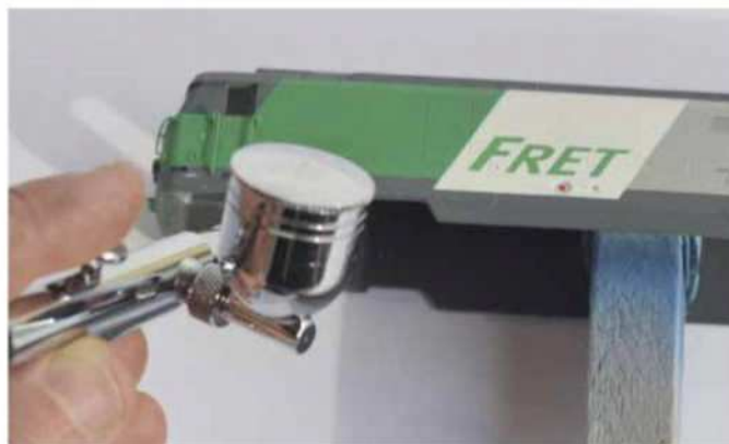
2 Avant de poser les marquages, une couche de vernis P310 puis une bonne nuit de séchage.
