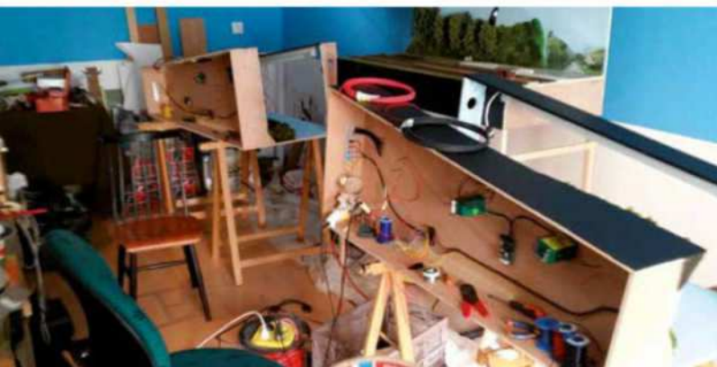
La construction du réseau en modules est bien pratique au moment du câblage.
