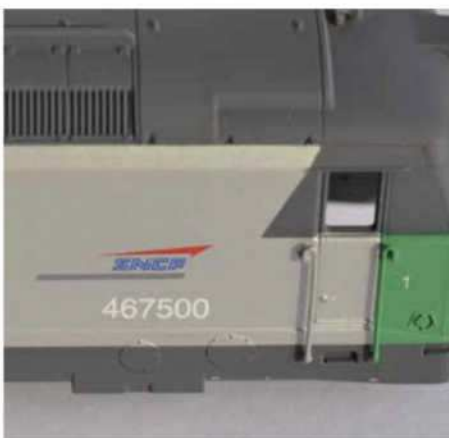
3 Une fois les marquages positionnés, un nouveau voile de vernis brillant fait disparaître les contours des décalcomanies.
