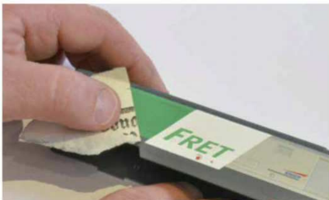
1 L'ancienne numérotation est supprimée à l'aide papier de verre grain très fin (4000) utilisé mouillé.
