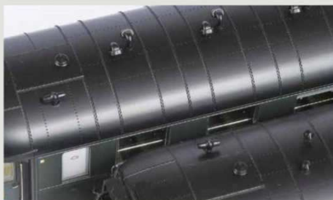
Deux types d'aérateurs équipent ces voitures.
