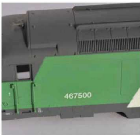
3 Une fois les marquages positionnés, un nouveau voile de vernis brillant fait disparaître les contours des décalcomanies.
