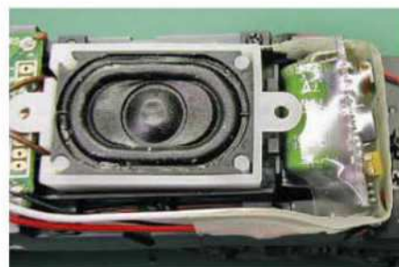
9 Le haut-parleur est collé dans l'emplacement prévu initialement pour un décodeur plus gros, le Power Pack est fixé à l'adhésif contre le haut-parleur.
