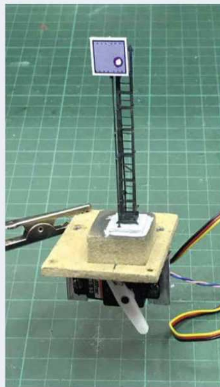
3 Ce carré violet sur mât PLM est aussi doté d'une motorisation par servomoteur.
