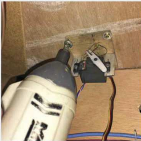
20 Vissage immédiat de la plaque (trois vis à bois de 3 x 12) : le signal est en place.
