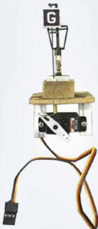
1 Le signal à tableau G mobile est solidaire de sa base, sous laquelle le servo est monté.
