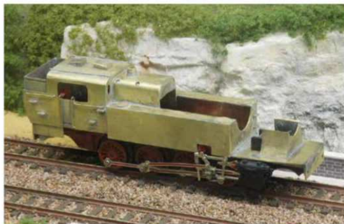
4 Le tablier est maintenant en place sur la partie avant du châssis.
