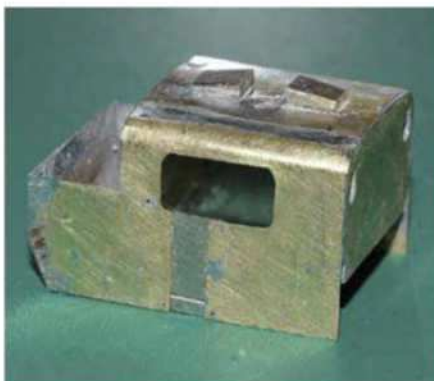
2 L'ensemble flancs-toiture est mis en forme pour épouser les deux faces de l'abri.
