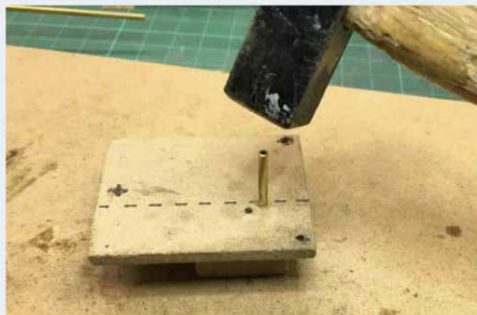
7 L'utilisation d'un tube de laiton de 2 mm extérieur facilite le déplacement ou la rotation de la tige de commande. Le tube est enfoncé à force dans le trou précédent et déborde de 20 mm sous la plaque. Il affleure la surface supérieure du bloc.
