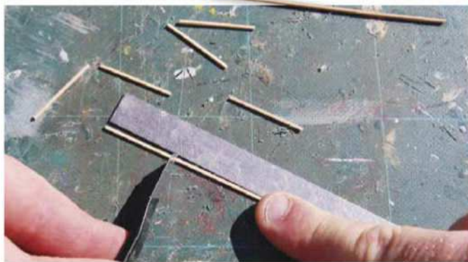
5 L'utilisation d'un régle est fortement conseillée lors de la fabrication des cales.
