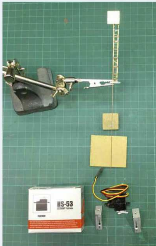
5 La construction de ces ensembles nécessite peu d'éléments : le signal mécanique, préalablement monté, le bloc de médium de 10 mm (selon l'épaisseur du plateau). La plaque de 3 mm (40 mm de large au minimum ; sa longueur dépend de celle du signal). Il faut un mini-servomoteur, par exemple ce modèle Hitec HS-53 qui ne coûte que 7 €.
