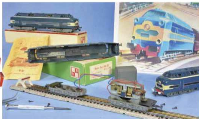
Abandon du châssis en zamac au profit du plastique, largement utilisé pour le dernier engin moteur de la marque, la 060 DB.
