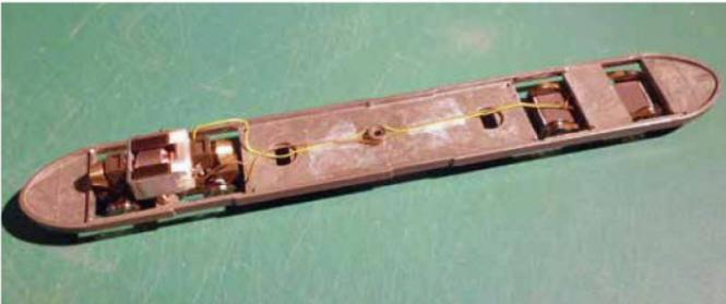
**8** Un câblage provisoire permet de vérifier le comportement sur rail : tout va bien !
