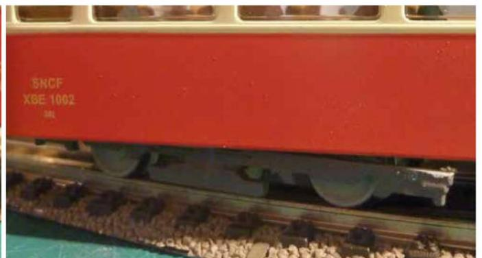
**38** Vérifications : les flancs passent bien en dessous du bas de caisse et au-dessus des rails : nos bogies pivotent sans aucun obstacle.
