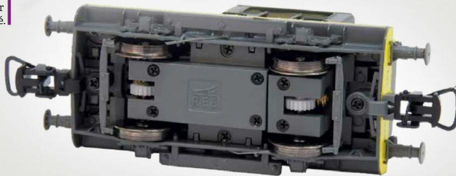
Sous l'engin, de nombreuses vis fixent les sous-ensembles. La maintenance du bogie moteur sera aisée.
