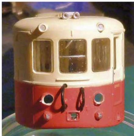
**26** Agrandissez l'intérieur des optiques en perçant bien droit, au centre, avec un foret de 2,5 mm, puis terminer doucement avec une lime ronde pour arriver à 3 mm. Attention, il restera peu de matière plastique autour des phares ! Réduisez ensuite à la lime plate le diamètre des LED bicolores, de façon à ce qu'elle s'insère légèrement en force.
