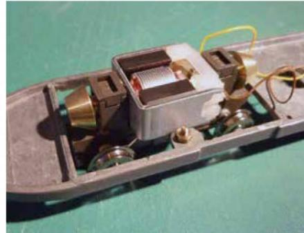
**9** Avant de fixer définitivement le pivot du moteur sur le châssis, on prendra soin de déposer une petite goutte de « frein-filets » sur les pas de vis.
