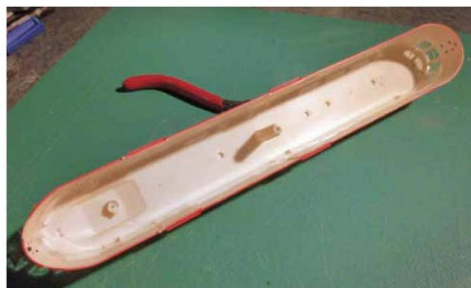
**19** Pour préparer l'éclairage intérieur, les deux colonnes de fixation de la caisse (désormais inutiles) sont arasées au ras du plafond. Seule la colonne centrale est conservée.
