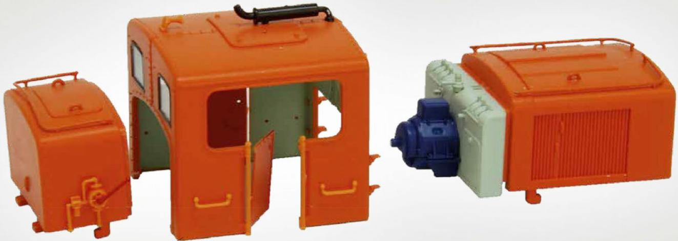
Capots et cabine sont fixés par un système d'ergots. Leur démontage est très aisé.
