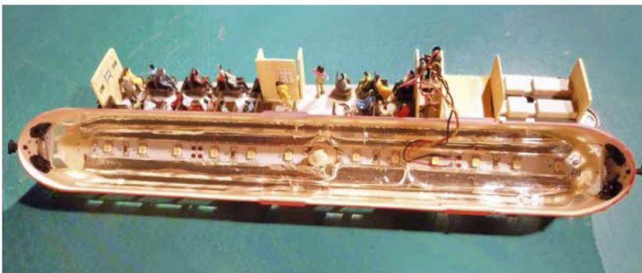
**34** Pour éviter les fuites de lumière par le toit, j'ai collé à l'adhésif double face des bandes d'aluminium ménager, en prenant garde à ce qu'ils ne touchent pas les soudures des rubans de LED (attention au court-circuit!).
