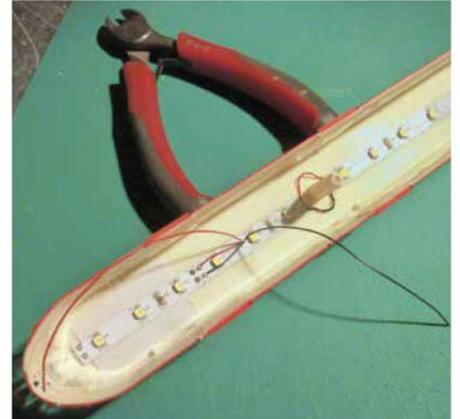
**24** Câblage et pose du ruban à LED, séparés en deux ensembles de deux coupons pour éviter la colonne centrale. Les soudures sont faites avant la pose du ruban, pour éviter une déformation de la caisse due à la chaleur du fer à souder !
