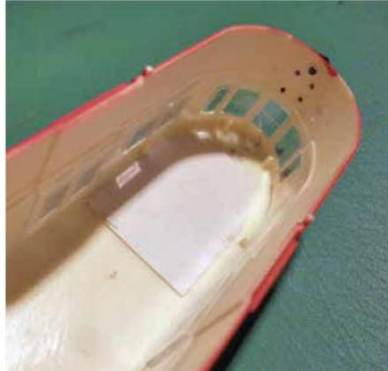
**23** Une chute de carte plastique collée sous la coiffe supérieure facilitera une pose « à plat » du ruban à LED.
