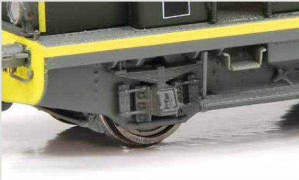
Les marchepieds et boîtes d'essieux sont des pièces rapportées en plastique sur le châssis métallique.
