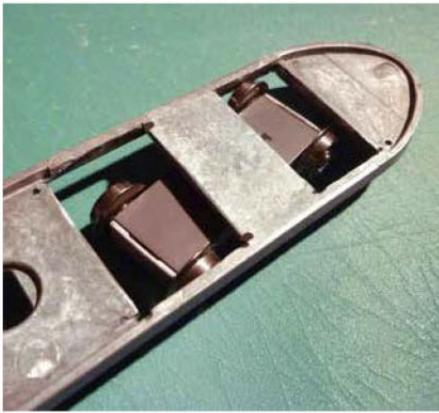
**5** Attention pour ceux qui ont des courbes très serrées sur leur réseau : il vous faut isoler le châssis pour éviter que les roues en opposition touchent le bâti métallique, provoquant ainsi un court-circuit ! Sur mon réseau, le Berliet passe sans soucis des courbes Fleischmann PROFI 6125 (Rayon 2) de 420 mm de rayon, sans avoir eu à faire cette isolation...
