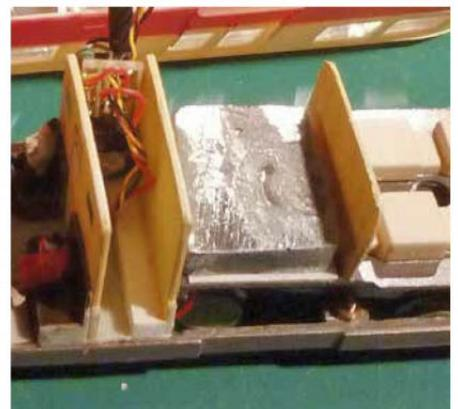
**35** Notre petite interface électronique est en place, le lest aussi (également collé à l'adhésif double face).
