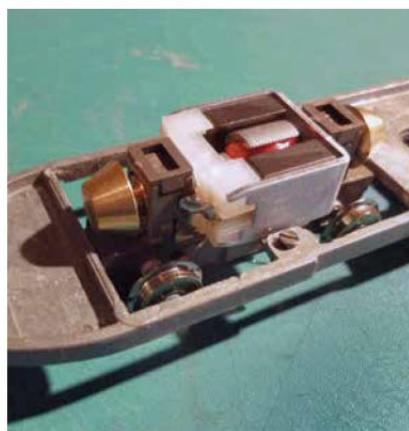
**4** Essai de fixation du moteur : le pivot se trouve en dessous des pattes de fixations... Le bogie moteur relève légèrement le châssis (de 0,5 mm). Pour compenser, il suffit d'intercaler une rondelle de 0,5 mm d'épaisseur entre l'autre bogie (porteur) et le châssis.
