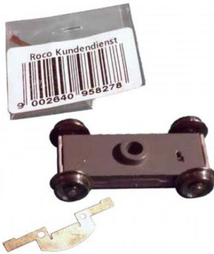
**6** Installation de prises de courant sur le bogie porteur : des lamelles d'origine Roco équipant les RGP réf. 95827 (des lamelles CDF-Informatique ou Limousin Modélisme conviendront également).
