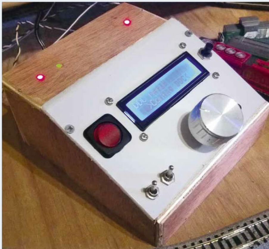
3 La communauté explique même comment construire simplement une centrale DCC !
