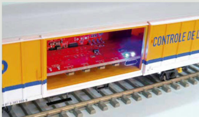
Derrière la porte, du côté opposé à l'écran, quelques touches de commandes et la connexion vers le PC.
