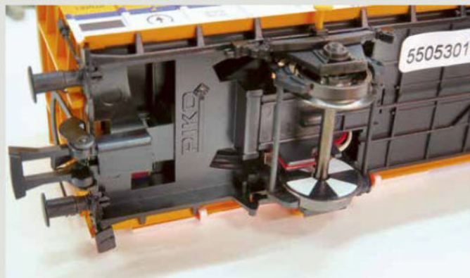
À l'arrière d'une roue, les repères peints associés à une cellule assurent la mesure.
