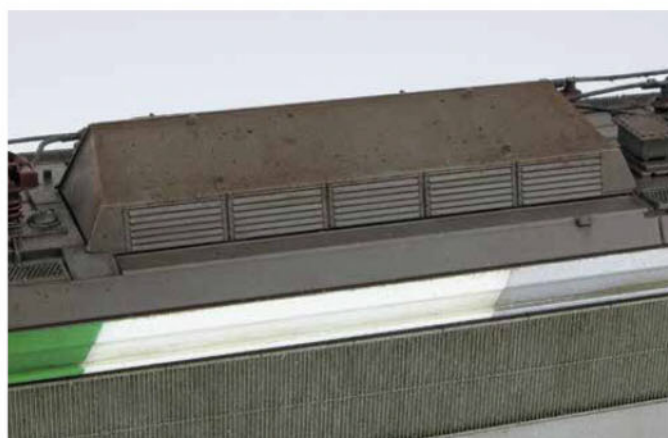
16 Les coulures et les plans de caisse sont repris au white-spirit pour bien mêler les effets.
