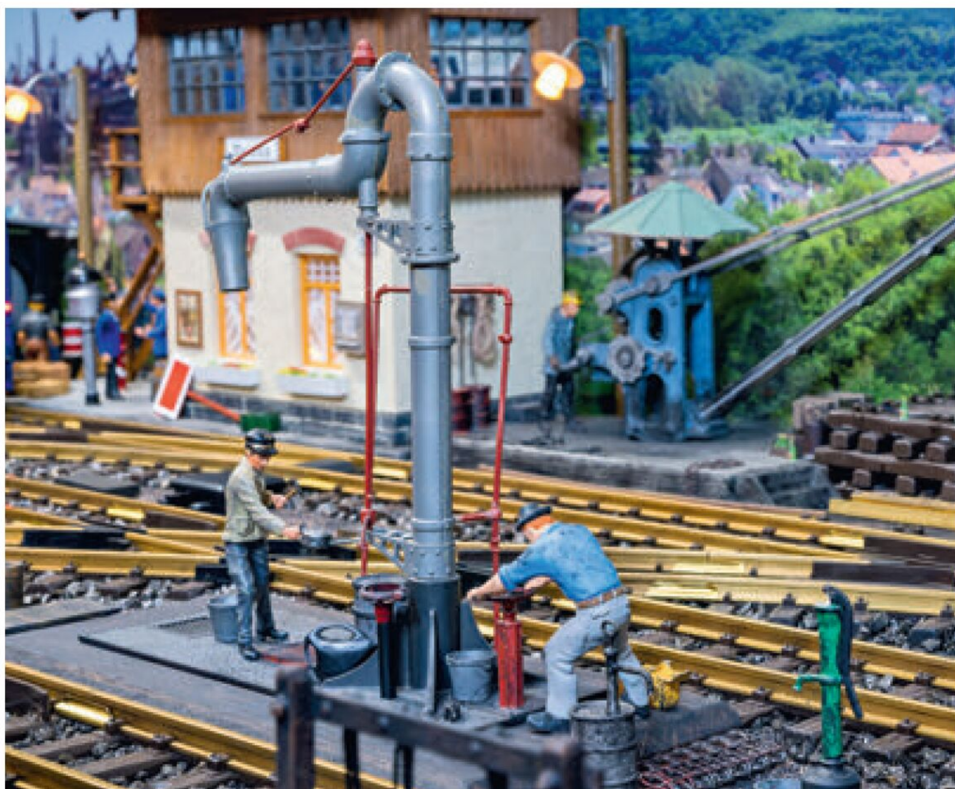
Wasserkran: Um Dampfloks mit den notwendigen großen Mengen Wasser zu befüllen, sind Rohre mit großem Durchmesser unerlässlich.
