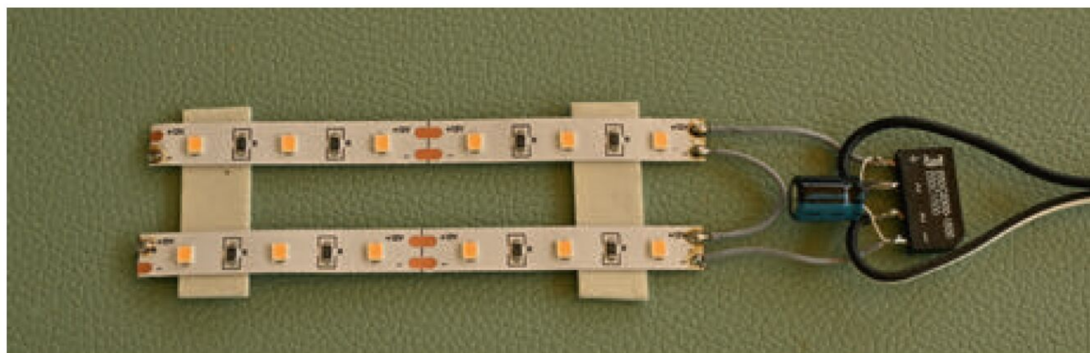
Musteraufbau: Zwei LED-Streifen sind in Reihe geschaltet und werden mittels Gleichrichter und einem kleinen Kondensator an die übliche 18-Volt-Wechselspannung angeschlossen.
