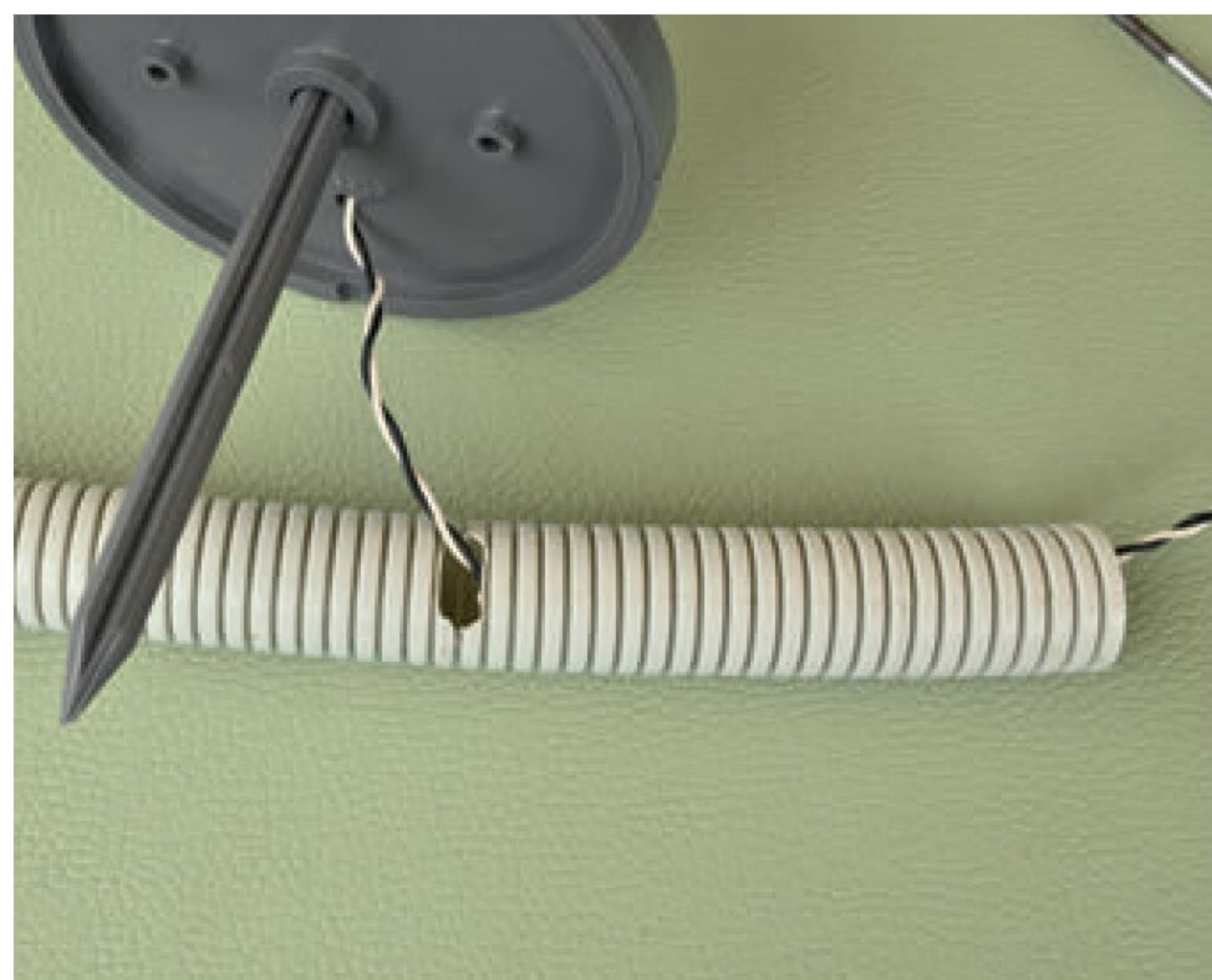
Bahnhofslaterne II: Ist das Kabel angelötet, verschließen wir den Sockel. Die Doppellitze führen wir dann einfach ins Leerrohr ein.
