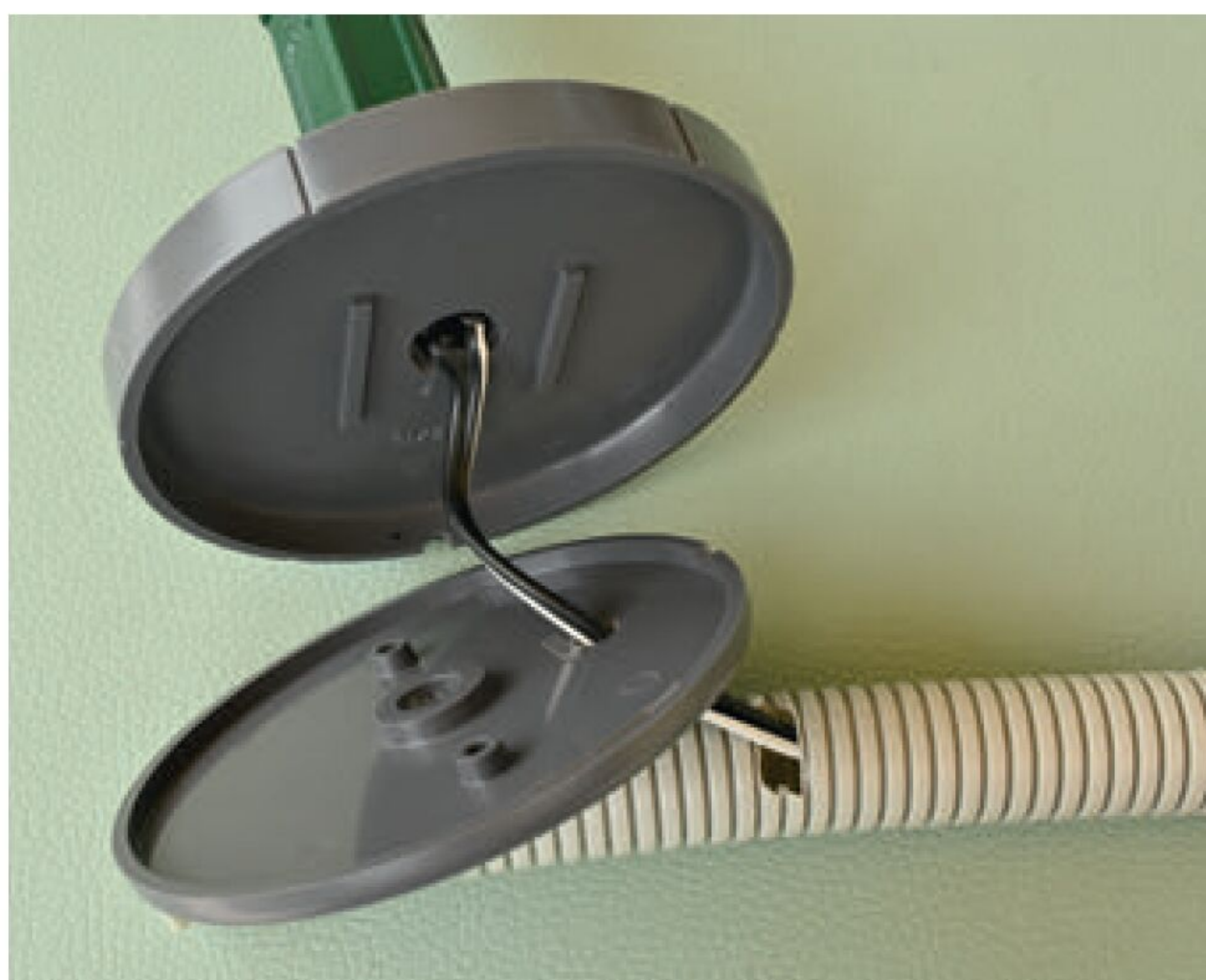
Bahnhofslaterne I: Hier kann die Doppellitze direkt im Sockel angelötet und so beliebig lang zum Verteiler geführt werden.
