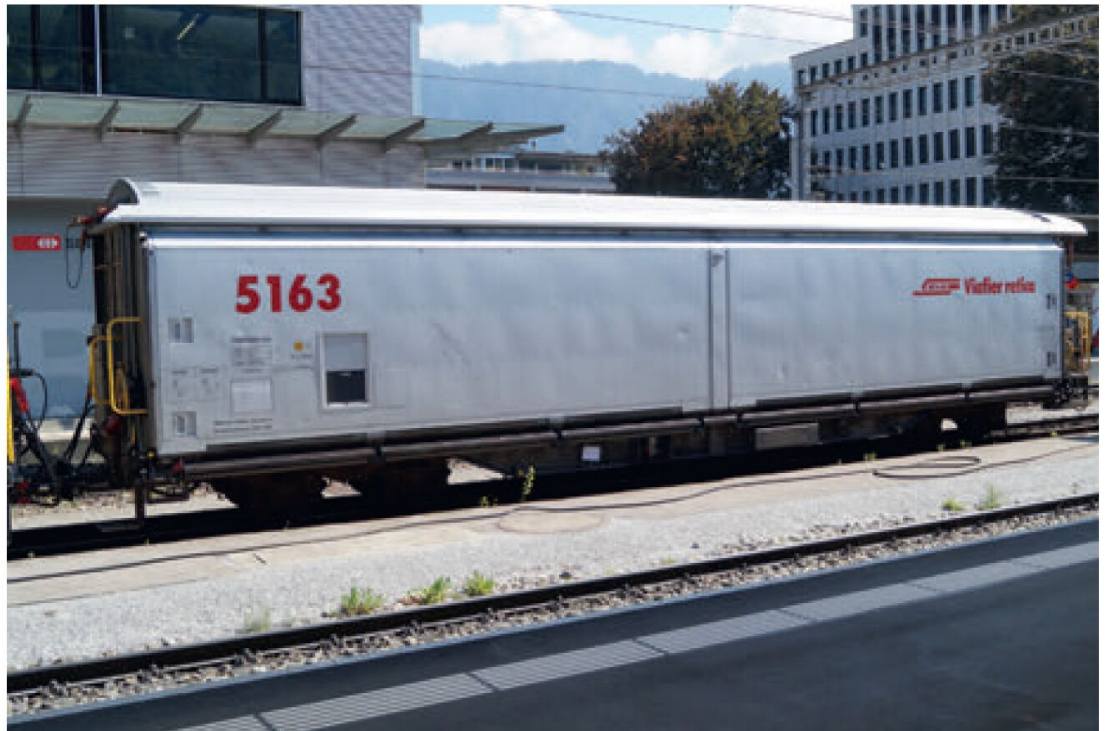
Schiebewandwagen Typ Haik: Vierachsig und gedeckt – sie sind die Klassiker im Gütertransport. Im Bild eine Ausführung mit Kühlaggregat (exakte Bezeichnung Haikqq-uv).
