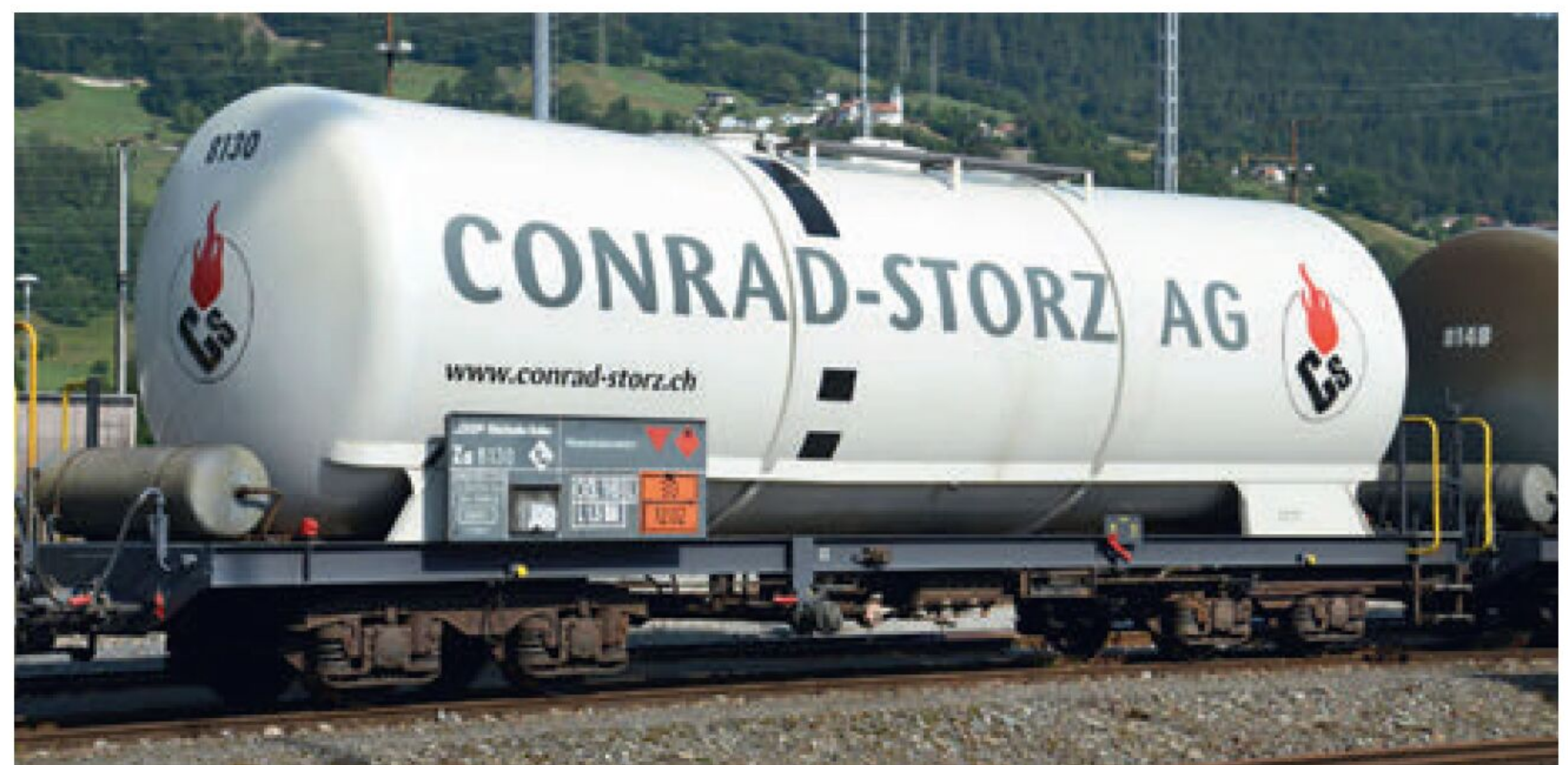
Kesselwagen Bauart Za: Bis zu 52.000 Liter Mineralöl fasst dieser Wagentyp. Damit sind Mineralölprodukte ökologisch sinnvoll, schnell und günstig unterwegs.
