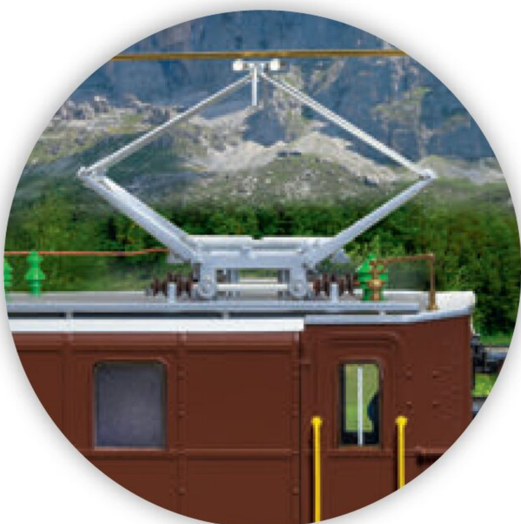
Vorbildgerecht: Seit 1946 befindet sich nur mehr ein Stromabnehmer auf dem Dach. Um Platz für den Bremswiderstand zu schaffen, wurde der zweite entfernt.
