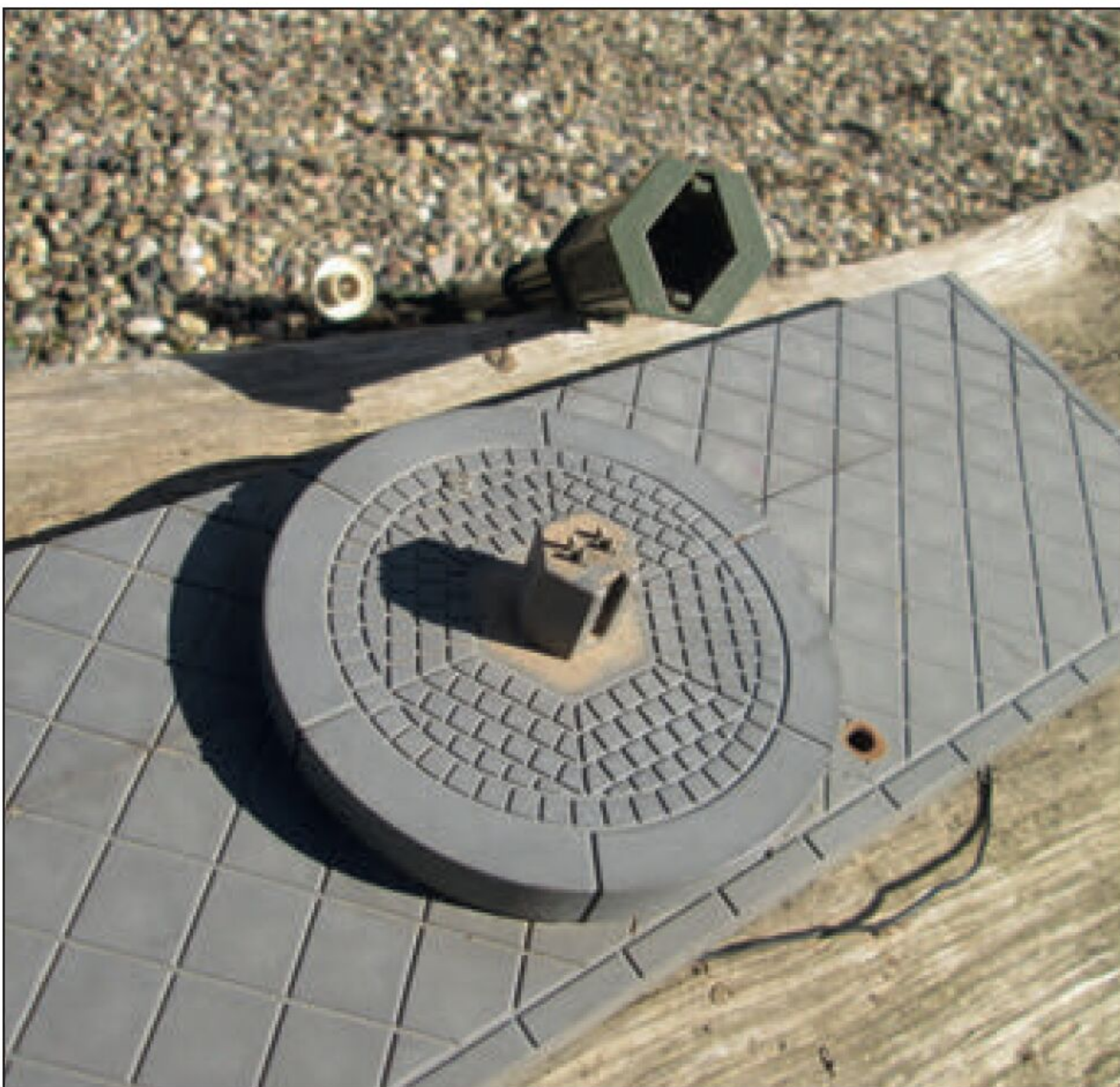
Detailarbeit I: Kontakte überprüfen, Schmutz entfernen – auch der Stecksockel der Bahnsteiglampe braucht Pflege.
