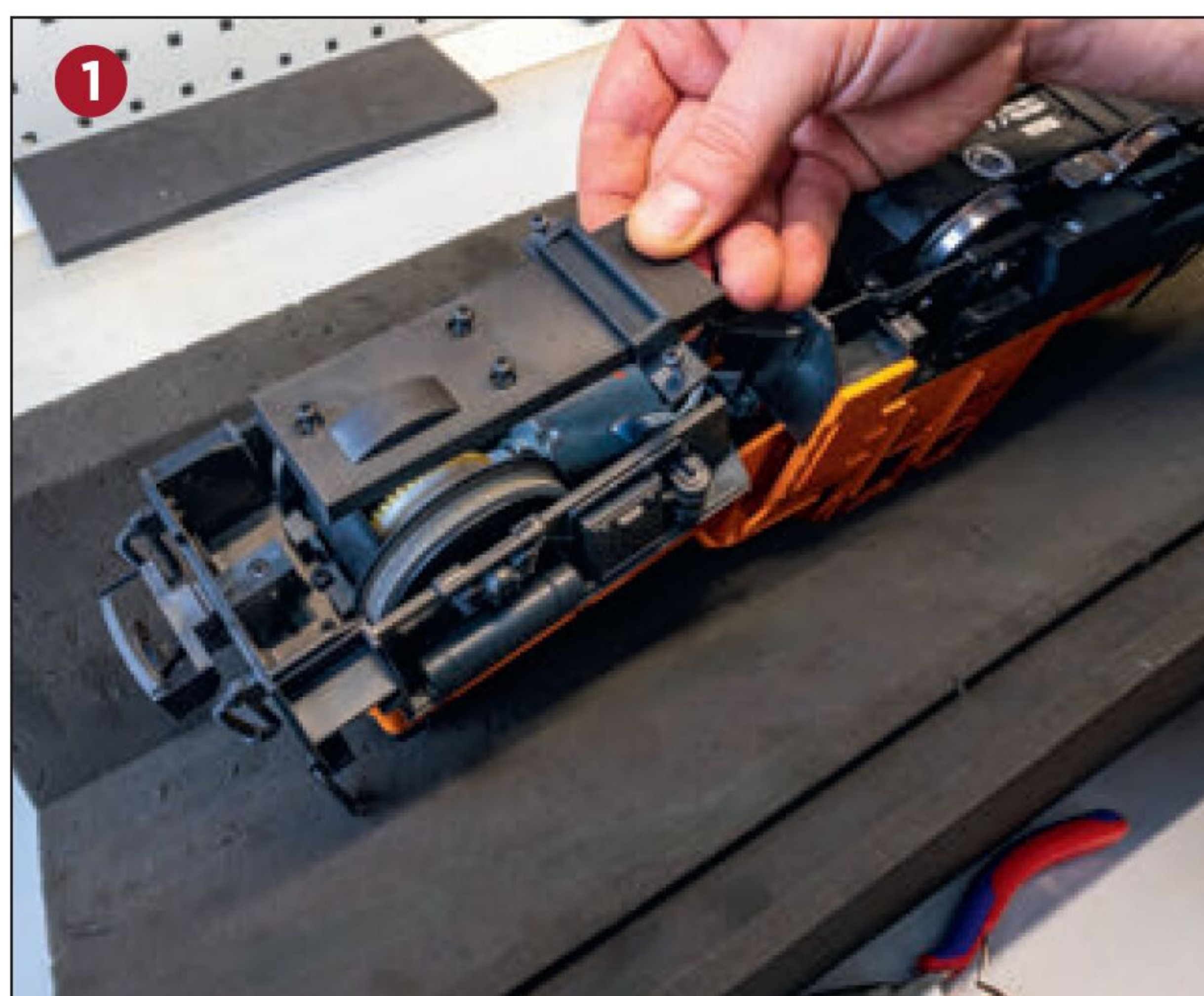
Schritt 1: Als Erstes sind die beiden Schrauben an der Fahrgestellhalterung zu lösen. Halterung abnehmen.
