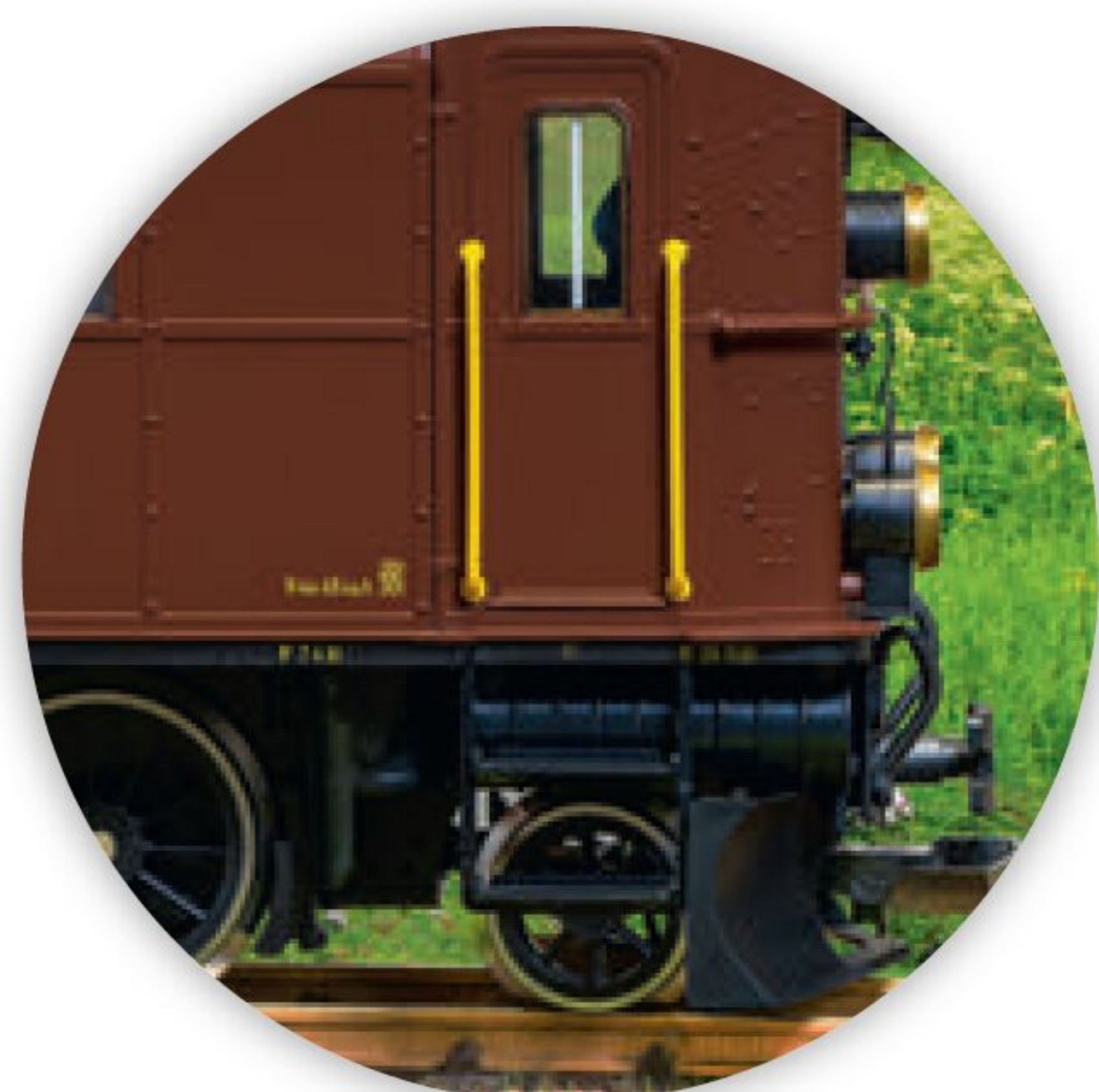
Aufwendig: Angesetzte Griffstangen, Schneeräumer, vorbildgerechte Lampenfassungen sind nur einige Details, die das Modell auszeichnen.
