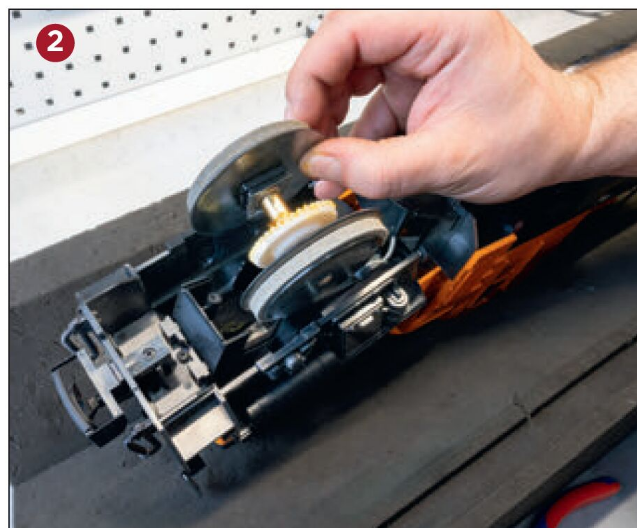
Schritt 2: Den hinteren Teil des Reinigungsmotors leicht anheben und die Reinigungsräder entnehmen.
