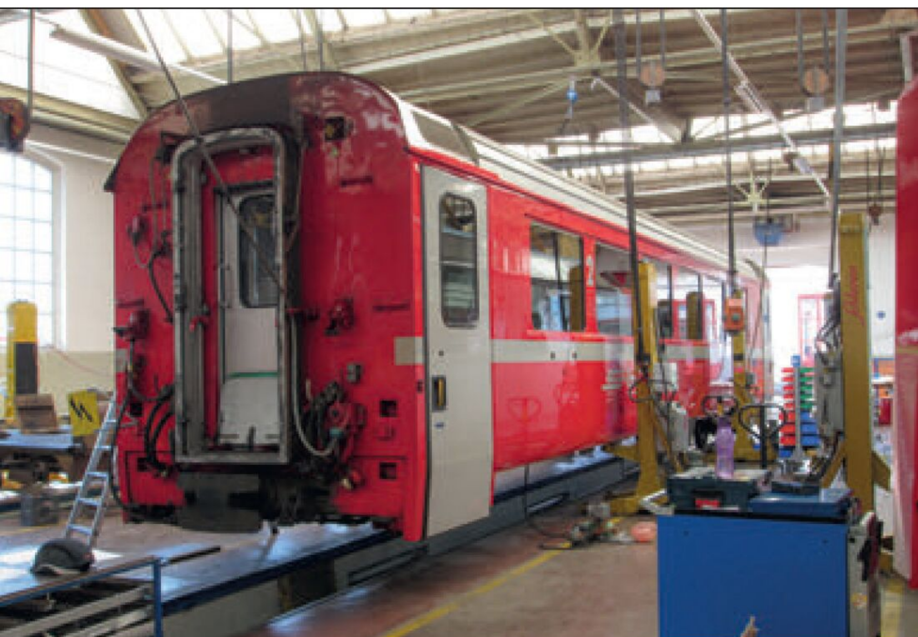
Wertarbeit: Von den Drehgestellen bis zu einzelnen Sitzgruppen – auch Personenwagen müssen regelmäßig zur Inspektion.
