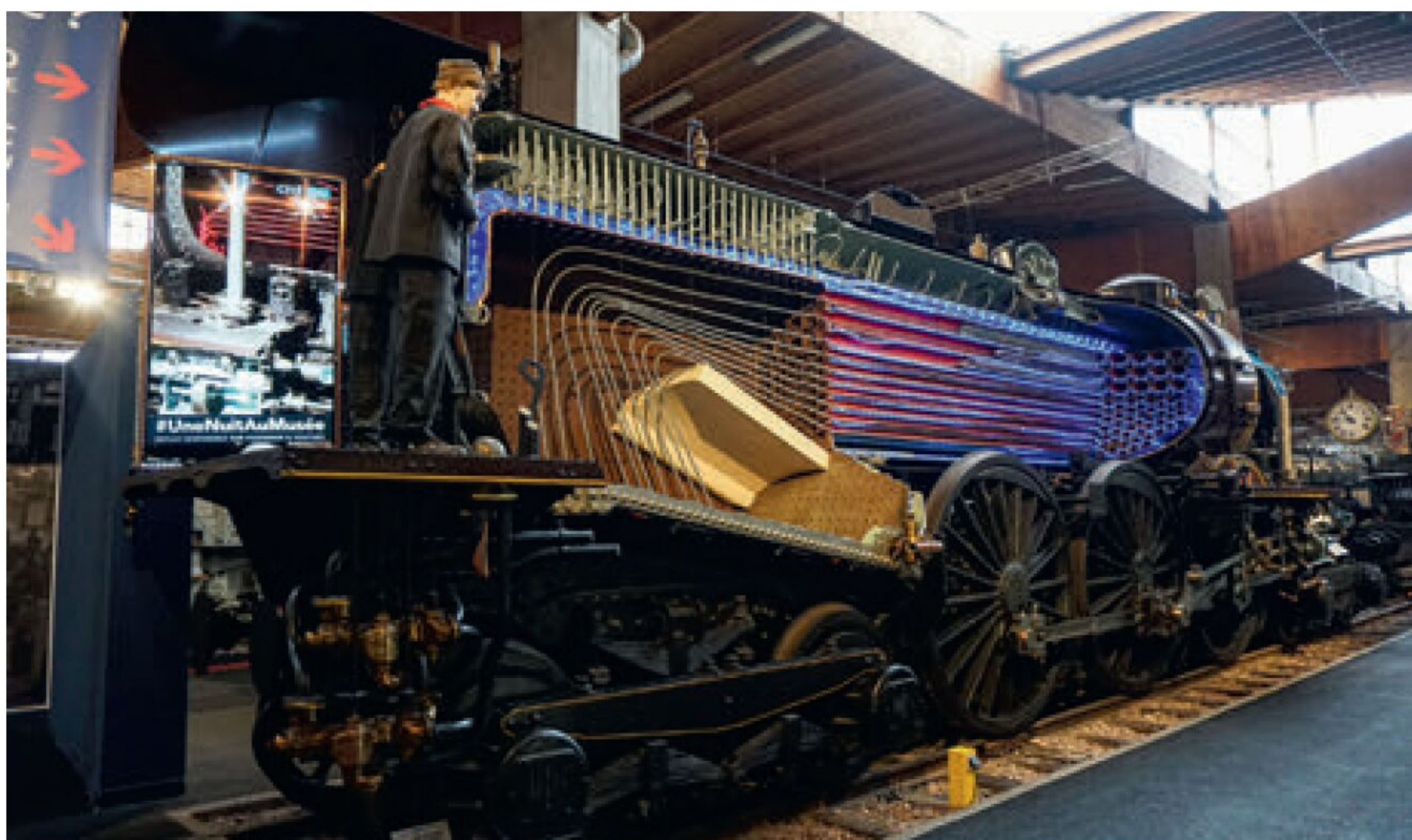
Anschaulich: In der halbierten Schnellzug-Dampflok lässt sich der Weg von Wasser und Dampf anhand farbiger Lichterketten verfolgen. Die Heizerfigur steht vor der Feuerbüchse.
