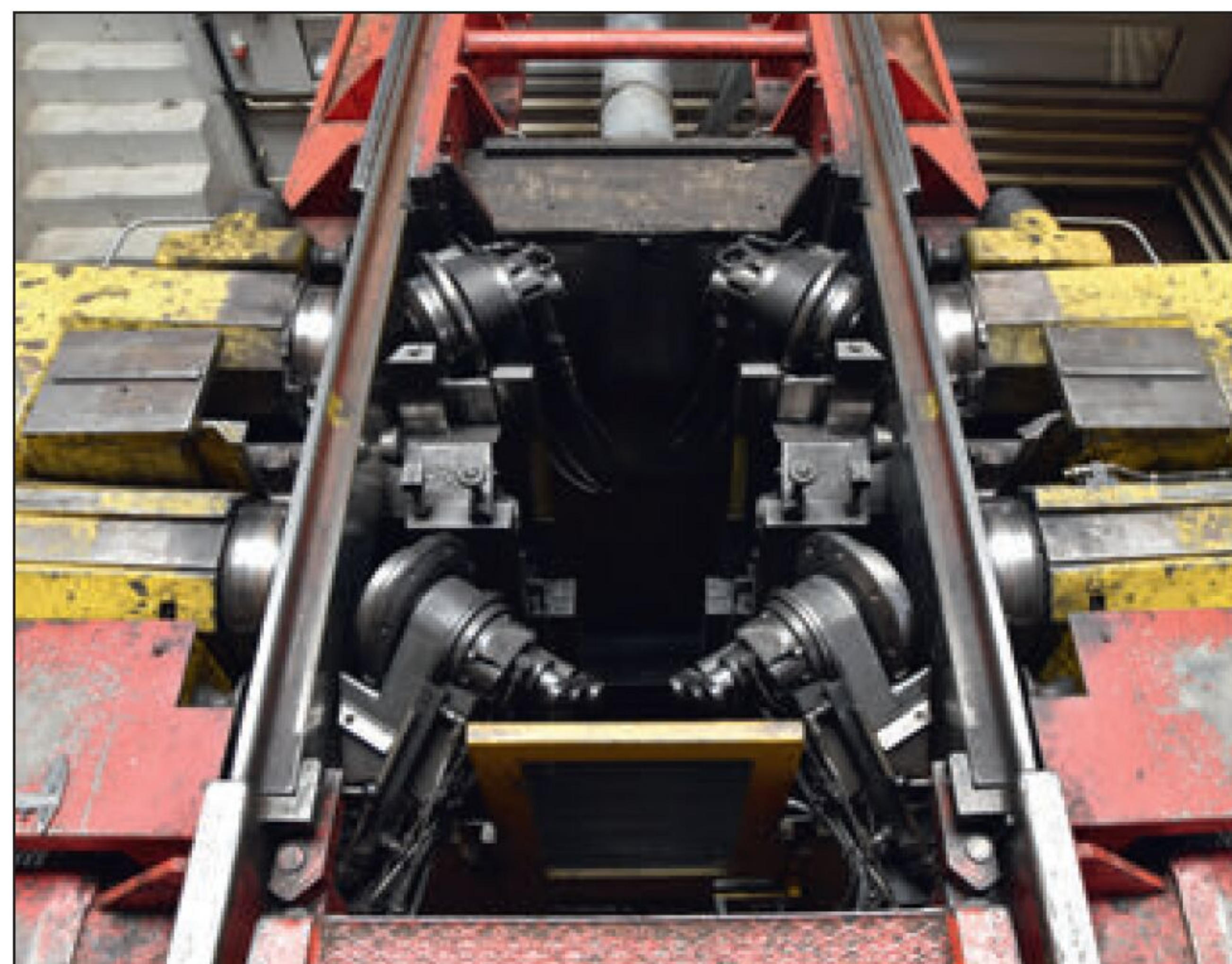
Hilfreich: Die Unterflur-Radsatzdrehmaschine ermöglicht eine automatisierte und exakte Bearbeitung der Laufflächen.
