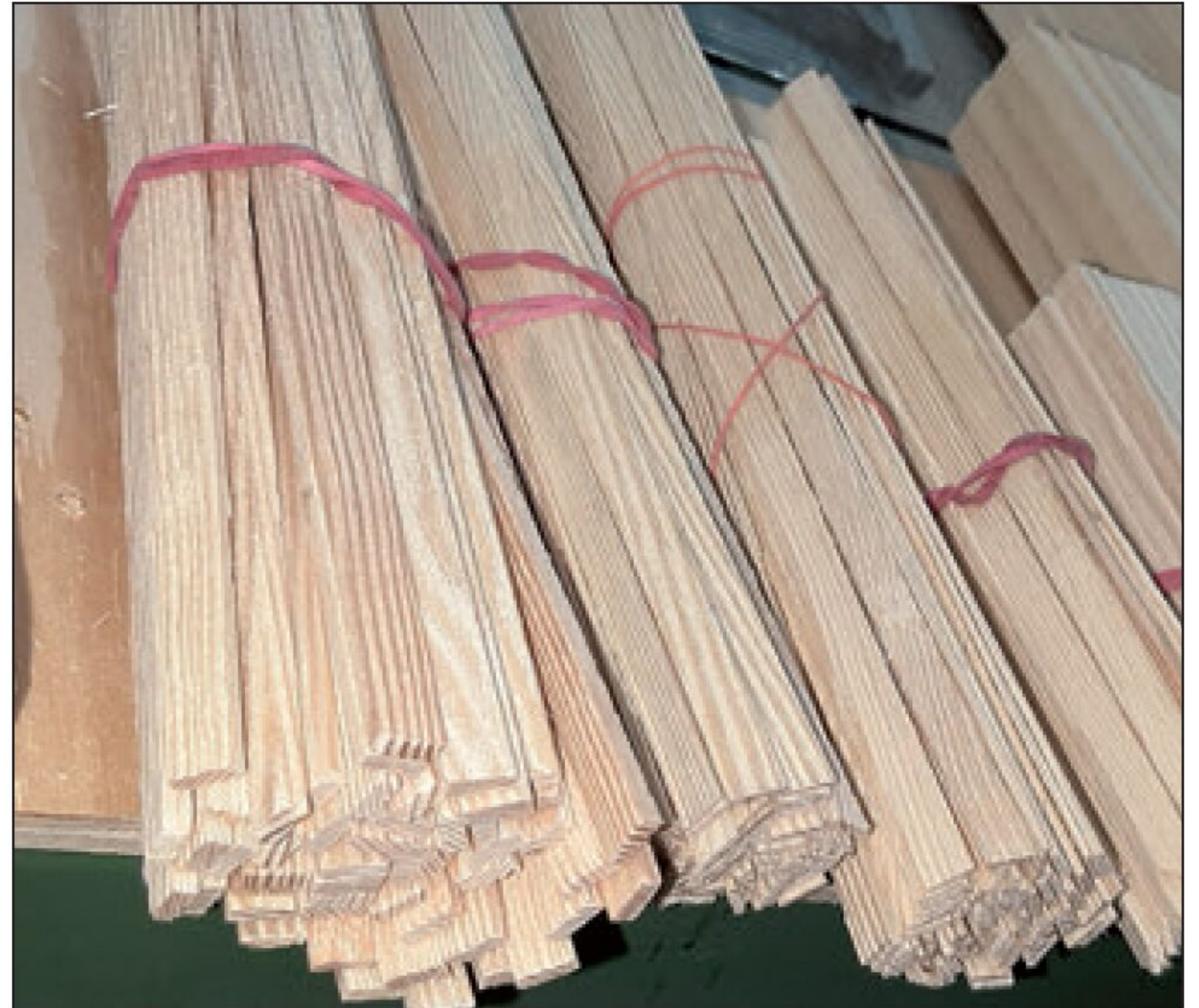
Vorarbeit: Aus etwa zwei Meter langen Holzleisten werden nach Plan die Teilstücke zugeschnitten – insgesamt etwa 5.000!
