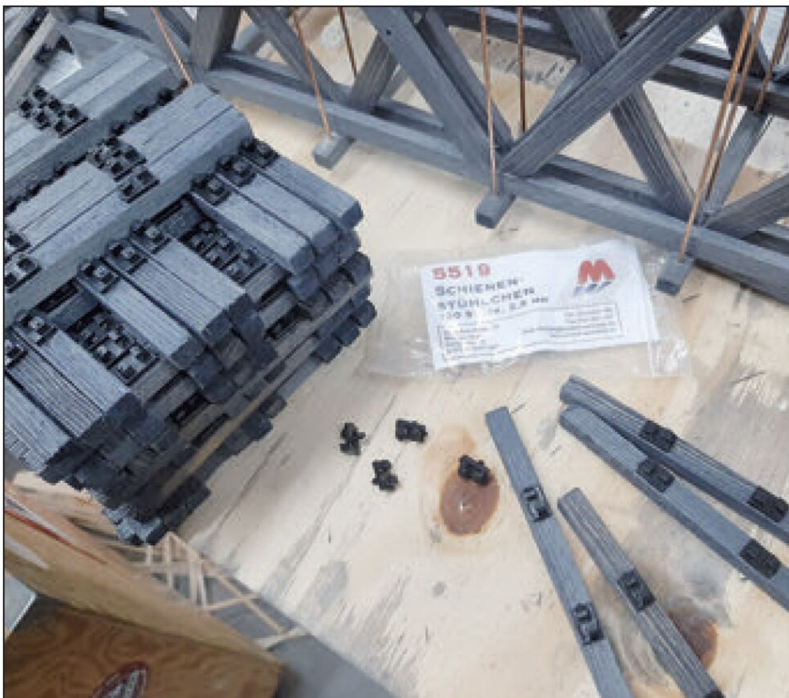
Feinarbeit: Jede Schwelle erhält zwei Schienenstühlchen (von Heyn), die die Schienen halten. Der Streckenaufbau kann beginnen.
