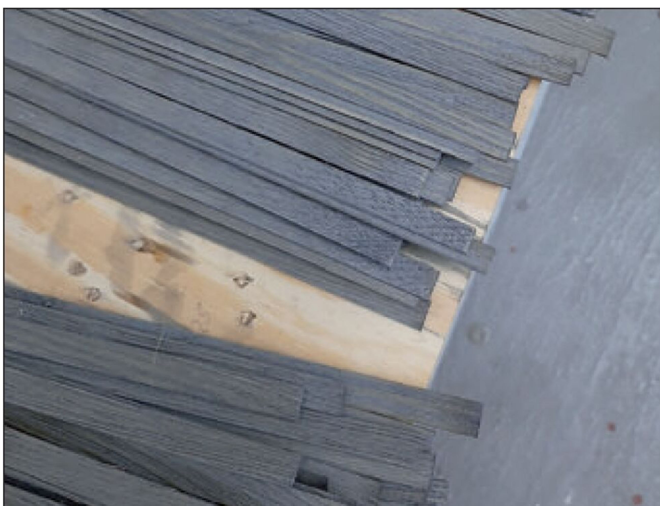
Vorbildgerecht gealtert: Die Hölzer werden in graue Beize getaucht. Dazu wird Pulverbeize in heißem Wasser gelöst.
