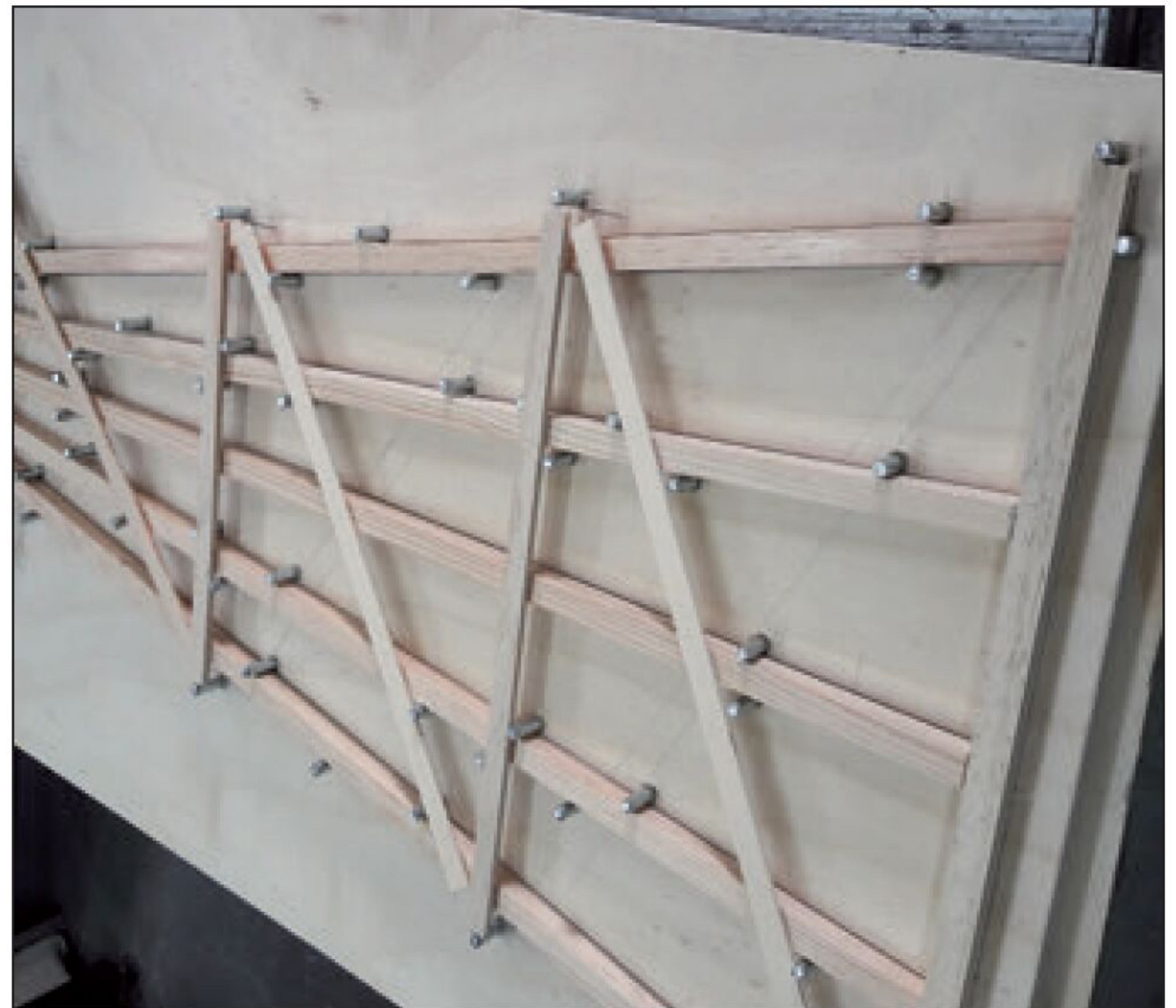
Hilfreich: Um die insgesamt 26 Säulen zu fertigen, lohnt die Anfertigung einer Schablone. Damit sind alle Säulen auch maßhaltig.
