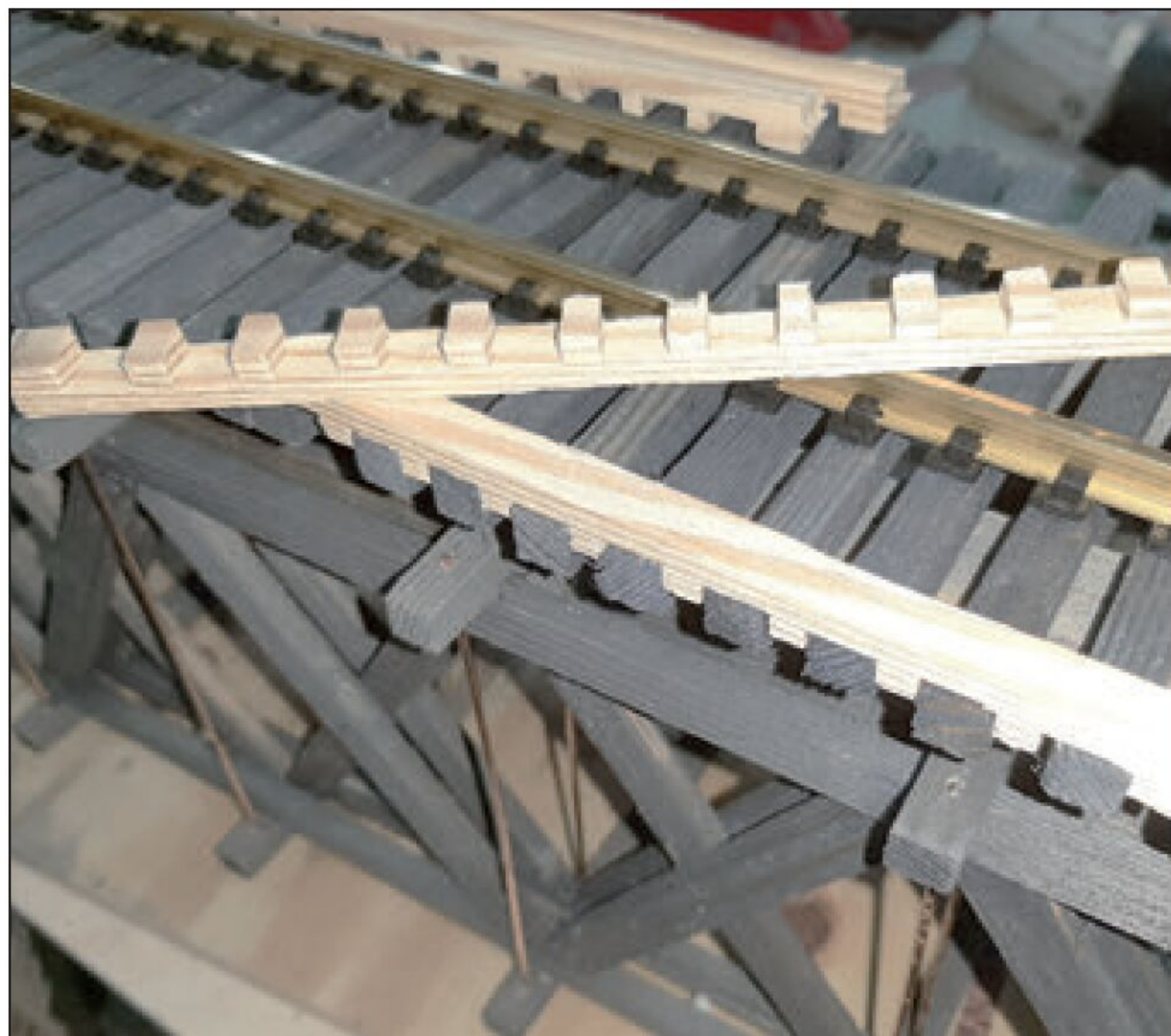
Distanz: Damit die Schwellen den exakten Abstand halten, wurden wie beim Bau der Brücken sogenannte „gard timber“ hergestellt.
