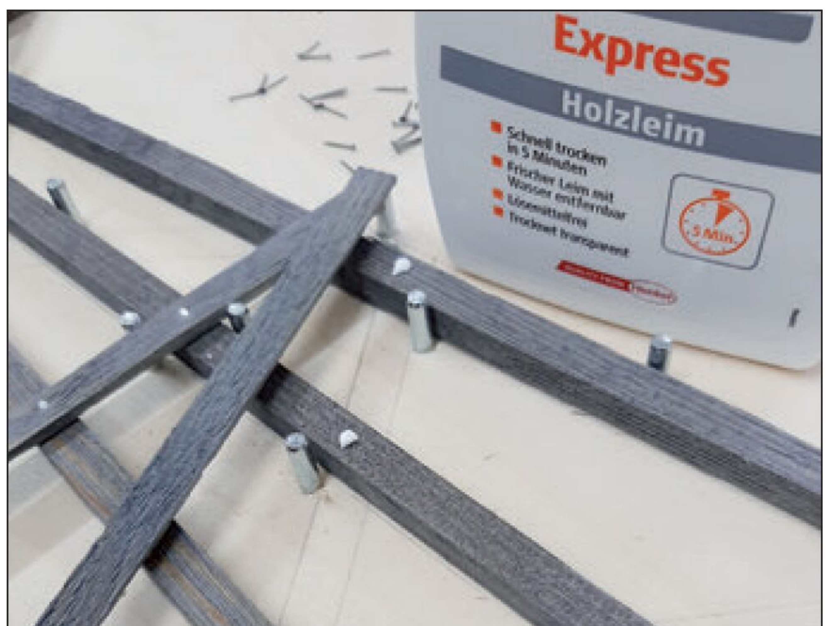
Fließbandarbeit: Dank der Schablone werden die einzelnen Hölzer eingepasst und per Leim miteinander verbunden.
