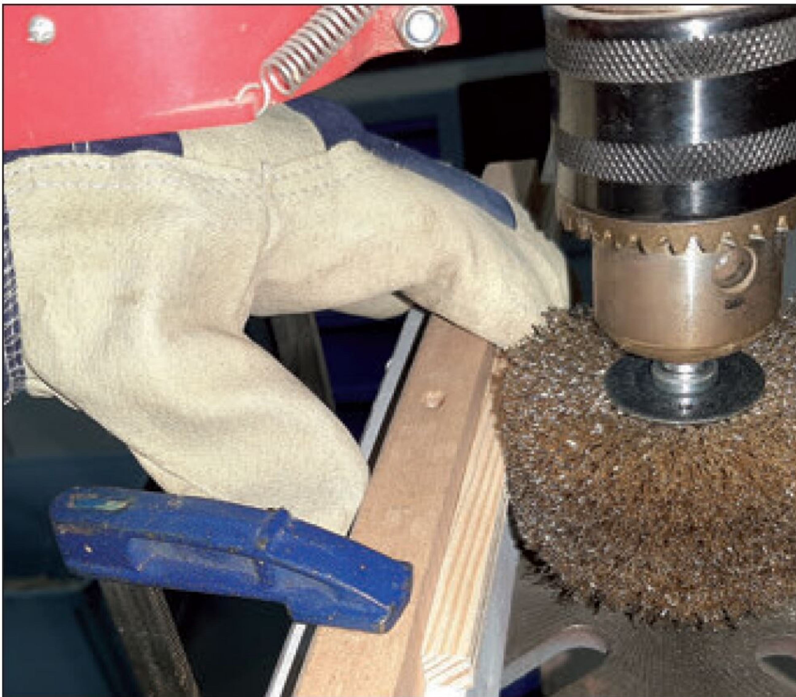
Schritt zwei: Das Holz erhält eine verwitterte Struktur, indem es – mittels Maschine – mit einer Drahtbürste bearbeitet wird.
