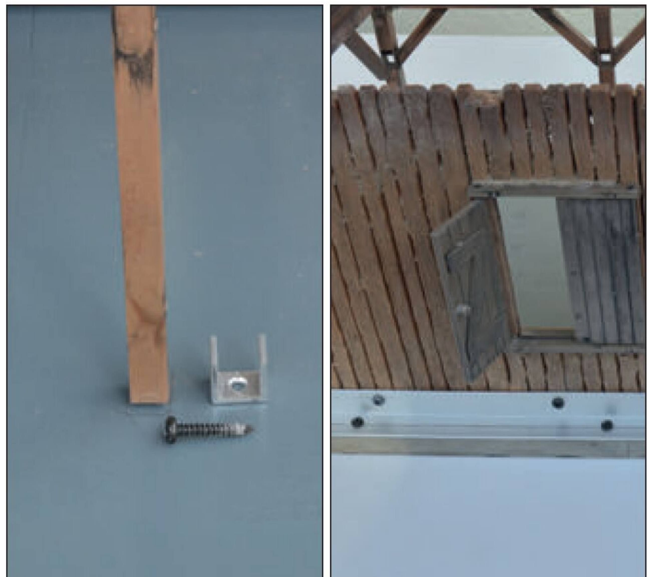
Vorbereitung: Einfache Alubleche im U- und L-Profil (in jedem Baumarkt erhältlich) sorgen für eine neue Stabilität.
