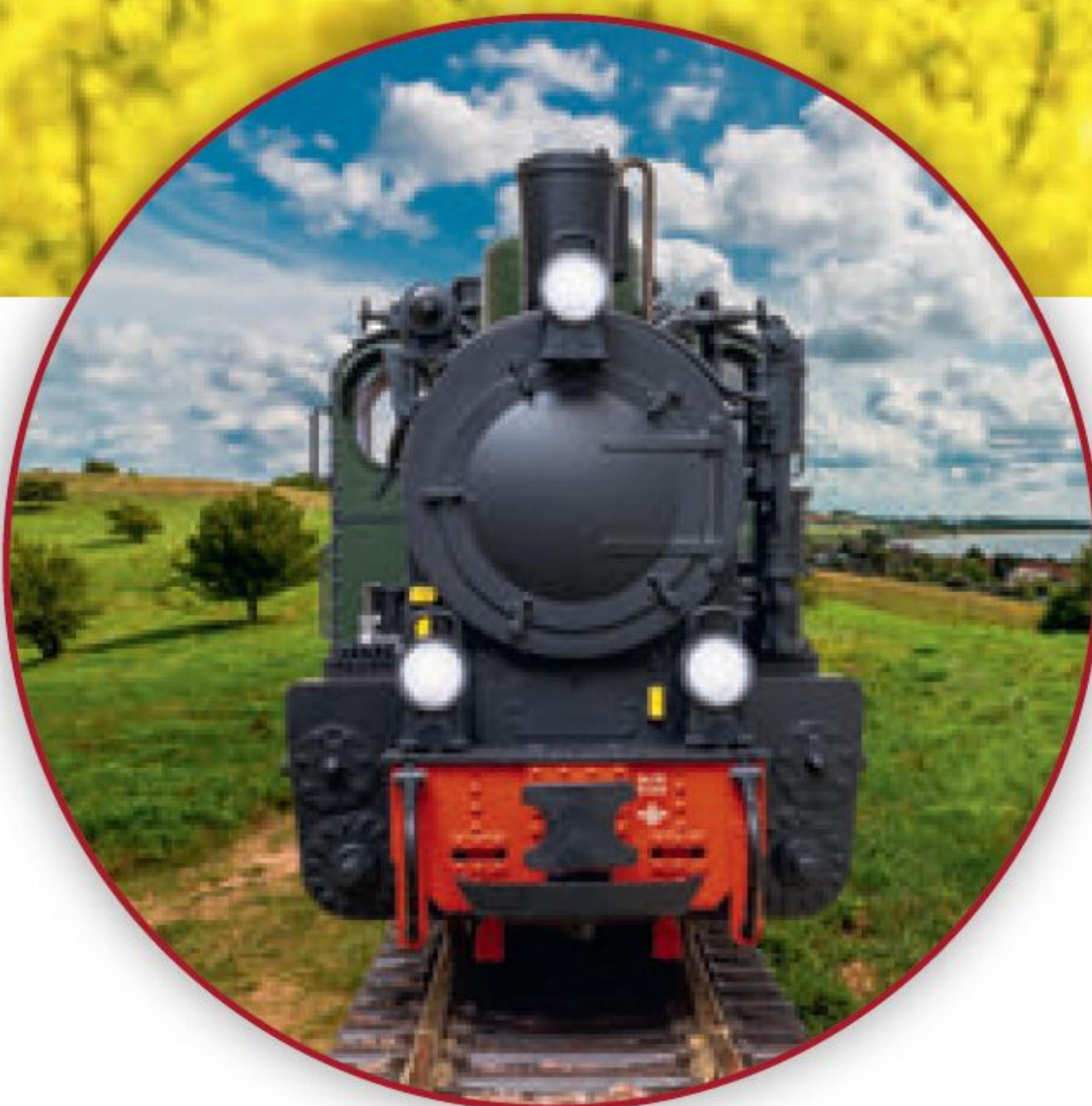
Eleganter Auftritt: Die Wasserkästen sind beim Bautyp Lenz M im Rahmen integriert.
