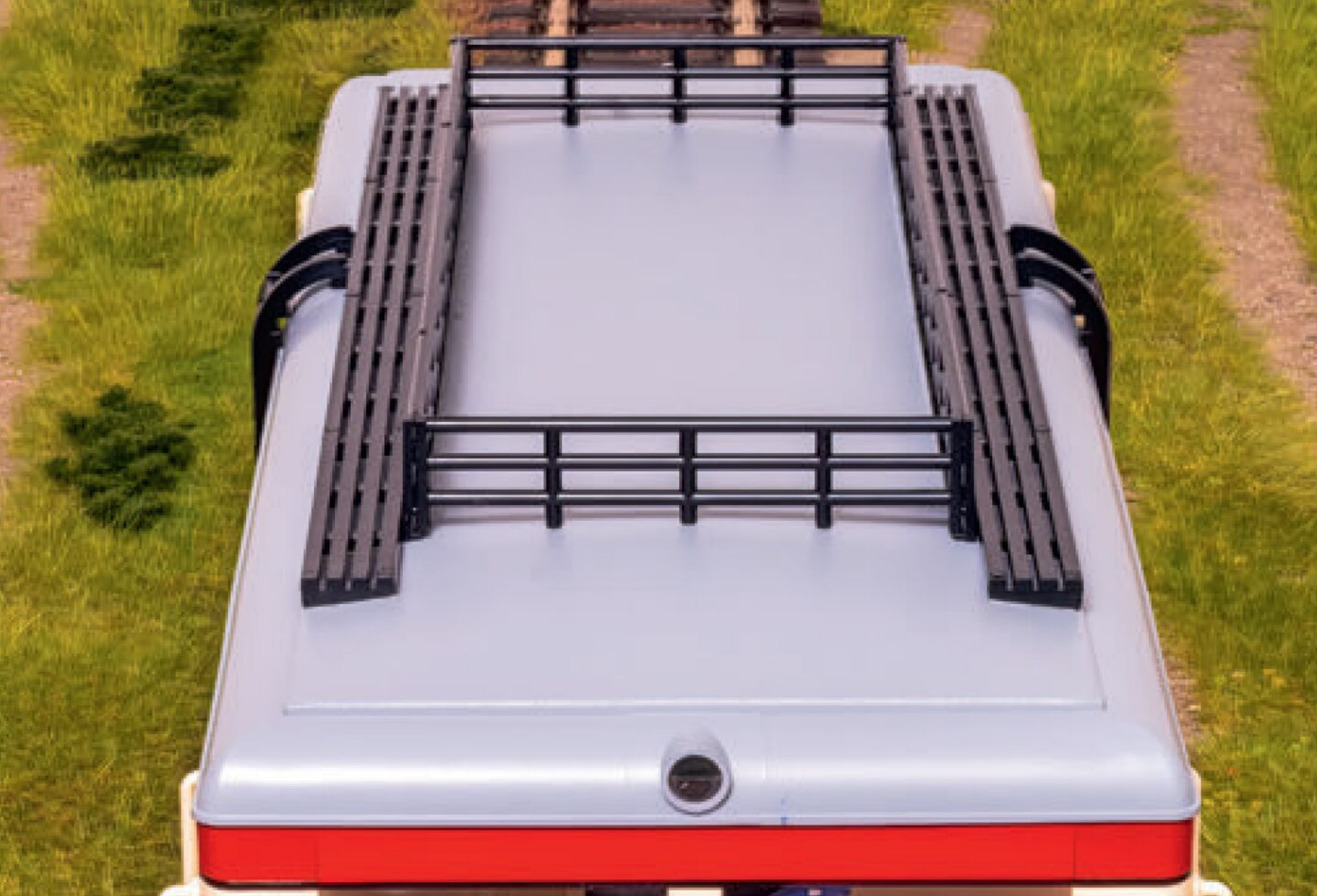
Kundengerecht: Der Gepäckträger auf dem Dach sorgte für ausreichend Ladefläche und war für das Angebot auf Nebenbahnen geradezu obligatorisch.
