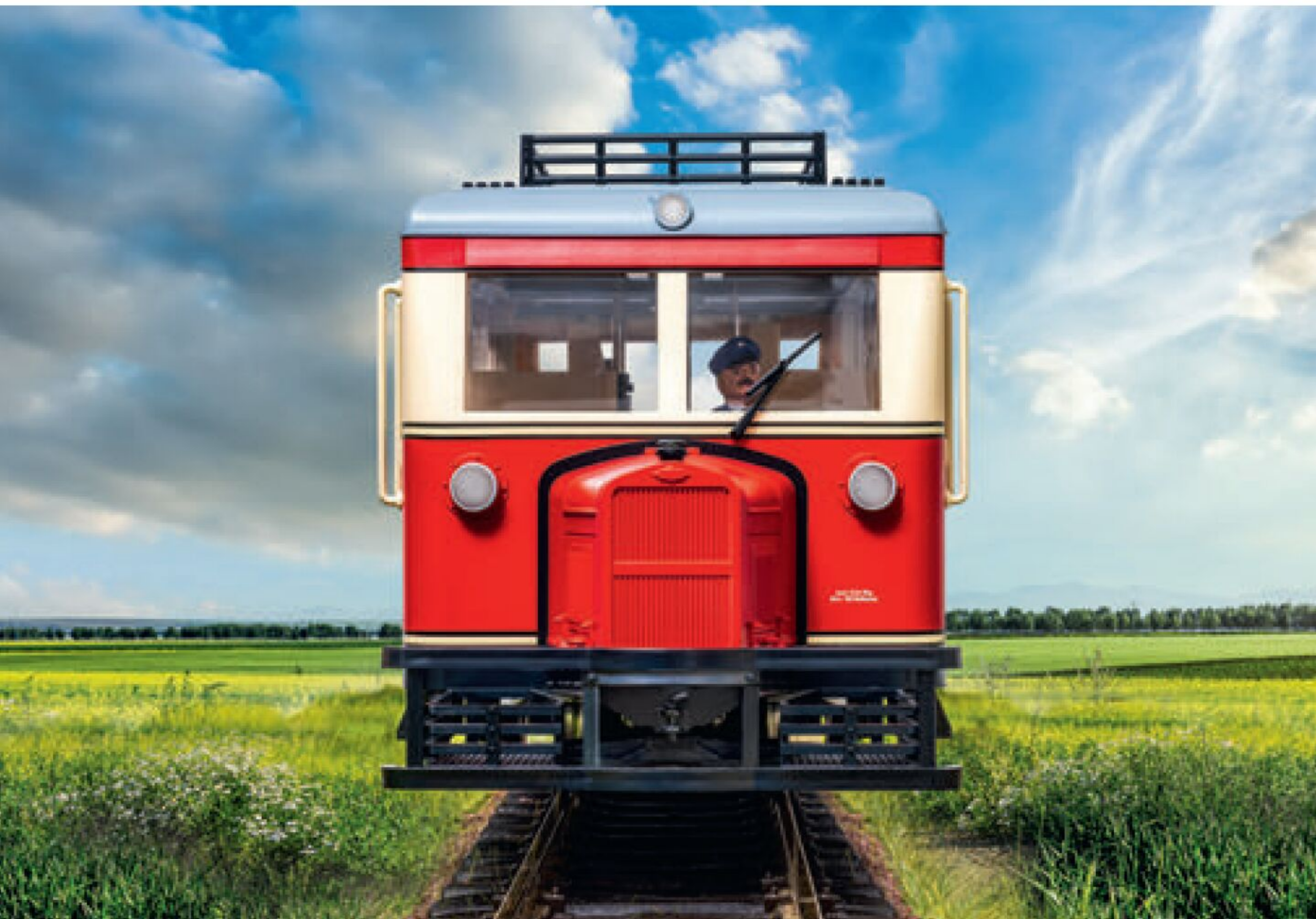
Unverwechselbare Front: Der Motorkasten – je einer an beiden Stirnseiten – gab dem Triebwagen die markante Form und sorgte für den Spitznamen „Schweineschnäuzchen“.
