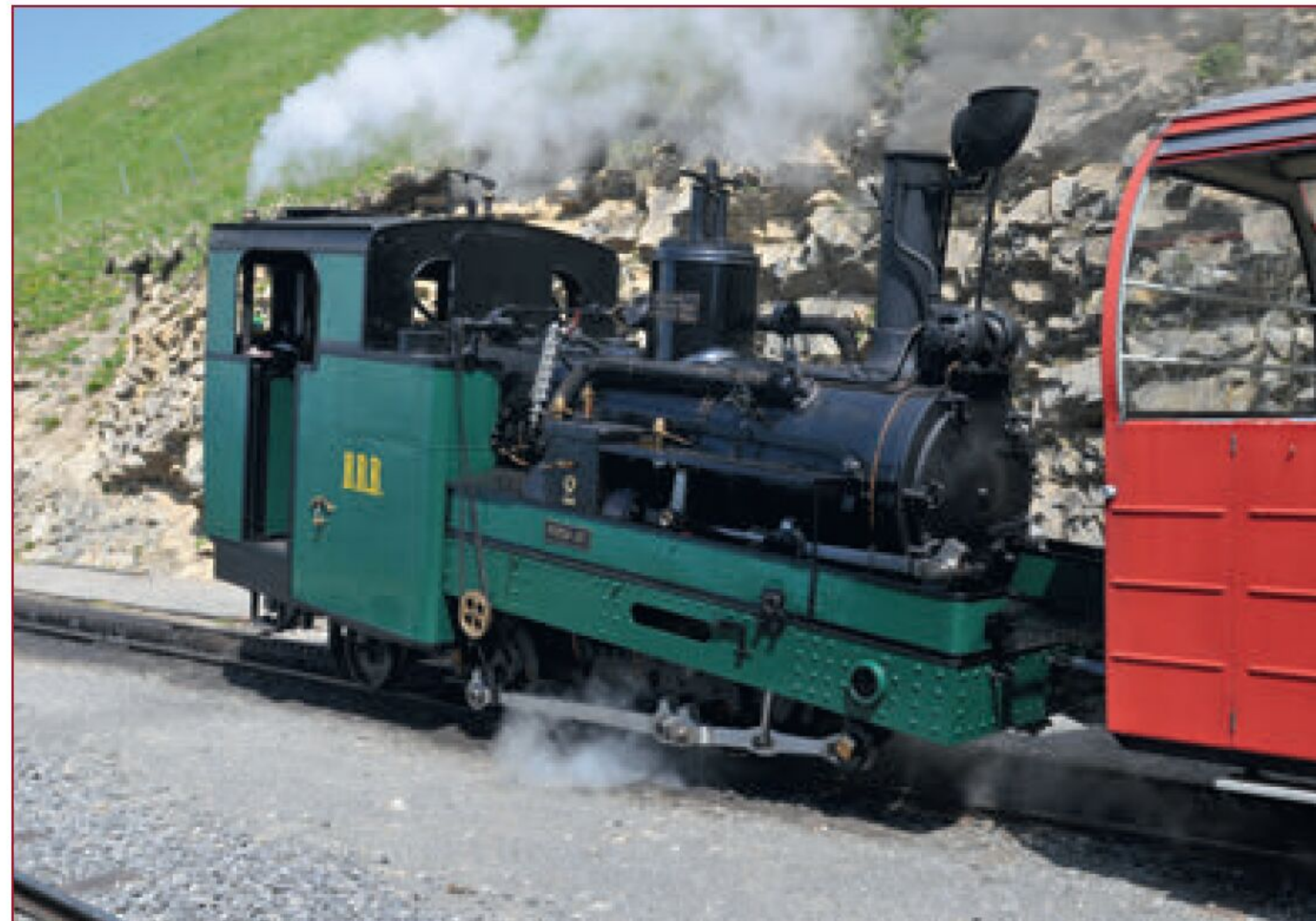
Historisch: Die H 2/3 mit der Betriebsnummer 2 wurde 1891 in Dienst gestellt und ist eine von zwei Loks mit Kohlefeuerung.
