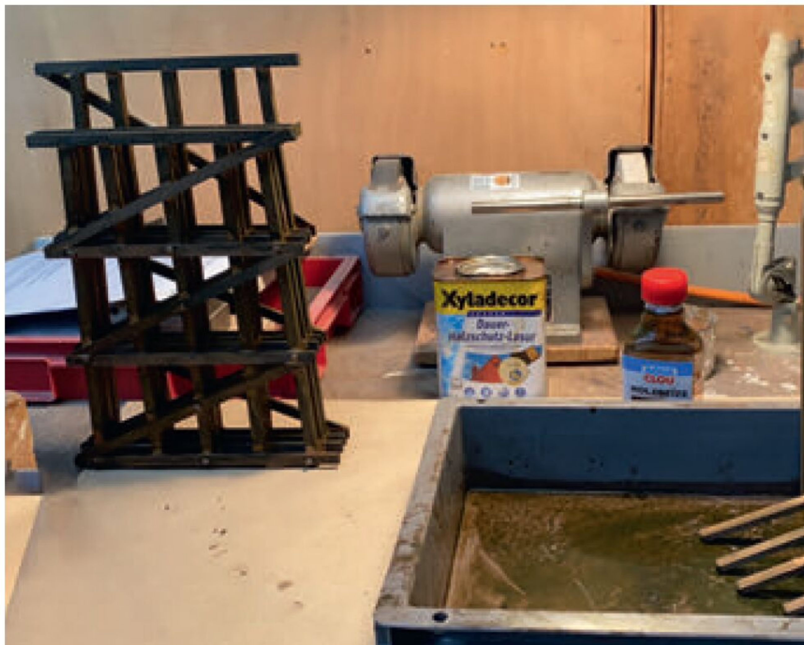
Grundierung: Die zugeschnittenen Stäbe wurden insgesamt viermal eingelassen, damit sie auch langfristig wetterfest sind.
