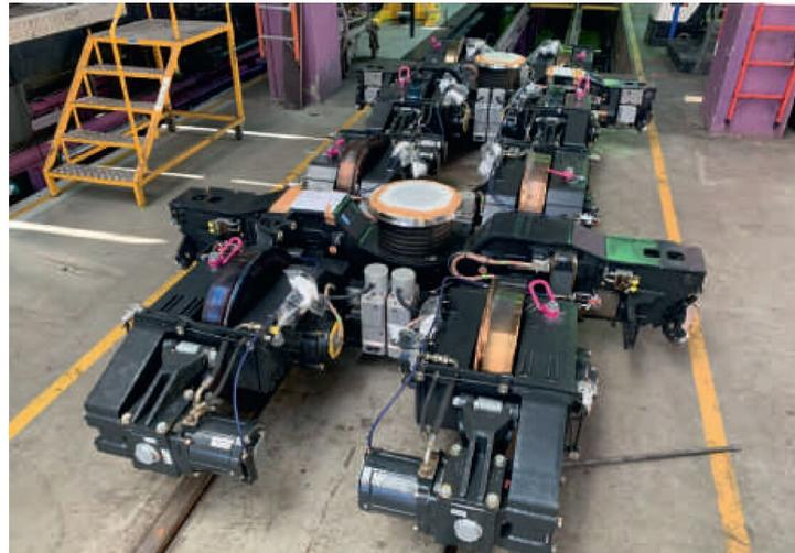
**Hightech:** Durch das variable Drehgestell unter den Wagen kann die Spurweite von 1.000 auf 1.435 Millimeter verbreitert werden.
