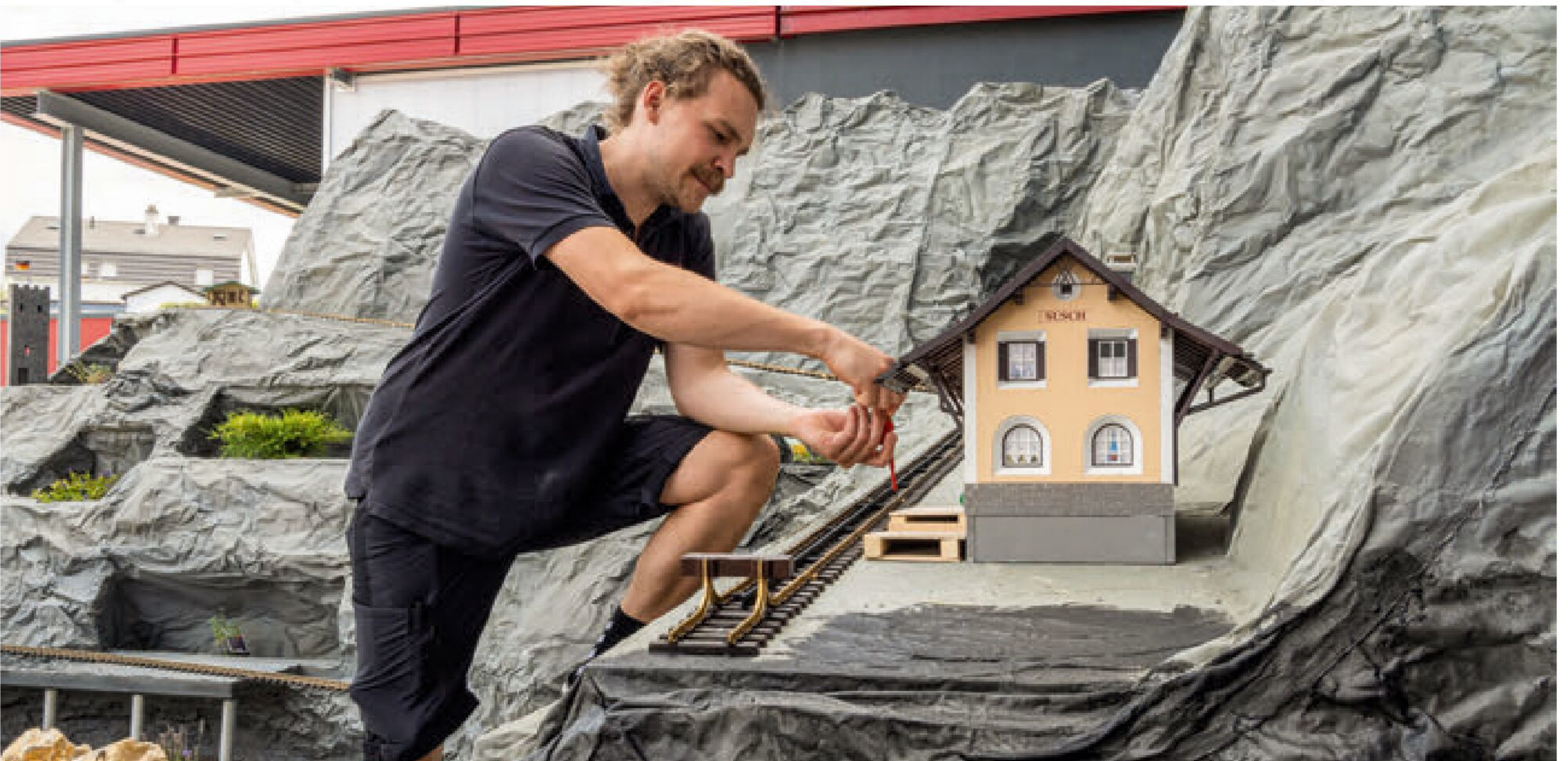
Vorbild Rigi-Bahn: Christoph Rabel montiert die Zahnstangen für die Bergbahn auf der Schauanlage. Die Steigung liegt bei 12 Prozent.
