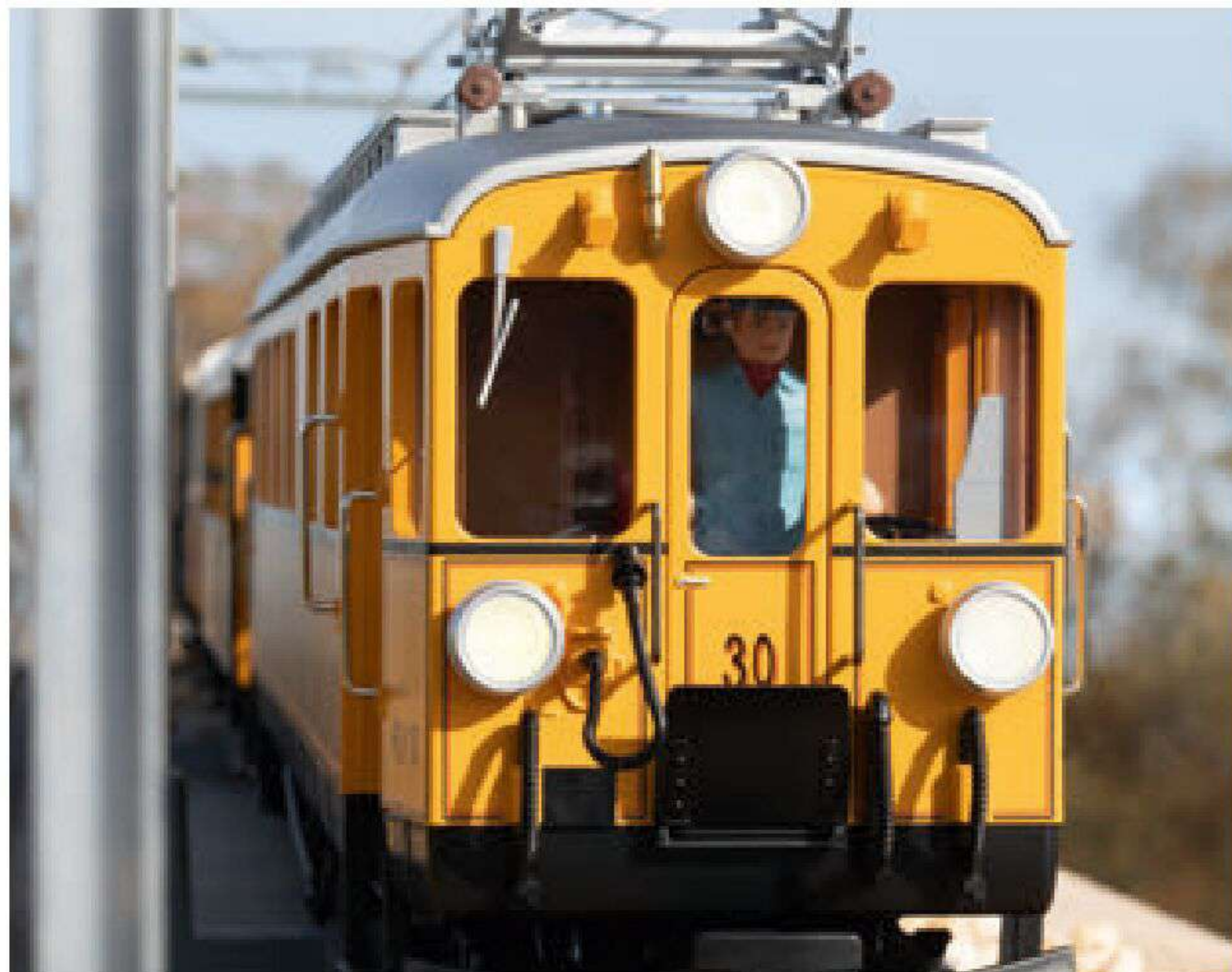
Markant: die Front des ABe 4/4 30 mit seinen großen Lampen und der Fahrertür an der Stirnseite.
