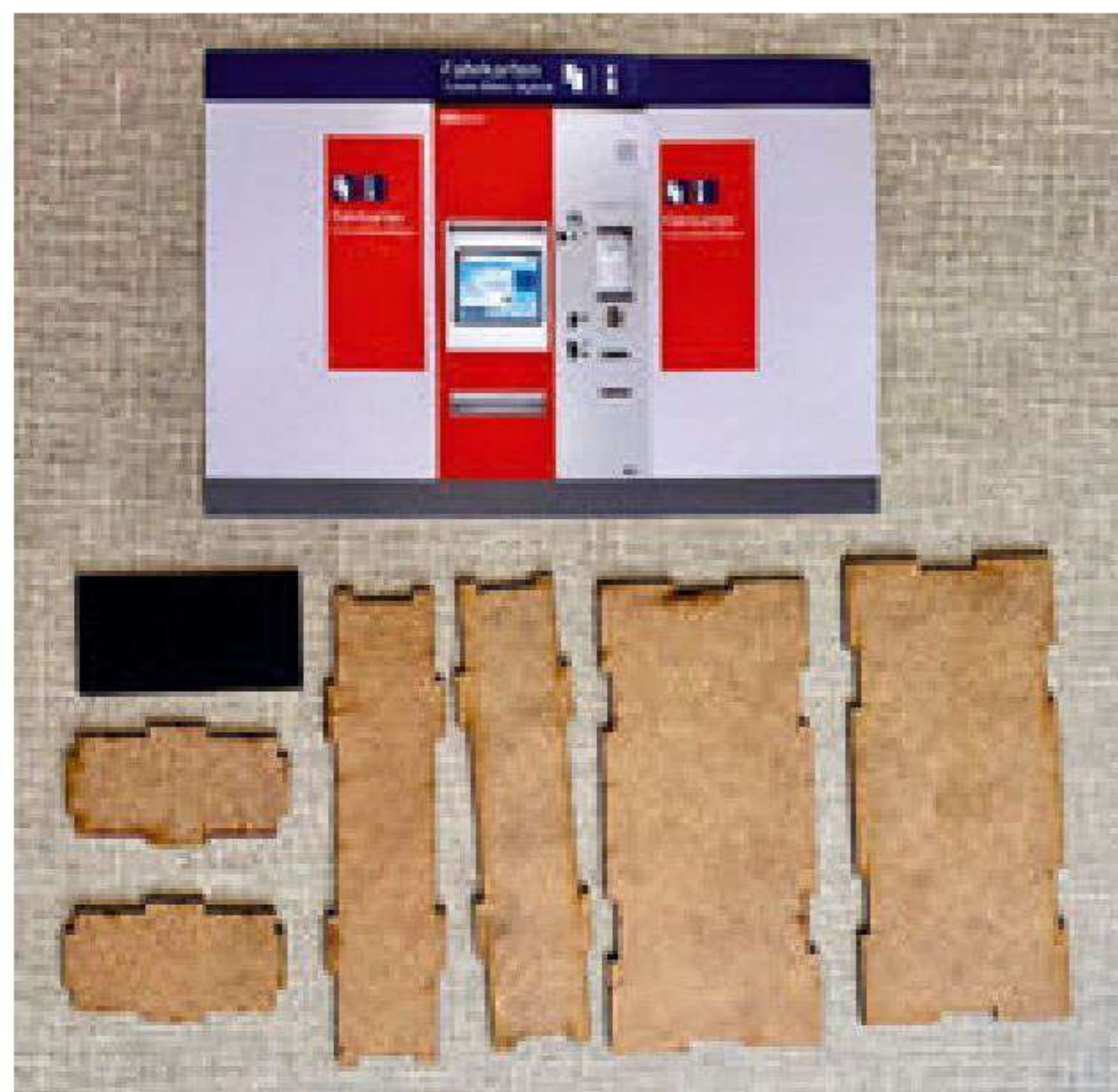
Der Bausatz für moderne DB-Fahrkartenautomaten besteht ebenfalls aus zwei Millimeter dünnen HDF-Platten.
